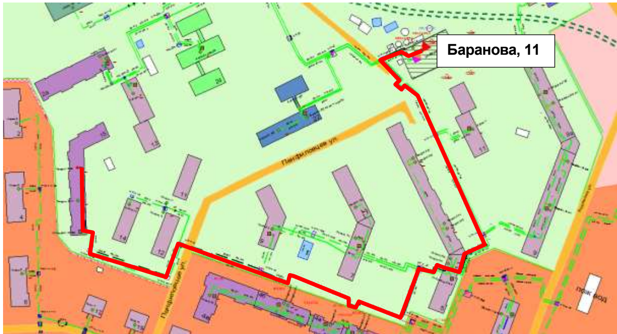
Рисунок 3.27 – Результат гидравлического расчета - расчетный путь теплоносителя от котельной Баранова, 11 до ПТ-Панфил,15 э2
