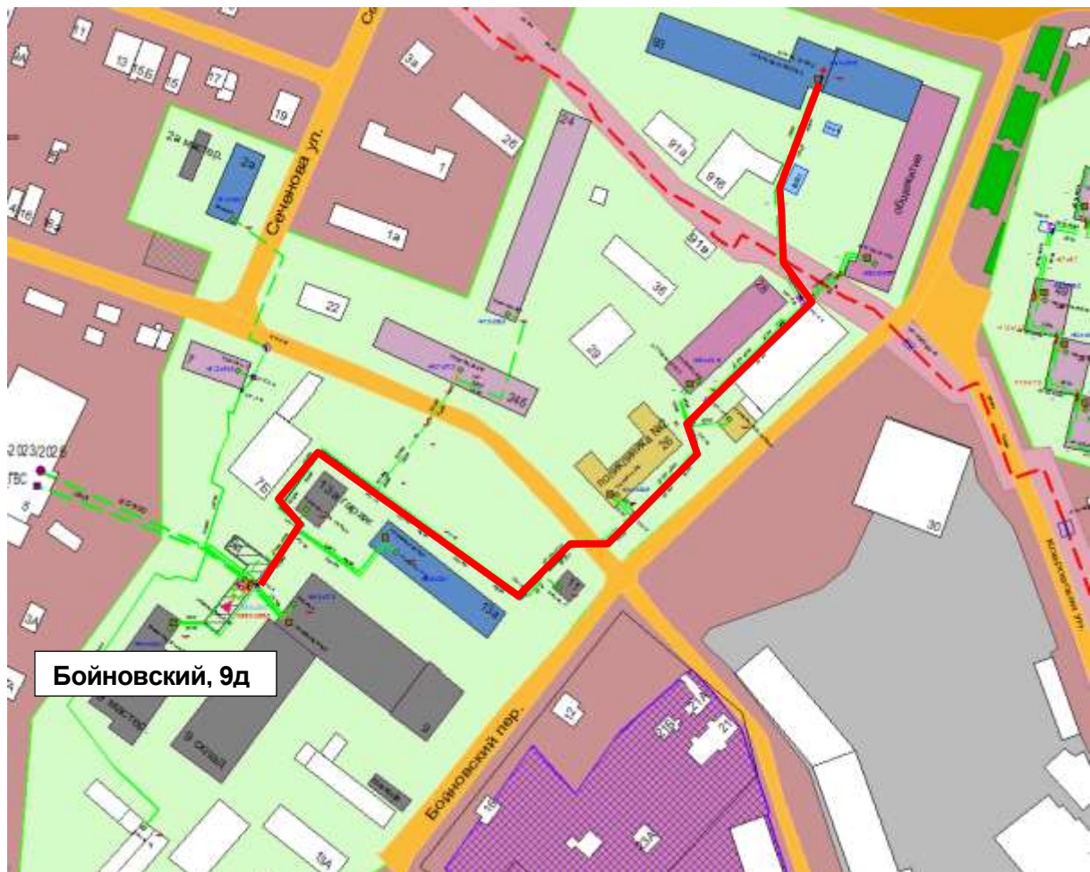
Рисунок 3.13 – Результат гидравлического расчета - расчетный путь теплоносителя от Бойновский, 9д до ПТ-Б.Печер, 93 МВт
