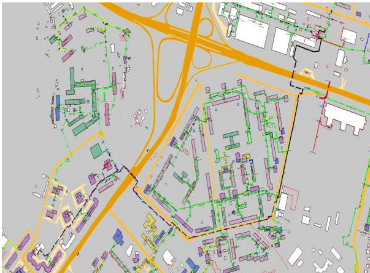
Рисунок 3.43 - Результат гидравлического расчета - расчетный путь теплоносителя от котельной пр. Гагарина, 1786 до ПТ-Гагар.пр.101/5 ИТП №2
