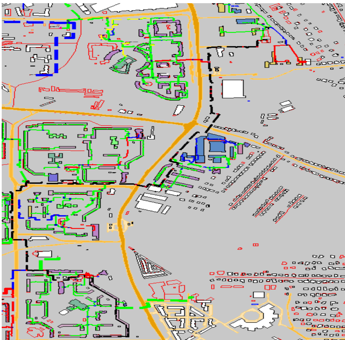
Рисунок 3.53 – Результат гидравлического расчета - расчетный путь теплоносителя от котельной ул. Родионова, 1946 до ПТ-Богдан.1 пр.
