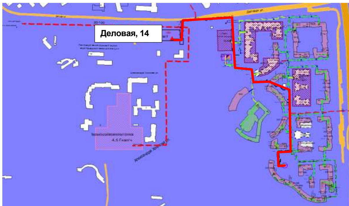
Рисунок 3.17 – Результат гидравлического расчета - расчетный путь теплоносителя от котельной Деловая, 14 до ПТ-Род.199/2_н
