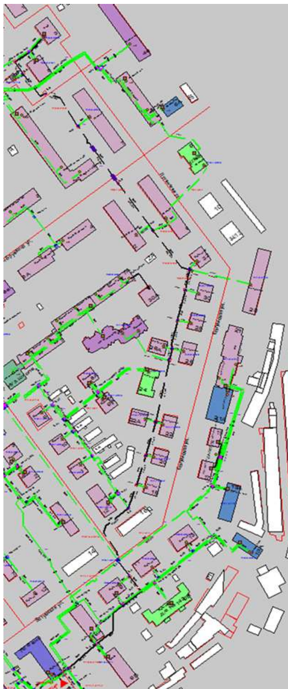
Рисунок Ошибка! Текст указанного стиля в документе отсутствует..87 – Трассировка теплопровода от котельной АО «Теплоэнерго» по ул. Углова, д. 7 до конечного потребителя «ПТ-Луган,3»
