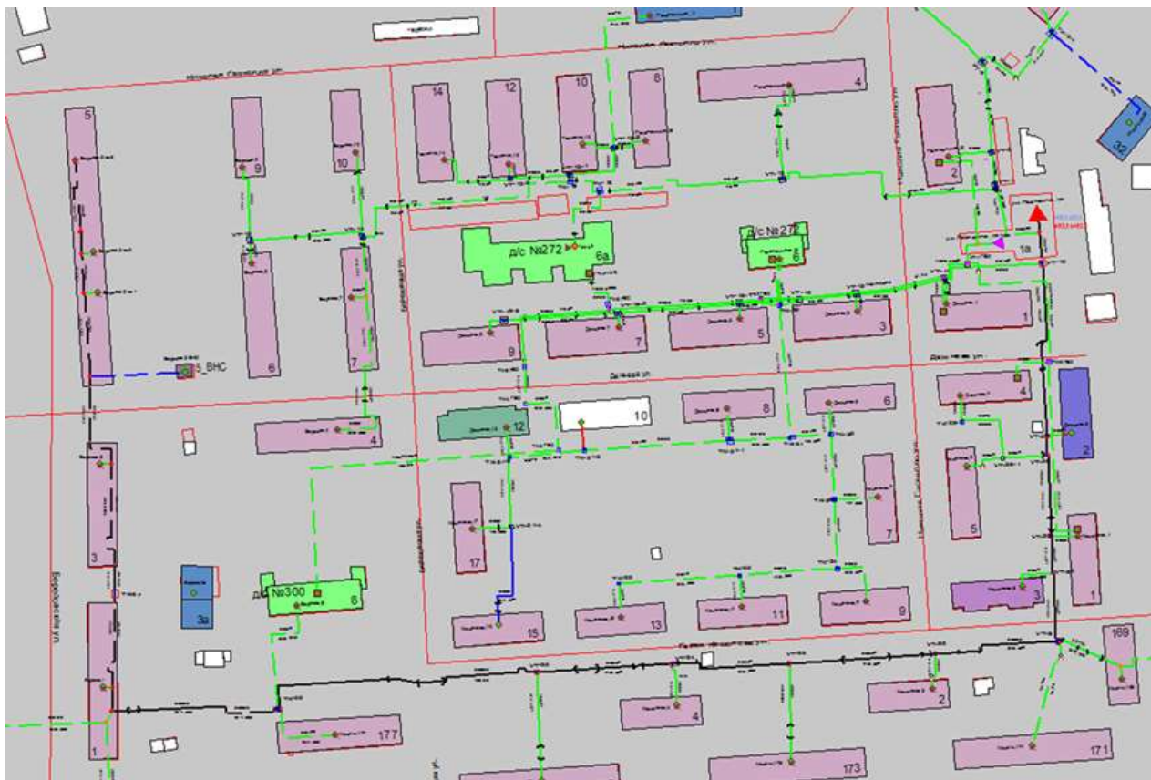
Рисунок Ошибка! Текст указанного стиля в документе отсутствует..19 – Трассировка теплопровода от котельной АО «Теплоэнерго» по ул. Гастелло, д. 1А до конечного потребителя «ПТ-Березов,5 вв3»
