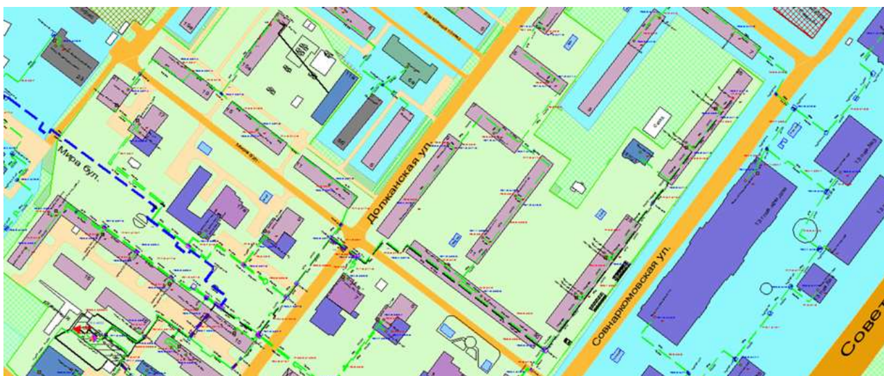
Рисунок Ошибка! Текст указанного стиля в документе отсутствует..75 – Трассировка теплопровода от котельной АО «Теплоэнерго» по ул. Мурашкинская, д. 13Б до конечного потребителя «ПТ-Совн,26 маг»
