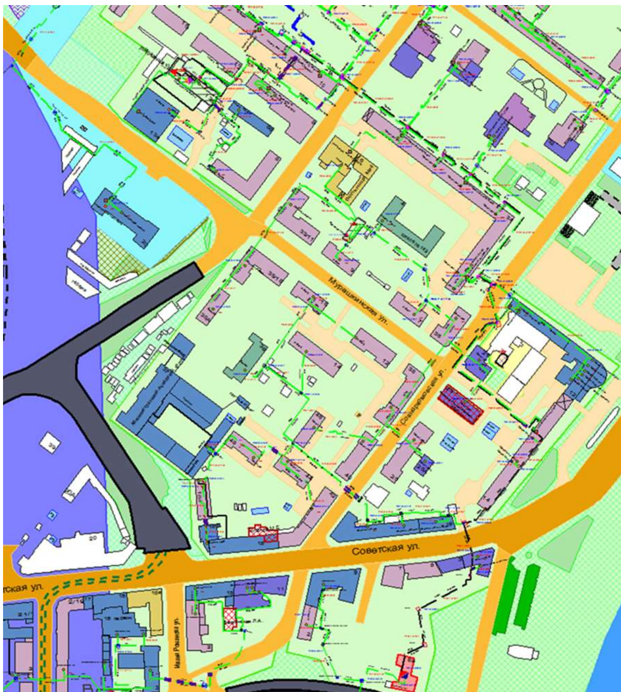
Рисунок 77 – Трассировка теплопровода от котельной АО «Теплоэнерго» по ул. Мурашкинская, д. 13Б до конечного потребителя «ЦТП-Интернацион.,8»
