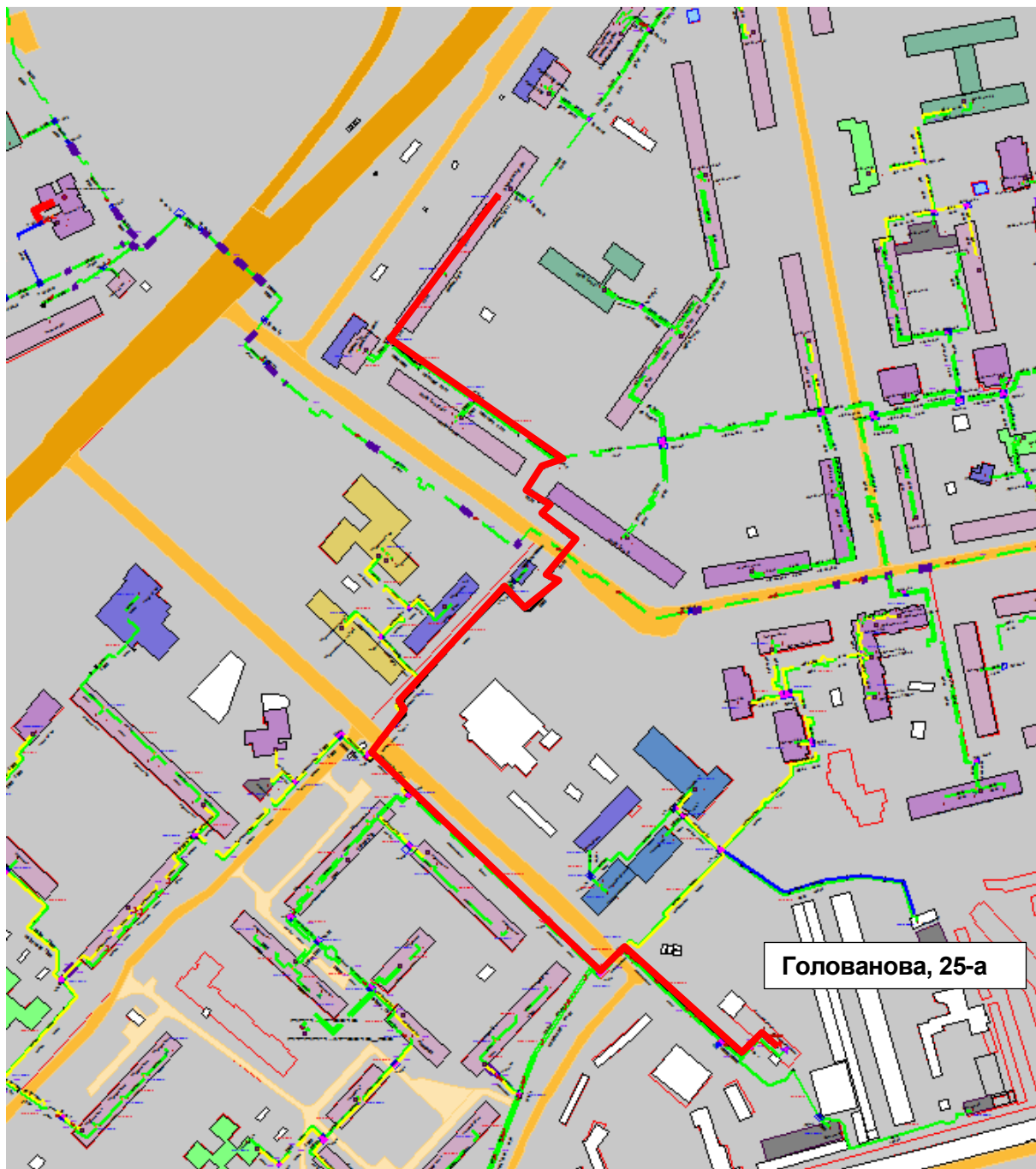
Рисунок Ошибка! Текст указанного стиля в документе отсутствует..76 – Результат гидравлического расчета - расчетный путь теплоносителя от котельной Голованова, 25-а до ПТ-Гагар.пр,184 э2
