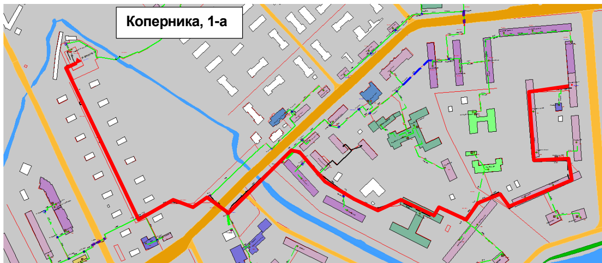
Рисунок Ошибка! Текст указанного стиля в документе отсутствует..82 – Результат гидравлического расчета - расчетный путь теплоносителя от котельной Коперника, 1-а до ПТ-Рыбак,10/1
