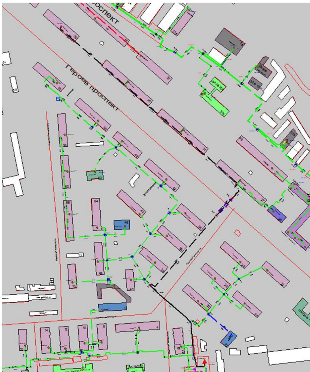
Рисунок Ошибка! Текст указанного стиля в документе отсутствует..21 Результат гидравлического расчета - расчетный путь теплоносителя от котельной Гастелло, 1-а до ПТ-Героев пр,39
