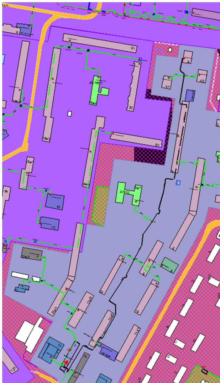
Рисунок Ошибка! Текст указанного стиля в документе отсутствует..89 Результат гидравлического расчета - расчетный путь теплоносителя от котельной Мончегорская, 11 до ПТ-Мончегорская,2а
