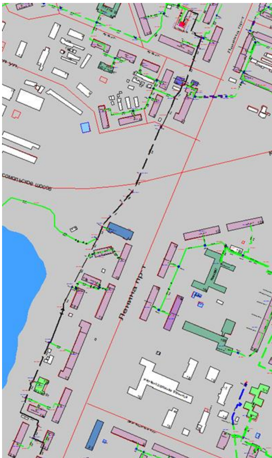
Рисунок Ошибка! Текст указанного стиля в документе отсутствует..15 Результат гидравлического расчета - расчетный путь теплоносителя от котельной пр. Ленина, 5-а до ПТ-пр.Ленина,23
