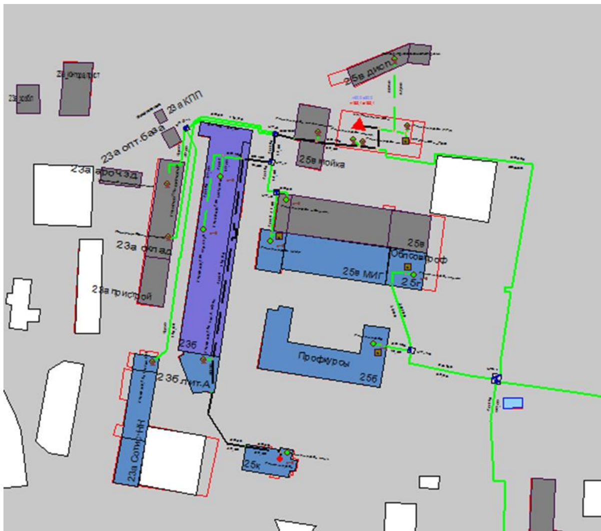
Рисунок Ошибка! Текст указанного стиля в документе отсутствует..55 Результат гидравлического расчета - расчетный путь теплоносителя от котельной Гагарина, 25-е до ПТ-Гагар.пр,25к
