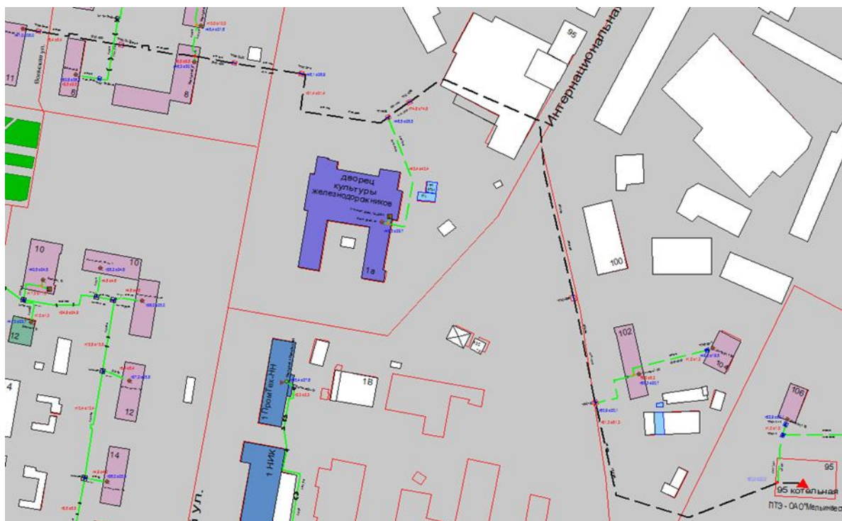
Рисунок Ошибка! Текст указанного стиля в документе отсутствует..117 Результат гидравлического расчета - расчетный путь теплоносителя от котельной Интернациональная, 95 до ПТ-Вольск,11
