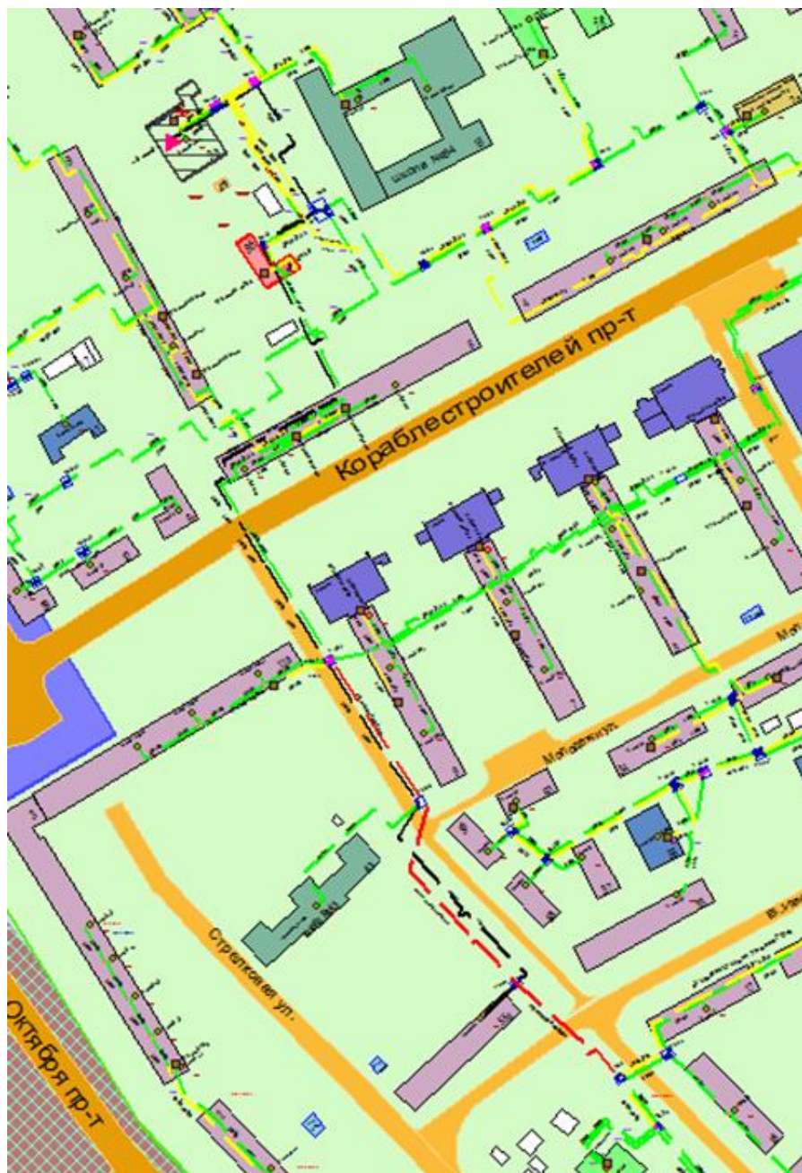
Рисунок Ошибка! Текст указанного стиля в документе отсутствует..71 Результат гидравлического расчета - расчетный путь теплоносителя от котельной Баренца, 9а до ПТ-Иван.55а
