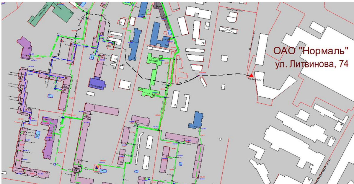
Рисунок Ошибка! Текст указанного стиля в документе отсутствует..67 Результат гидравлического расчета - расчетный путь теплоносителя от котельной Литвинова, 74 до ПТ-Октяб.рев,42 вв6
