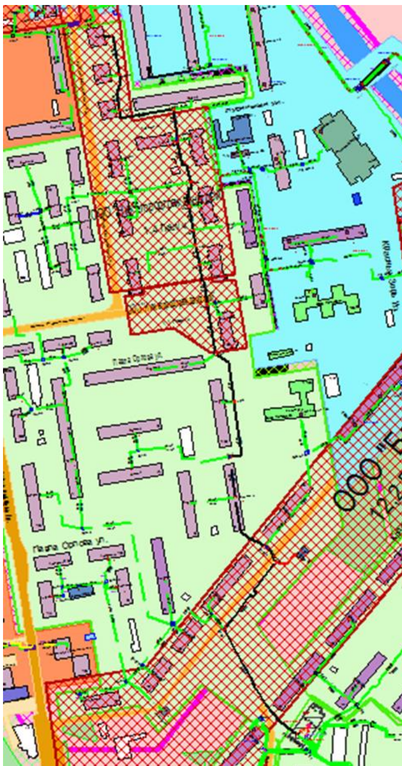
Рисунок Ошибка! Текст указанного стиля в документе отсутствует..77 Результат гидравлического расчета - расчетный путь теплоносителя от котельной Красных Зорь, 4а до ПТ-Давыд,11
