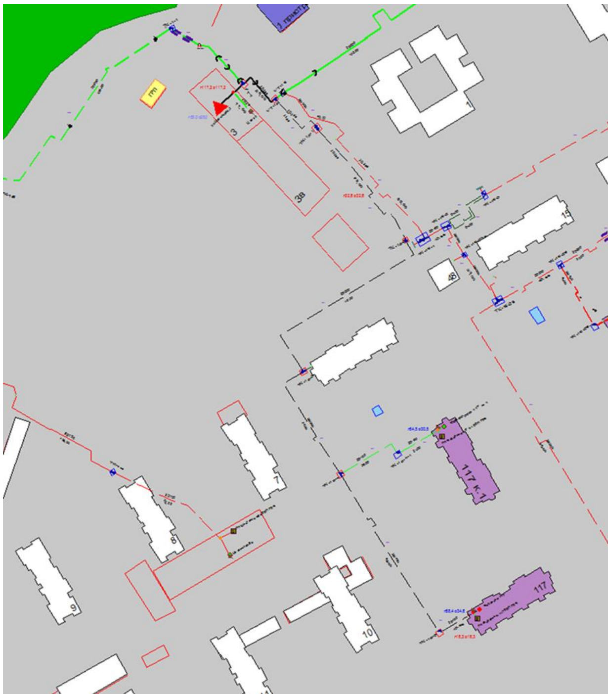
Рисунок 49 – Трассировка теплопровода от котельной АО «Теплоэнерго» «Совхоз «Цветы» по ул. Цветочная, д. 3А до конечного потребителя «ПТ-Сахарова,117»
