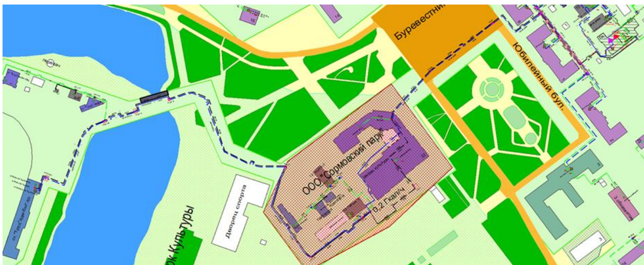
Рисунок Ошибка! Текст указанного стиля в документе отсутствует..3 – Трассировка теплопровода от котельной АО «Теплоэнерго» по ул. Энгельса, д. 1В до конечного потребителя «ПТ-Юбилейн.б-р "Труд"АБК»
