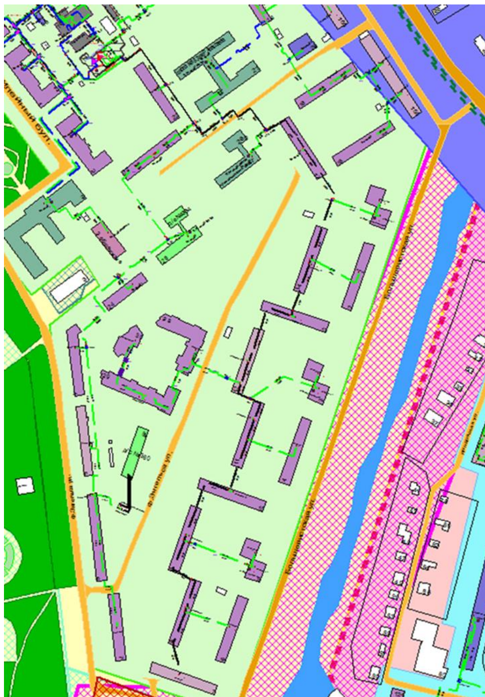
Рисунок Ошибка! Текст указанного стиля в документе отсутствует..5 – Трассировка теплопровода от котельной АО «Теплоэнерго» по ул. Энгельса, д. 1В до конечного потребителя «ПТ-Больш,7»
