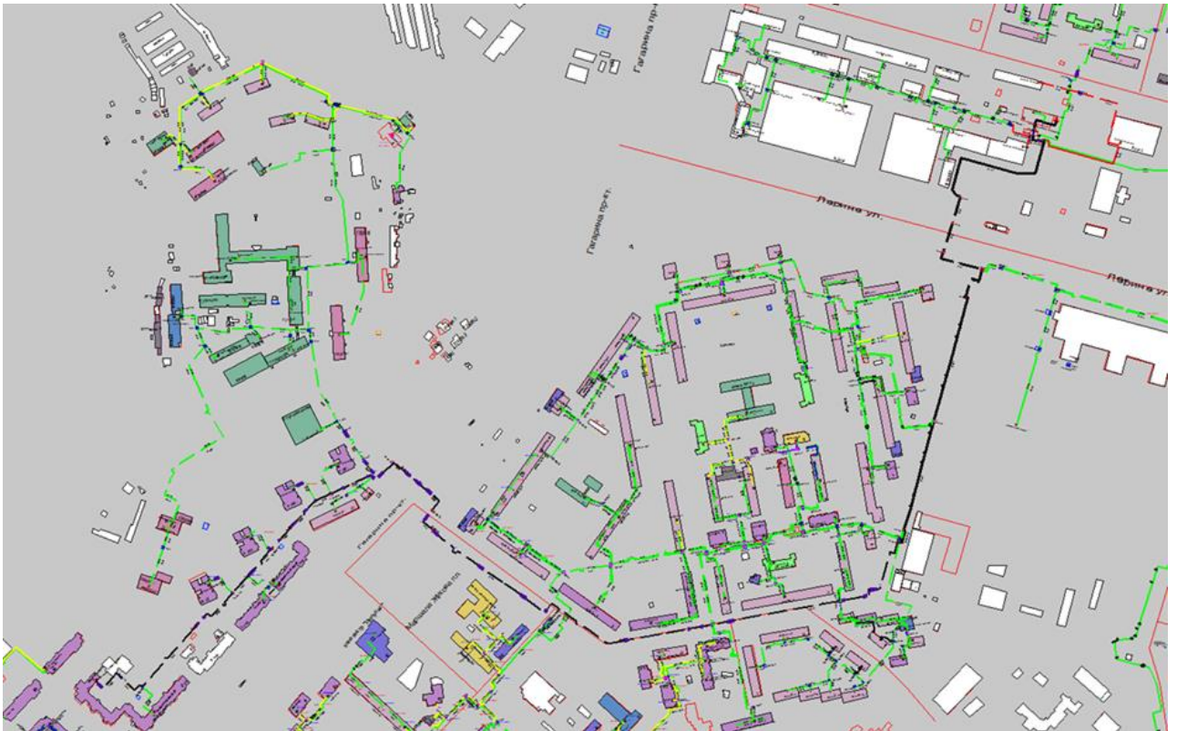
Рисунок 3.72 – Трассировка теплопровода от котельной АО «Теплоэнерго» «Термаль» по пр. Гагарина, д. 178Б до конечного потребителя «ПТ-Гагар.пр,101 корп.5 ИТП №2»
