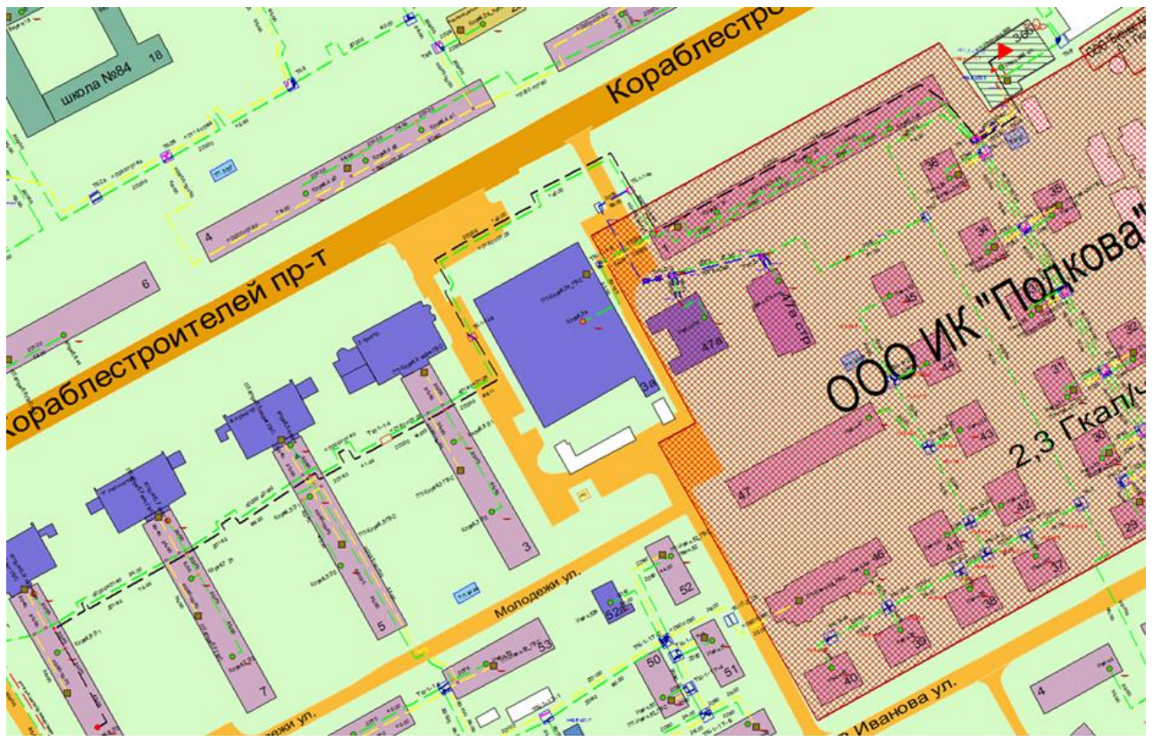
Рисунок 3.126 – Трассировка теплопровода от котельной АО «Теплоэнерго» по ул. Иванова, д. 36Б до конечного потребителя «ПТ-Кораб,9 Э2»
