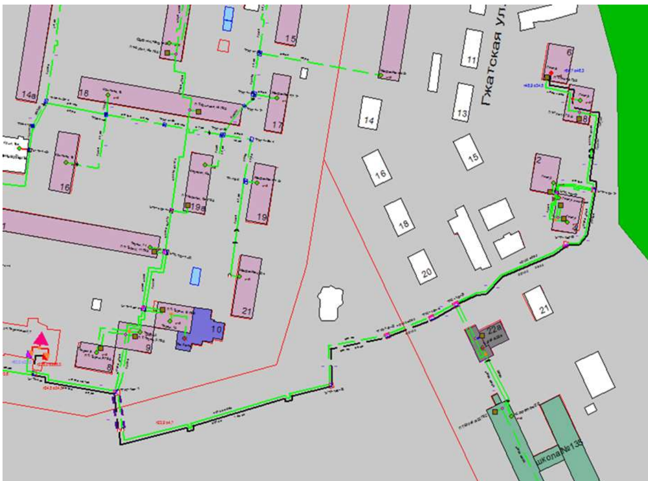
Рисунок 81 – Трассировка теплопровода от котельной АО «Теплоэнерго» по ул. Терешковой, д. 7 до конечного потребителя «ПТ-Гжат,6»
