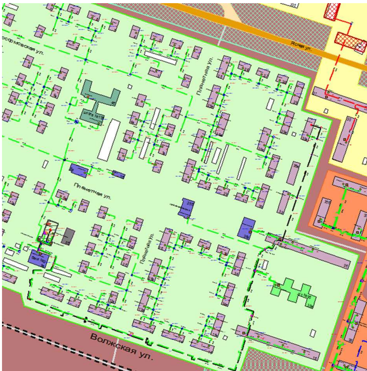
Рисунок 67 – Трассировка теплопровода от котельной АО «Теплоэнерго» по ул. Планетная, д. 8А до конечного потребителя «ПТ-Ясная,30а э2»
