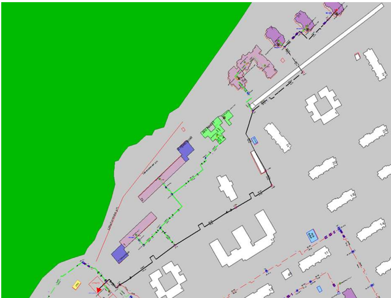
Рисунок Ошибка! Текст указанного стиля в документе отсутствует..49 – Трассировка теплопровода от котельной АО «Теплоэнерго» «Совхоз «Цветы» по ул. Цветочная, д. 3А до конечного потребителя «ПТ-Цветочная,7/2»
