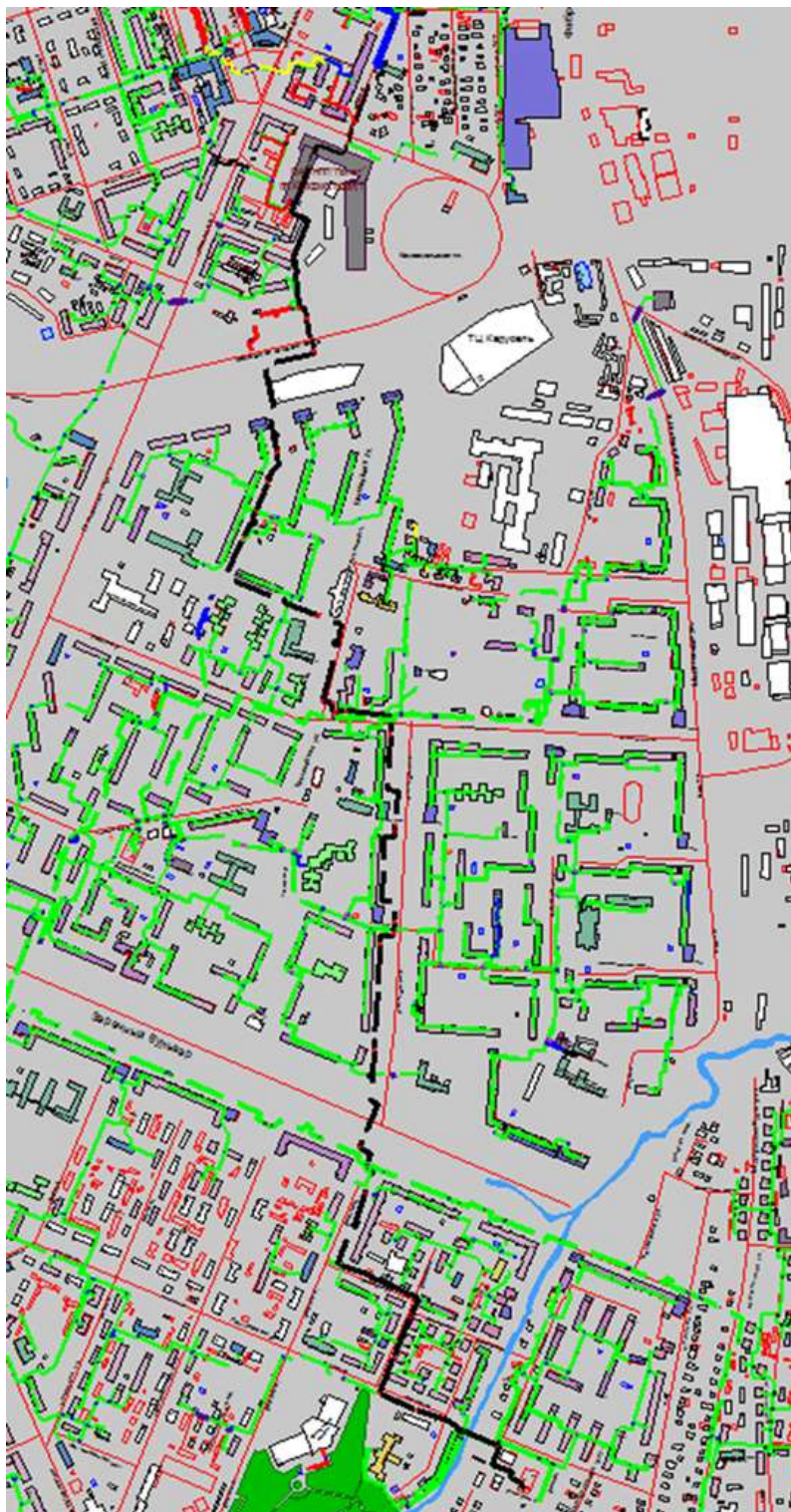
Рисунок Ошибка! Текст указанного стиля в документе отсутствует..104 – Трассировка теплопровода от котельной ФГУП НПП «Полет» по ул. Заводская, д. 19 до конечного потребителя «ПТ-Комсом.пл,3»
