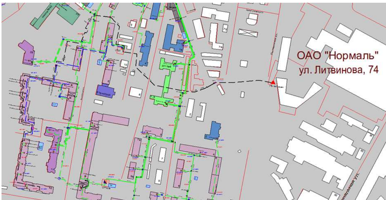
Рисунок Ошибка! Текст указанного стиля в документе отсутствует..107 – Трассировка теплопровода от котельной ОАО «Нормаль» по ул. Литвинова, д. 74 до конечного потребителя «ПТ-Октяб.рев,42 вв6»
