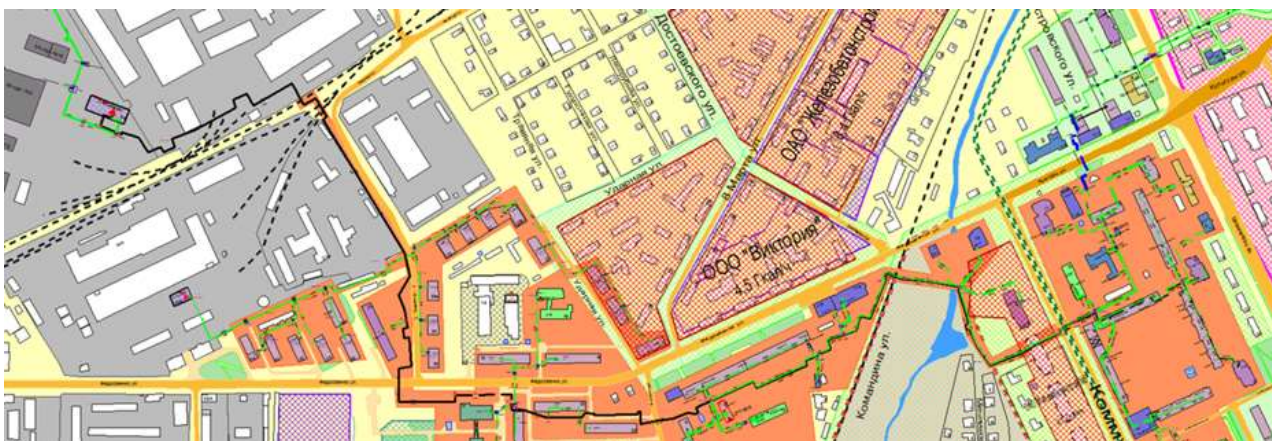
Рисунок Ошибка! Текст указанного стиля в документе отсутствует..116 – Трассировка теплопровода от котельной ФГУП «Завод Электромаш» по ул. Федосеенко, д. 64 до конечного потребителя «ПТ-Остров,9»
