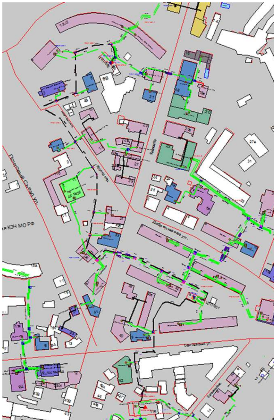
Рисунок Ошибка! Текст указанного стиля в документе отсутствует..27 – Трассировка теплопровода от котельной АО «Теплоэнерго» по пер. Плотничный, д. 11 до конечного потребителя «ЦТП-602»
