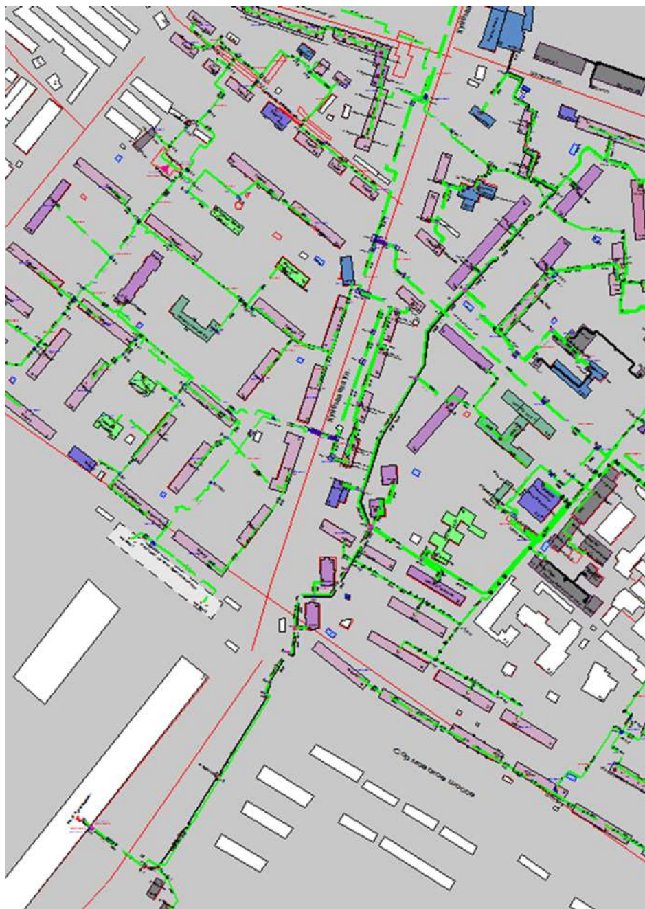
Рисунок Ошибка! Текст указанного стиля в документе отсутствует..123 – Трассировка теплопровода от котельной ГП «ОКБМ им. И.И. Африкантова» по Бурнаковскому пр., д. 15 до конечного потребителя «ПТ-Куйбыш,32,30»
