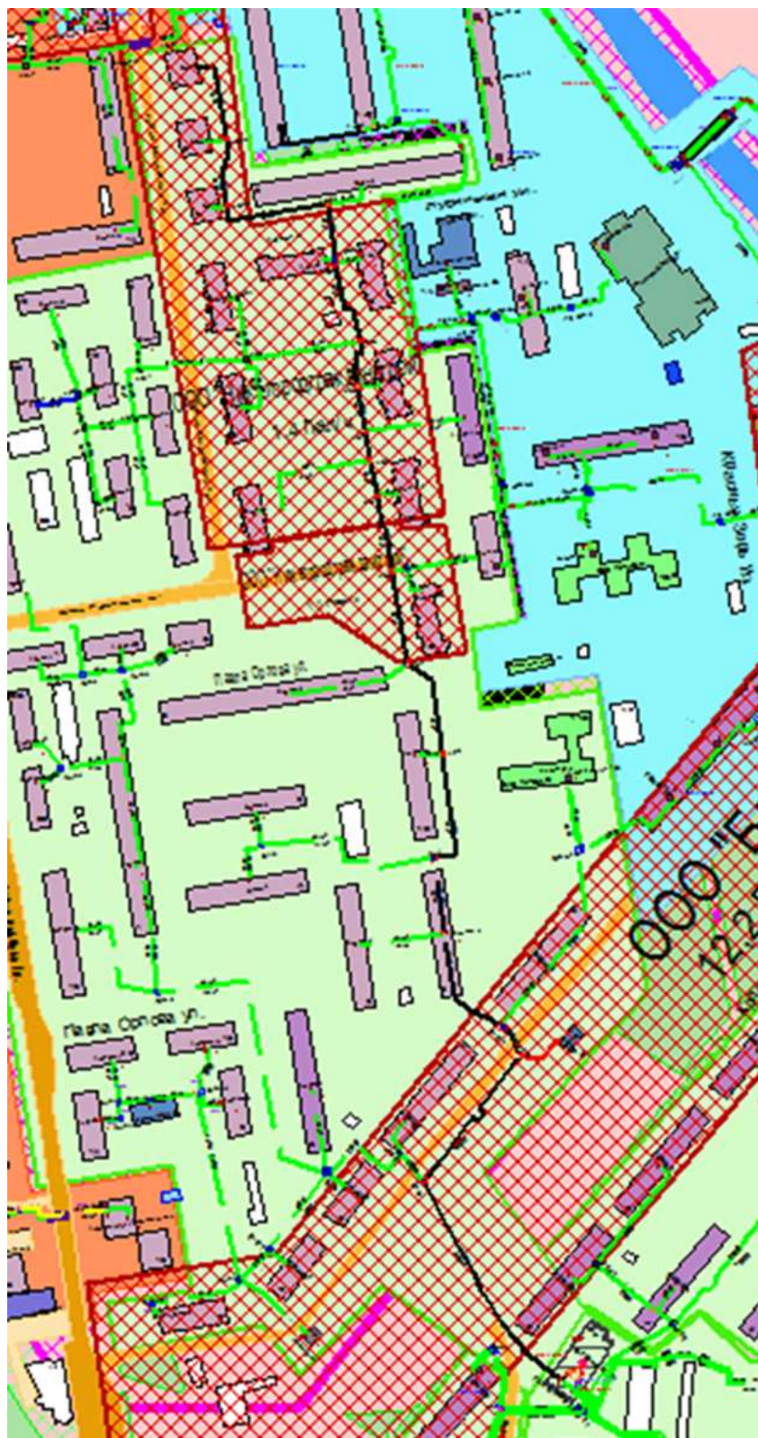
Рисунок Ошибка! Текст указанного стиля в документе отсутствует..69 – Трассировка теплопровода от котельной АО «Теплоэнерго» по ул. Красных Зорь, д. 4А до конечного потребителя «ПТ-Давыд,11»
