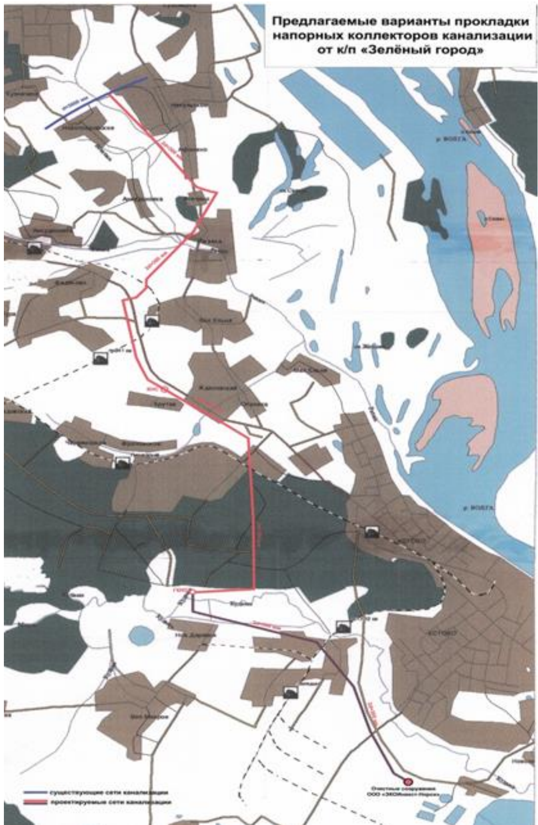
Варианты прокладки напорных коллекторов
