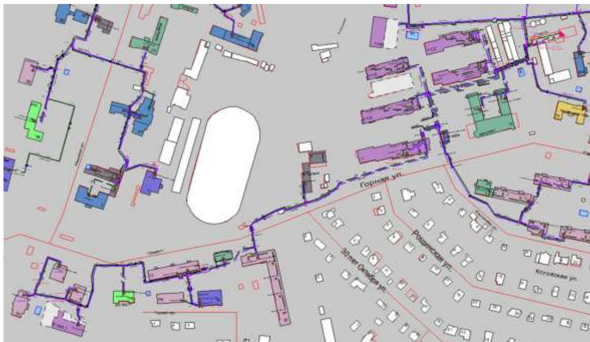
Рисунок Ошибка! Текст указанного стиля в документе отсутствует..39 Результат гидравлического расчета - расчетный путь теплоносителя от котельной Горная, 13 до ПТ-Горная,2а
