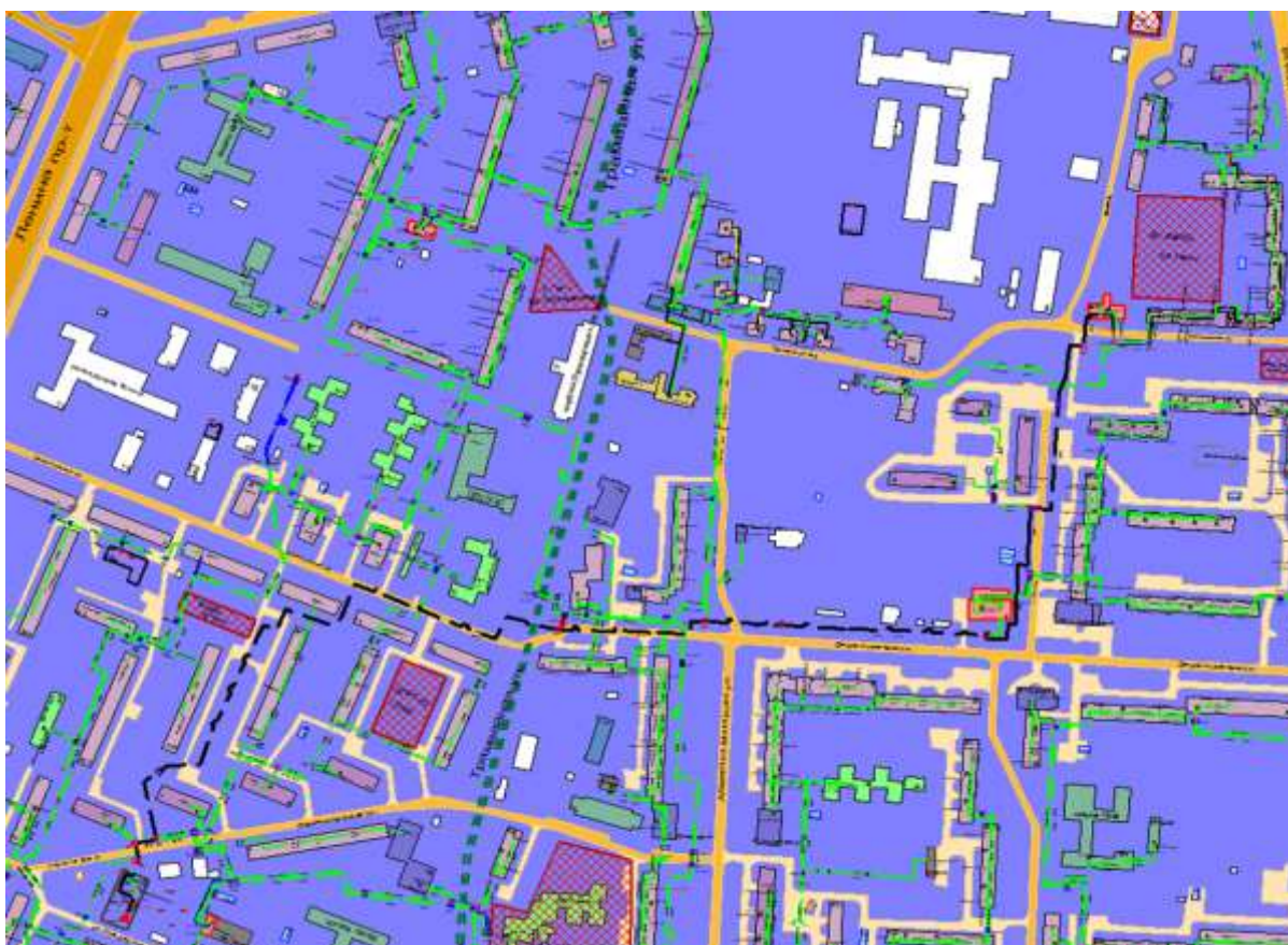
Рисунок Ошибка! Текст указанного стиля в документе отсутствует..7 Результат гидравлического расчета - расчетный путь теплоносителя от котельной Академика Баха, 4-а до ПТ-Мотал,6
