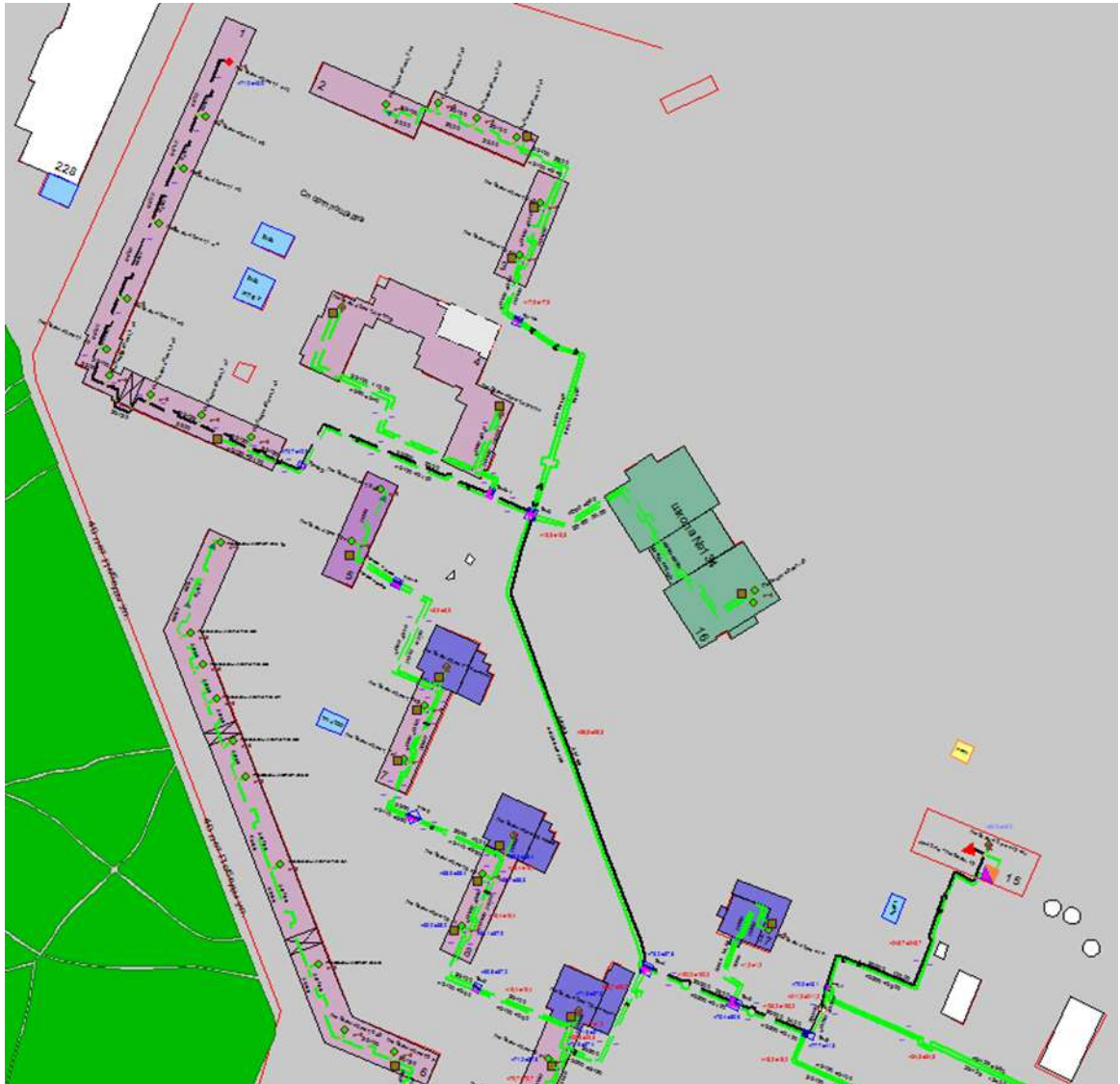
Рисунок Ошибка! Текст указанного стиля в документе отсутствует..43 Результат гидравлического расчета - расчетный путь теплоносителя от котельной 40 лет Победы, 15 до ПТ-Победы 40лет,1 э10
