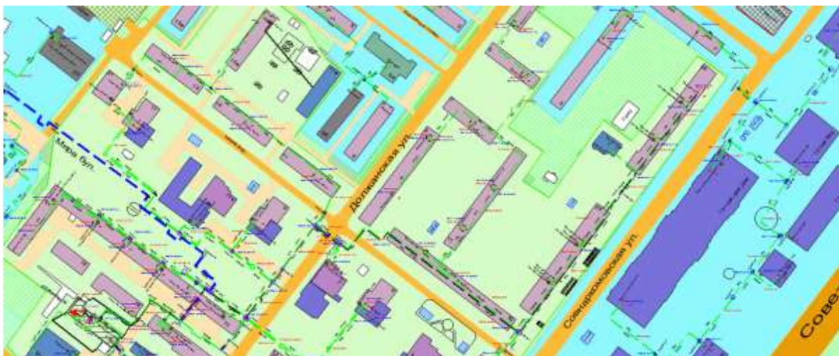
Рисунок Ошибка! Текст указанного стиля в документе отсутствует..85 Результат гидравлического расчета - расчетный путь теплоносителя от котельной Мурашкинская, 136 до ПТ-Совн,26 маг
