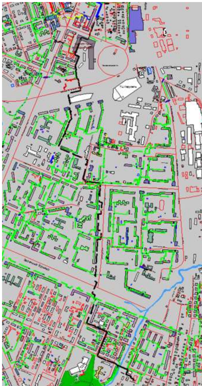
Рисунок Ошибка! Текст указанного стиля в документе отсутствует..65 Результат гидравлического расчета - расчетный путь теплоносителя от котельной Заводская, 19 до ПТ-Комсом.пл,3
