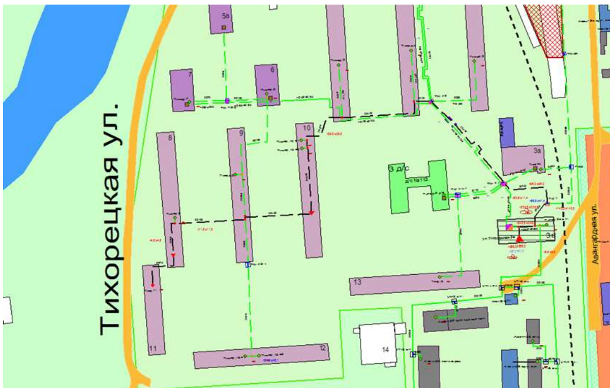
Рисунок Ошибка! Текст указанного стиля в документе отсутствует. 83 Результат гидравлического расчета - расчетный путь теплоносителя от котельной Тихорецкая, 3в до ПТ-Тихор, 11
