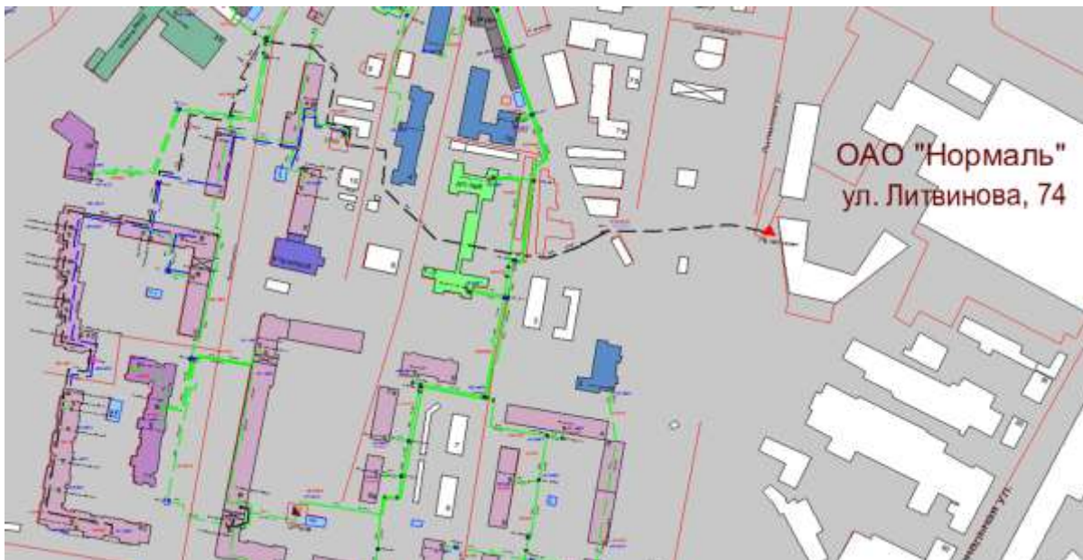
Рисунок 1.189. Результат гидравлического расчета - расчетный путь теплоносителя от котельной Литвинова, 74 до ПТ-Октяб.рев,42 вв6
