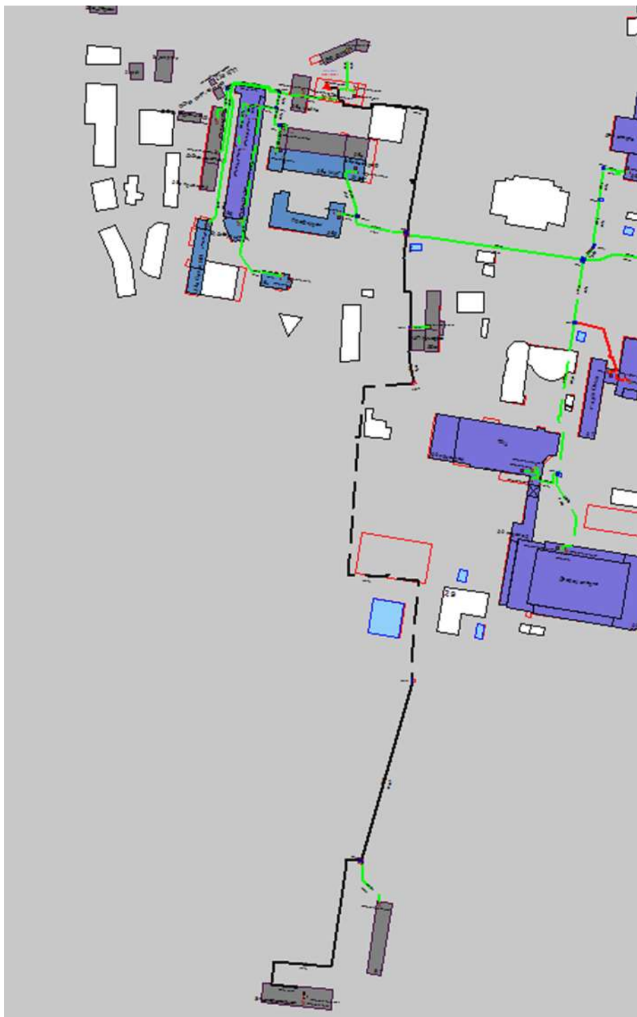
Рисунок Ошибка! Текст указанного стиля в документе отсутствует..53 Результат гидравлического расчета - расчетный путь теплоносителя от котельной Гагарина, 25-е до ПТ-Гагар.пр,31 хлор
