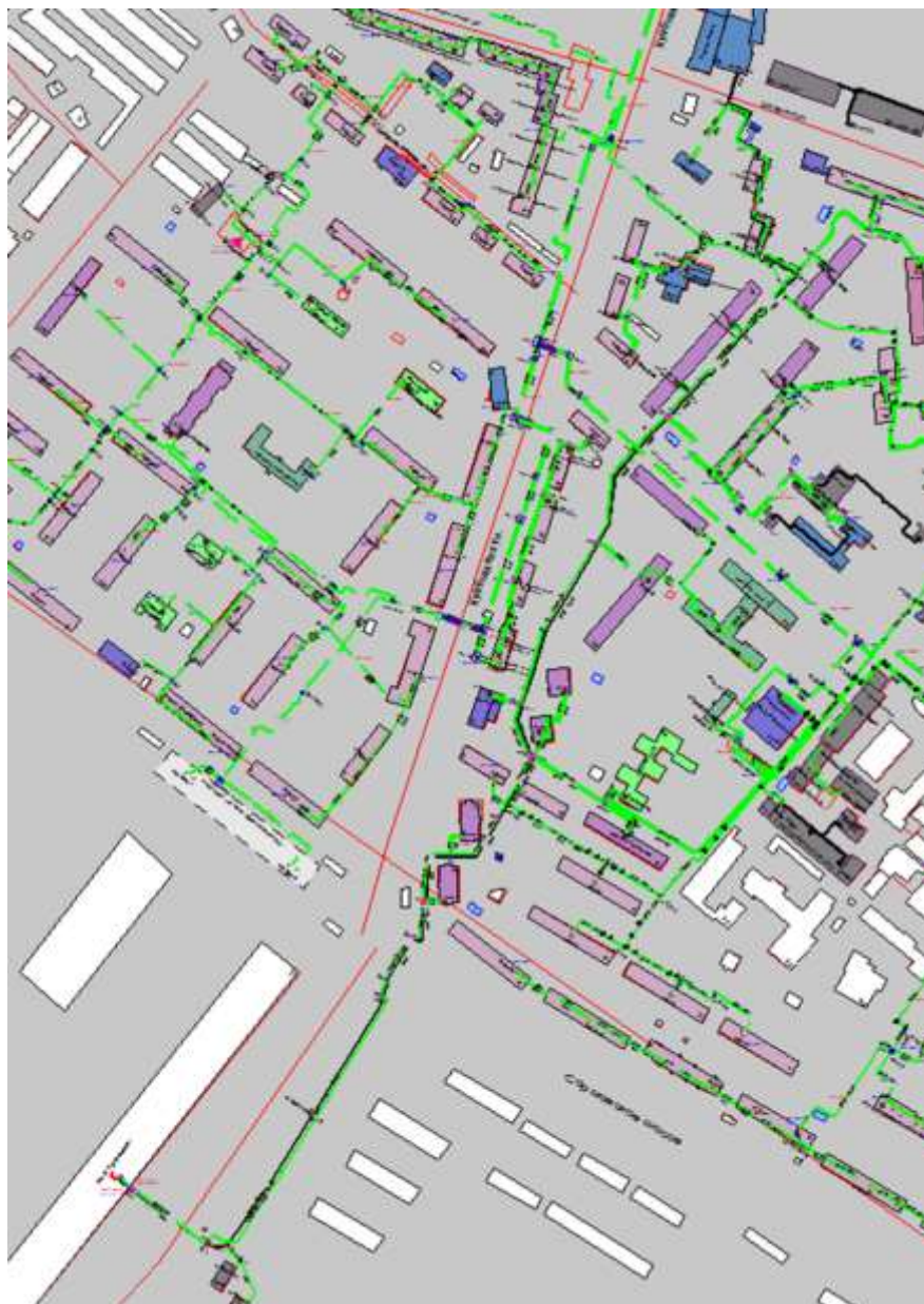
Рисунок Ошибка! Текст указанного стиля в документе отсутствует..115 Результат гидравлического расчета - расчетный путь теплоносителя от котельной Бурнаковский пр., 15 до ПТ-Куйбыш,32,30
