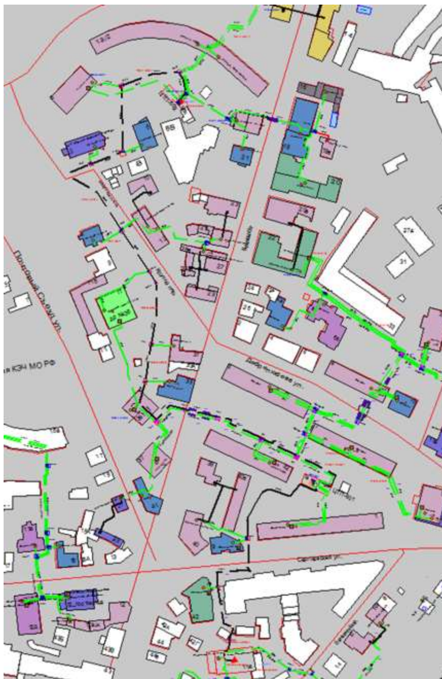
Рисунок Ошибка! Текст указанного стиля в документе отсутствует..25 Результат гидравлического расчета - расчетный путь теплоносителя от котельной Плотничный, 11 до ЦТП-602
