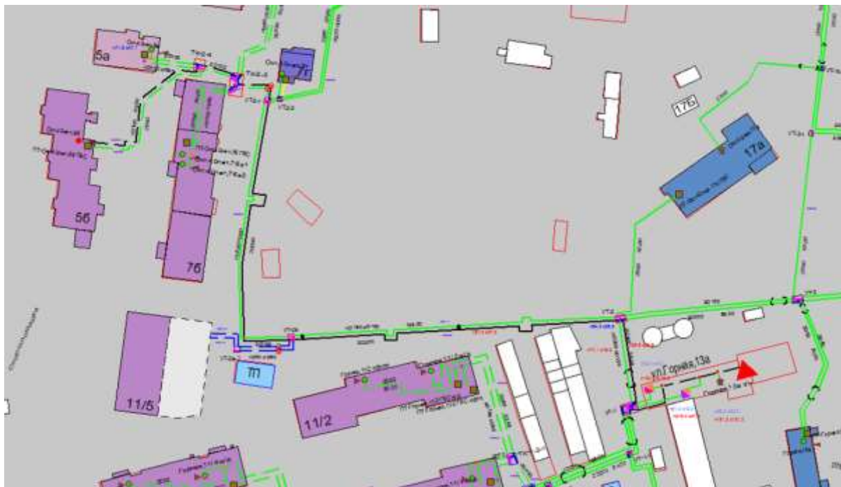
Рисунок Ошибка! Текст указанного стиля в документе отсутствует..41 Результат гидравлического расчета - расчетный путь теплоносителя от котельной Горная, 13 до ПТ-Окт.40лет,5б
