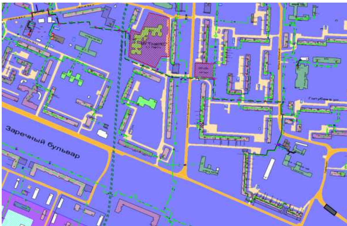
Рисунок Ошибка! Текст указанного стиля в документе отсутствует..9 Результат гидравлического расчета - расчетный путь теплоносителя от котельной Академика Баха, 4-а до ПТ-Макар, 18 э2
