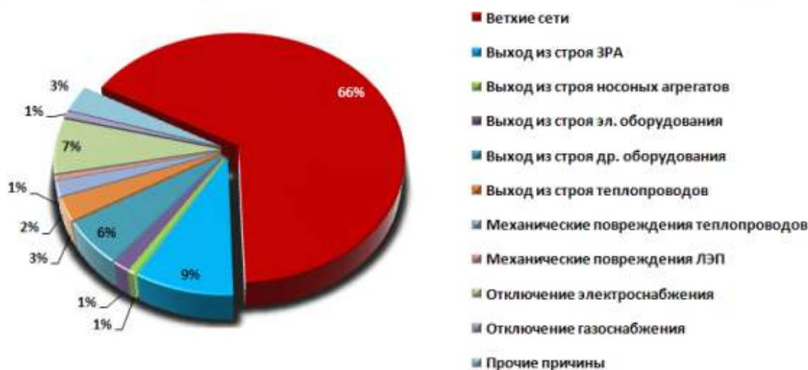
Рисунок 12.1 – Распределение причин технологических нарушений в теплоснабжении объектов ЖКХ Нижнего Новгорода в период 2008÷2012 гг.
