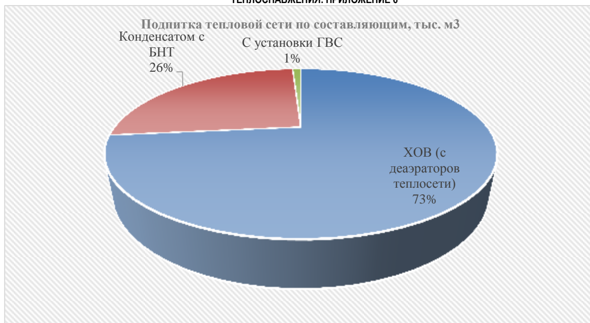
Рисунок 45. Подпитка тепловой сети по составляющим
