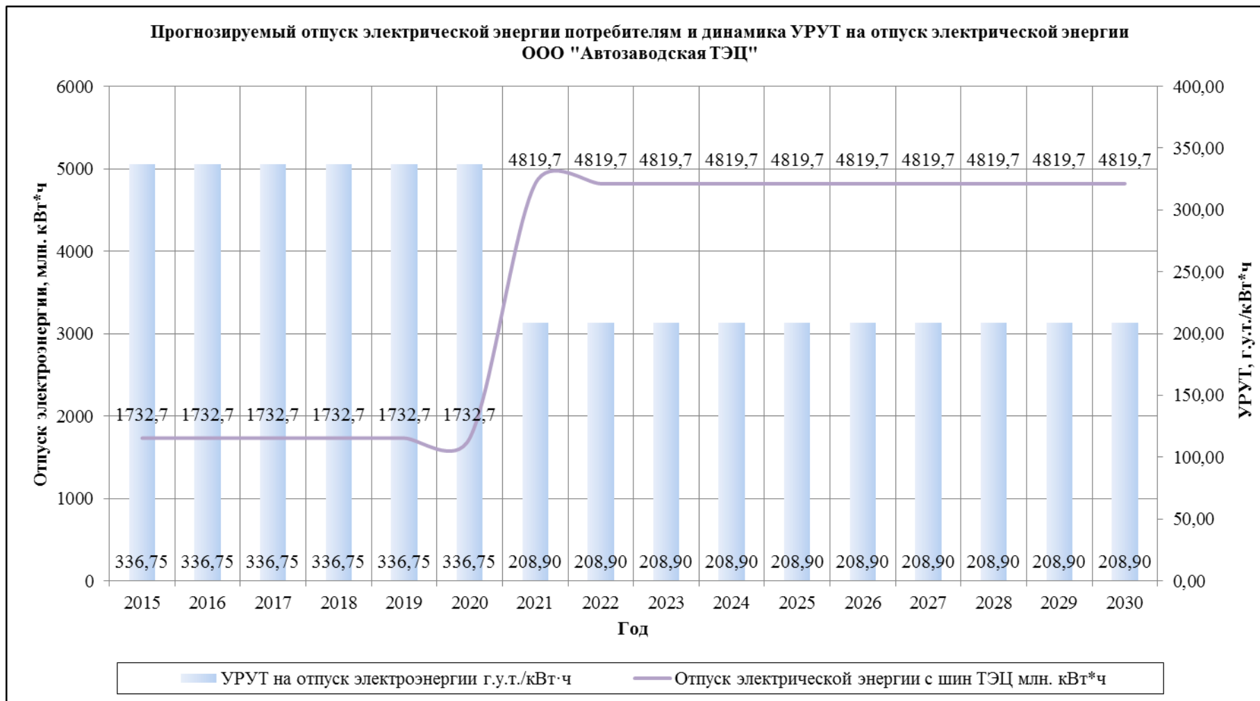
Рисунок 3.1. – Прогнозируемый отпуск электрической энергии потребителям и динамика УРУТ на отпуск электрической энергии
