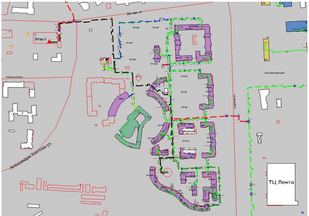
Рисунок 3.119 – Трассировка теплопровода от котельной ООО «Нижновтеплоэнерго» по ул. Деловая, д. 14 до конечного потребителя «ПТ-Рыбак,10/1»
