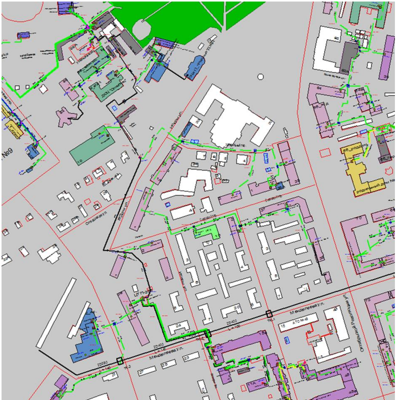
Рисунок 3.47 – Трассировка теплопровода от котельной АО «Теплоэнерго» по ул. Климовская, д. 86А до конечного потребителя «ПТ-Искры,11а»
