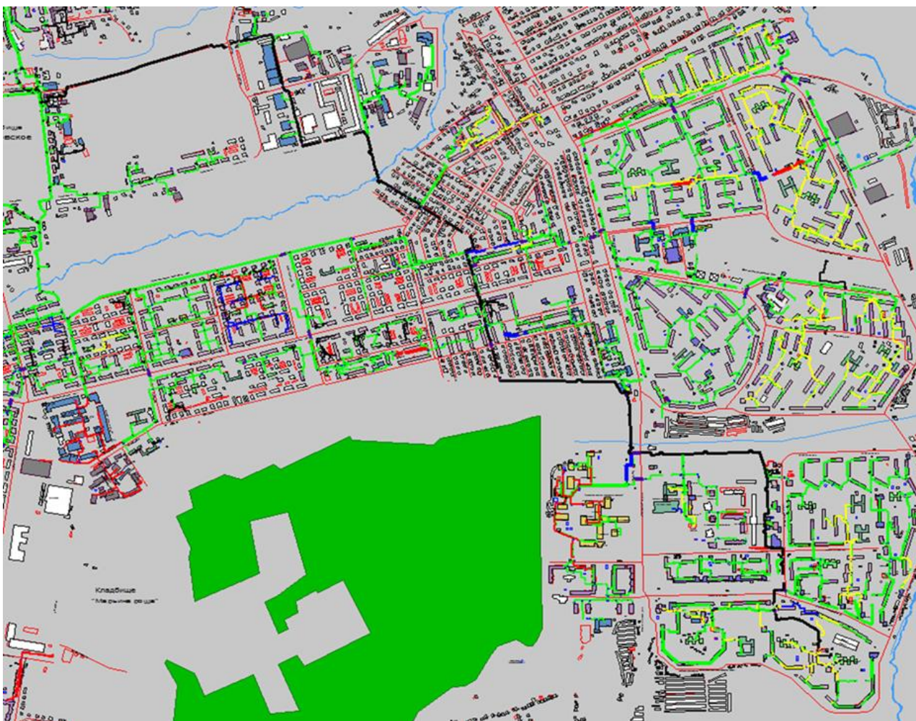
Рисунок 3.15 – Трассировка теплопровода от котельной АО «Теплоэнерго» «Нагорная теплоцентраль» (НТЦ) по ул. Ветеринарная, д.5 до конечного потребителя «ПТ-Малин,2 пристрой»
