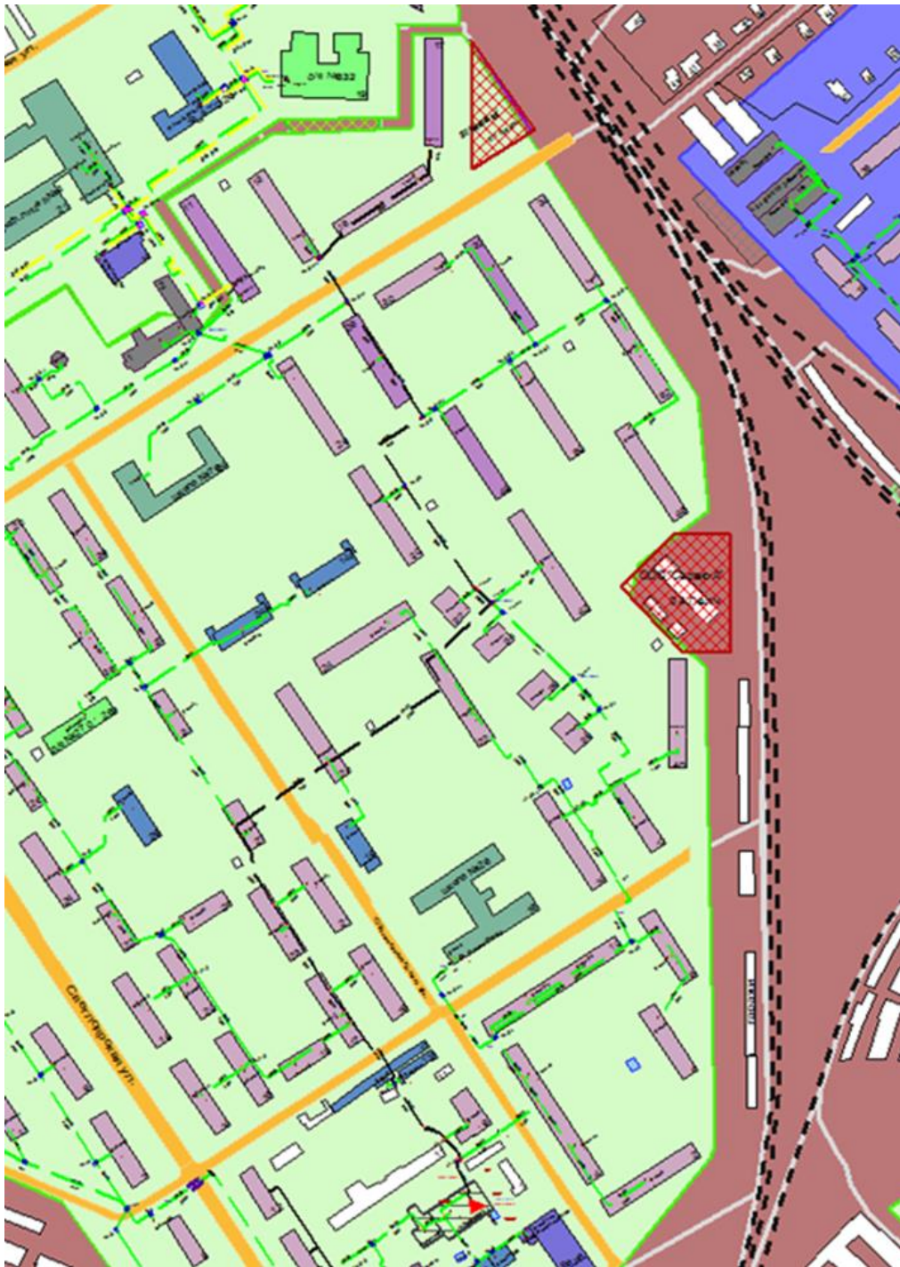
Рисунок 3.53 – Трассировка теплопровода от котельной АО «Теплоэнерго» по ул. Станиславского, д. 3 до конечного потребителя «ПТ-Мокр,17»
