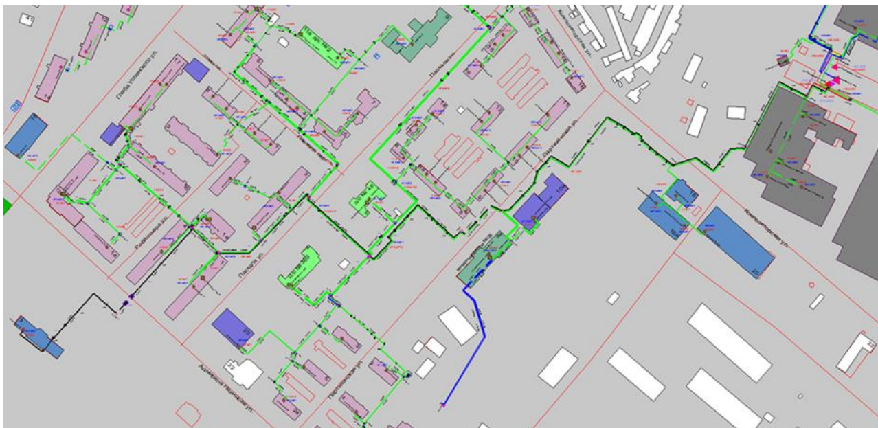
Рисунок 3.27 – Трассировка теплопровода от котельной АО «Теплоэнерго» по ул. Памирская, д. 11 до конечного потребителя «ПТ-Нахимов,3»
