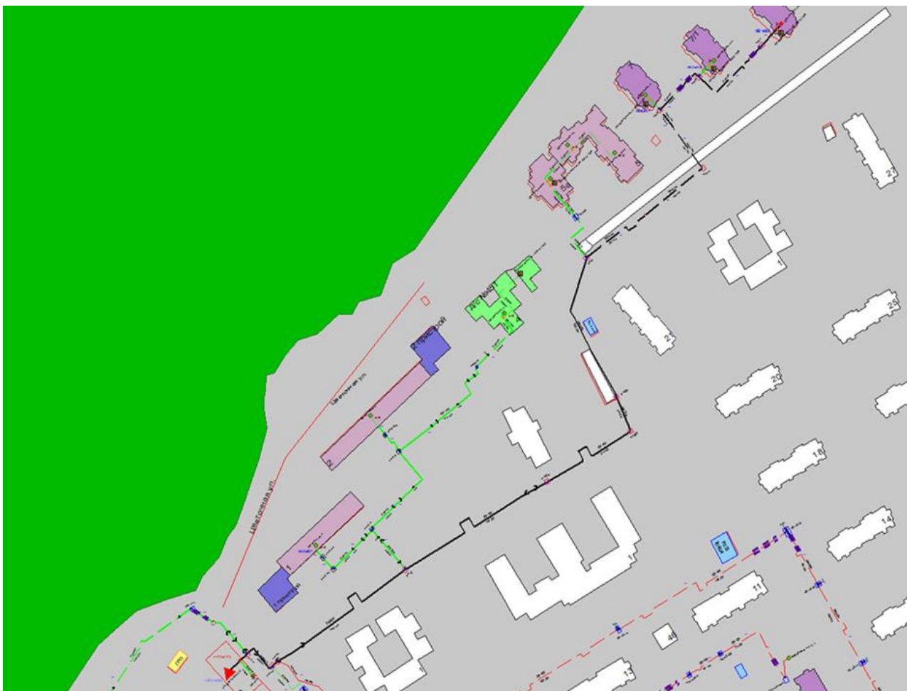
Рисунок Ошибка! Текст указанного стиля в документе отсутствует..47 – Трассировка теплопровода от котельной АО «Теплоэнерго» «Совхоз «Цветы» по ул. Цветочная, д. 3А до конечного потребителя «ПТ-Цветочная,7/2»
