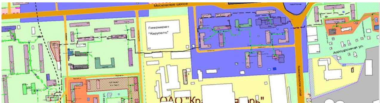
Рисунок Ошибка! Текст указанного стиля в документе отсутствует..71 – Трассировка теплопровода от котельной АО «Теплоэнерго» по ул. Тихорецкая, д. 3В до конечного потребителя «ПТ-Моск.ш,82»
