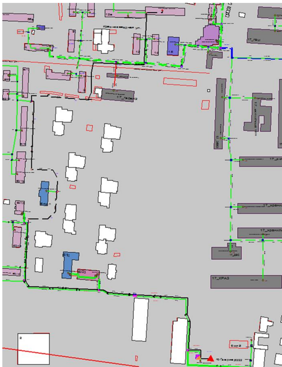
Рисунок Ошибка! Текст указанного стиля в документе отсутствует..57 – Трассировка теплопровода от котельной АО «Теплоэнерго» «ГЗРУ» по пр. Гагарина, д. 60 к. 22 до конечного потребителя «ПТ-Краснозв,12а вв2»
