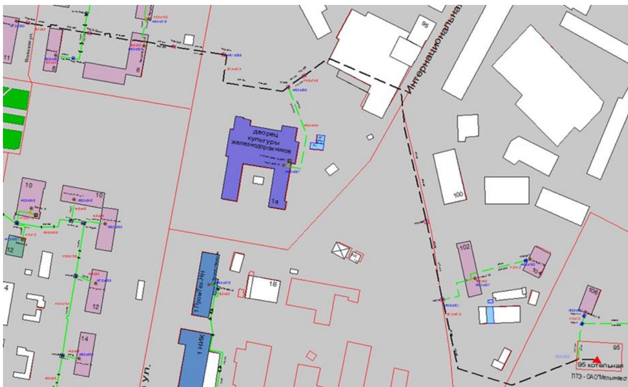
Рисунок Ошибка! Текст указанного стиля в документе отсутствует..117 – Трассировка теплопровода от котельной ОАО «Мельинвест» по ул. Интернациональная, д. 95 до конечного потребителя «ПТ-Вольск,11»
