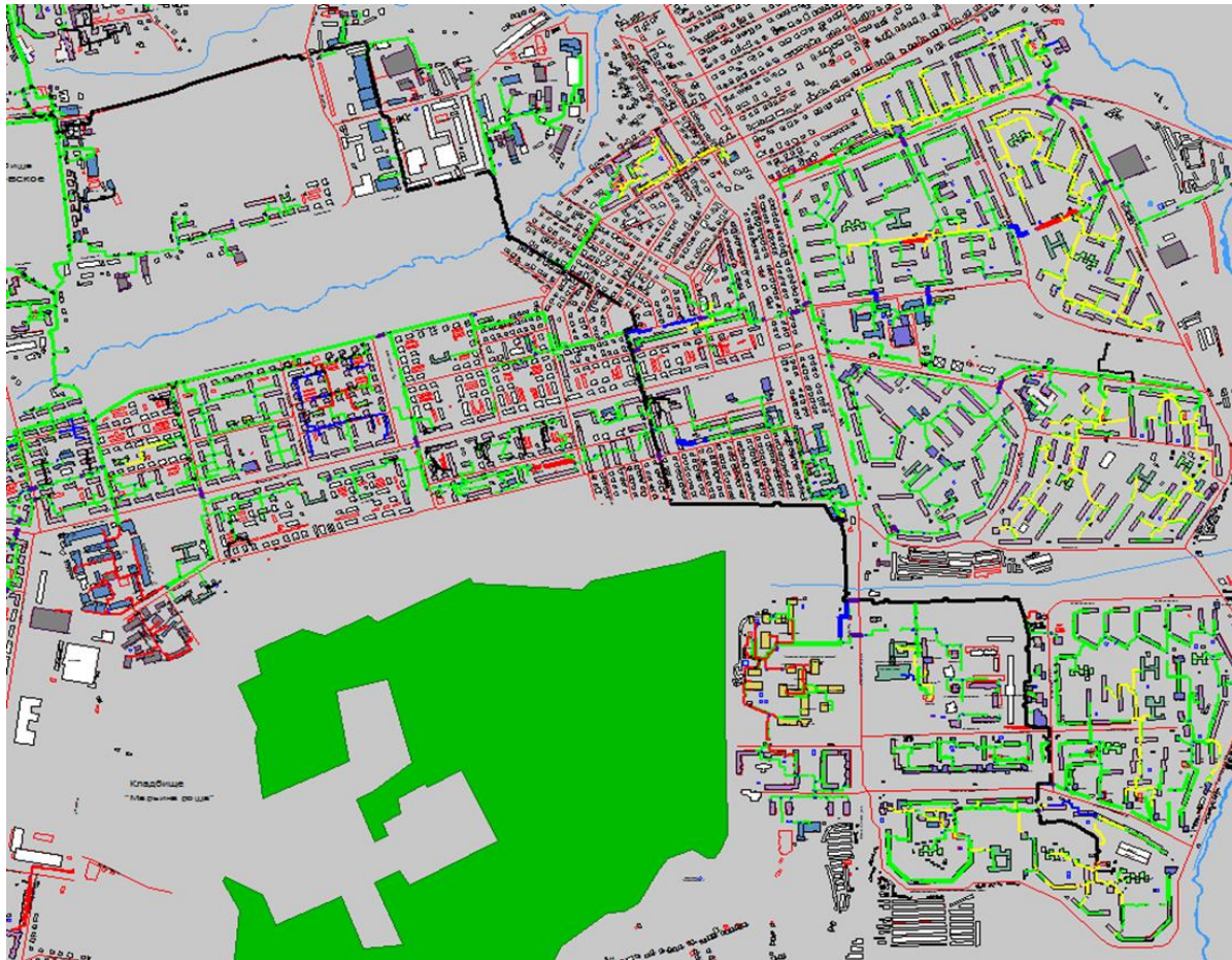
Рисунок 1.49 Результат гидравлического расчета - расчетный путь теплоносителя от котельной НТЦ до ПТ-Малин,2 пристрой
