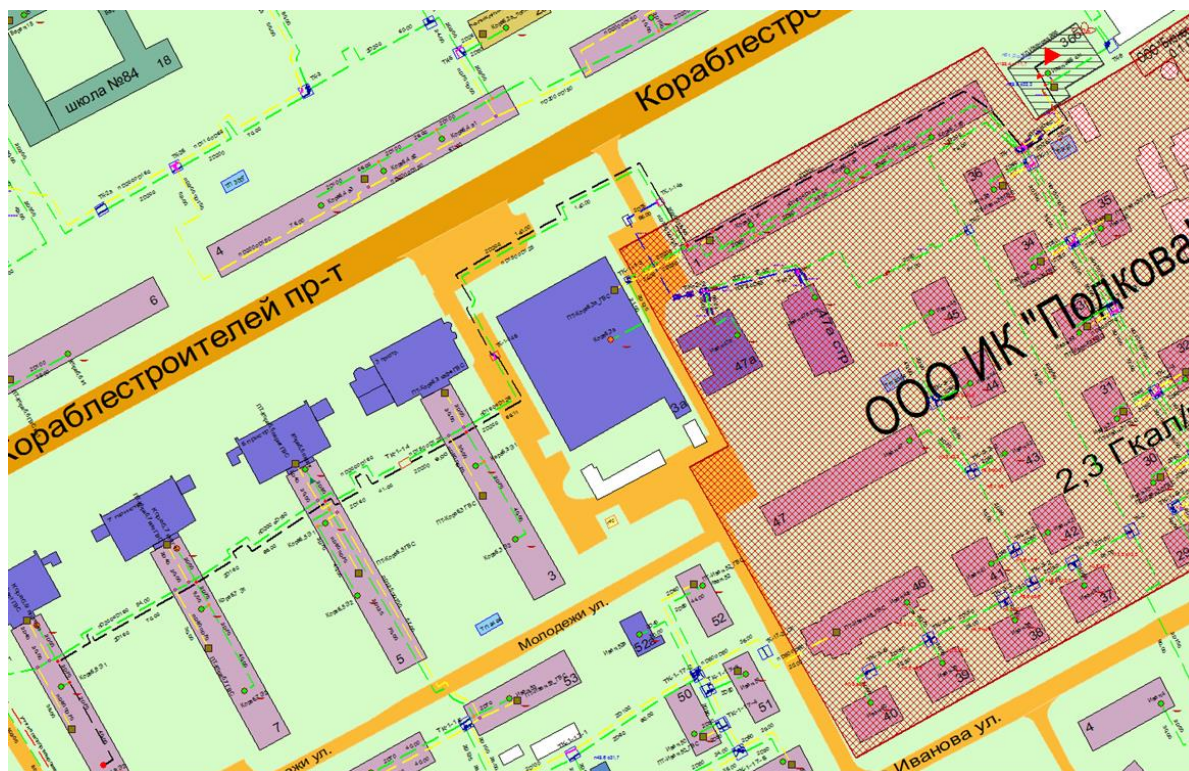
Рисунок 1.117 Результат гидравлического расчета - расчетный путь теплоносителя от котельной ул. Иванова, 36-б до ПТ-Кораб,9 Э2
