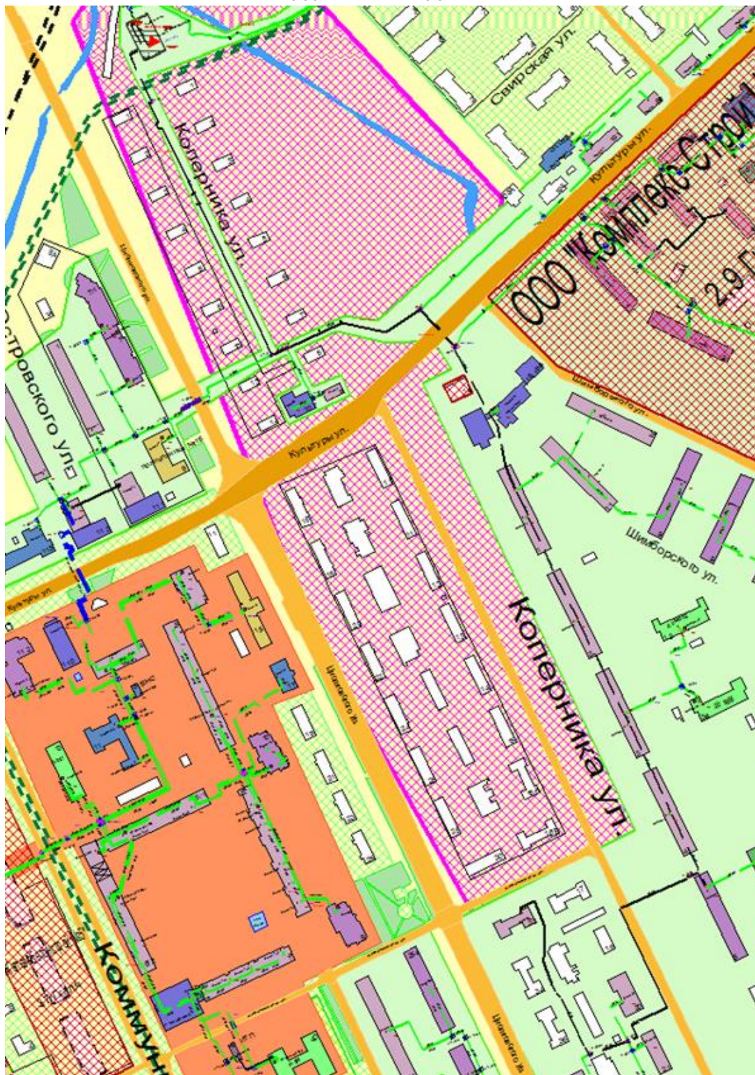
Рисунок 1.119 Результат гидравлического расчета - расчетный путь теплоносителя от котельной Коперника, 1-а до ПТ-Циол,32
