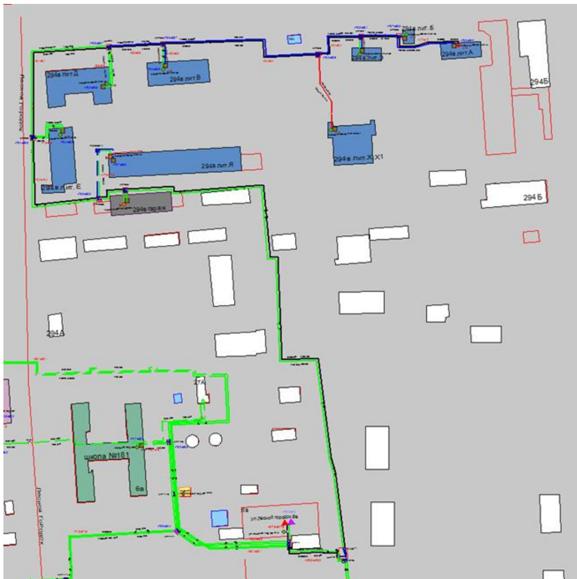
Рисунок 1.19 Результат гидравлического расчета - расчетный путь теплоносителя от котельной Лесной городок, 6в до ПТ-Моск.ш,294в лит.Б
