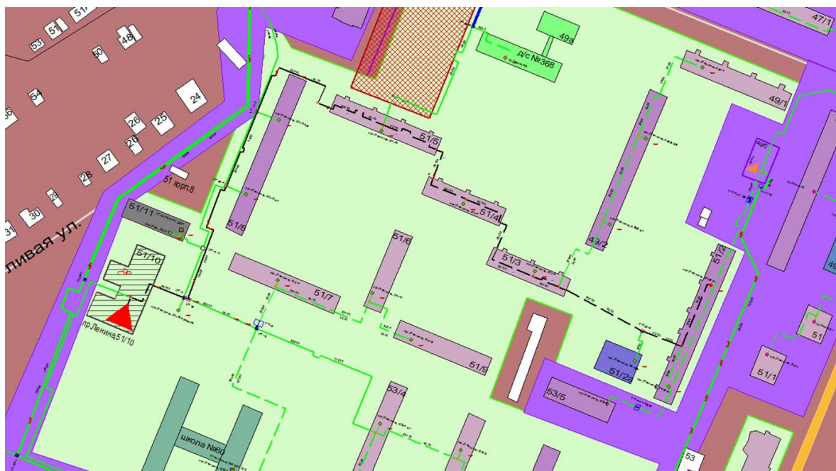
Рисунок 1.85 Результат гидравлического расчета - расчетный путь теплоносителя от котельной пр. Ленина, 51 корпус 10 до ПТ-пр.Ленина,51/2 э1
