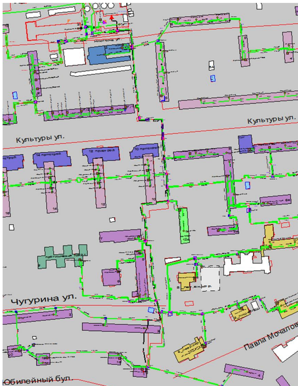
Рисунок 1.105 Результат гидравлического расчета - расчетный путь теплоносителя от котельной Пугачева, 1 до ПТ-Юбилейн. б-р,17
