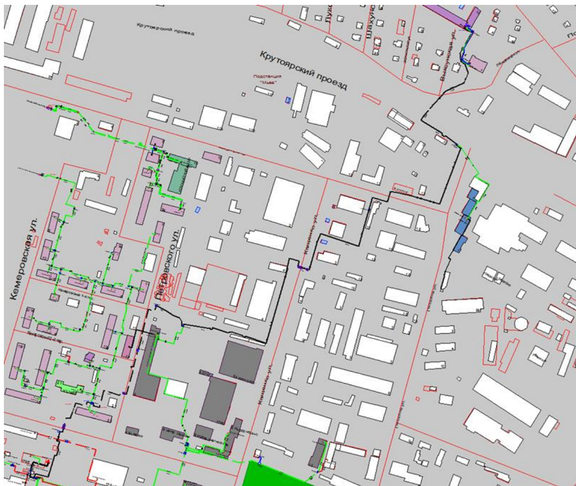
Рисунок 1.59 Результат гидравлического расчета - расчетный путь теплоносителя от котельной пр. Гагарина, 1786 до ЦТП-706
