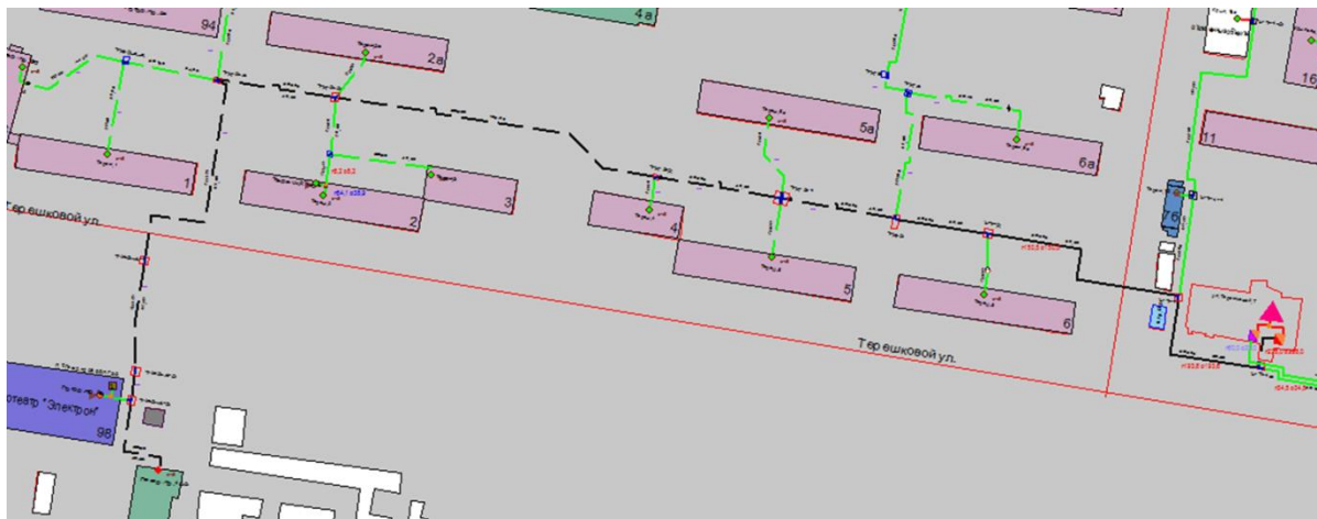
Рисунок Ошибка! Текст указанного стиля в документе отсутствует..101 Результат гидравлического расчета - расчетный путь теплоносителя от котельной Терешковой, 7 до ПТ-Гагар.пр,100
