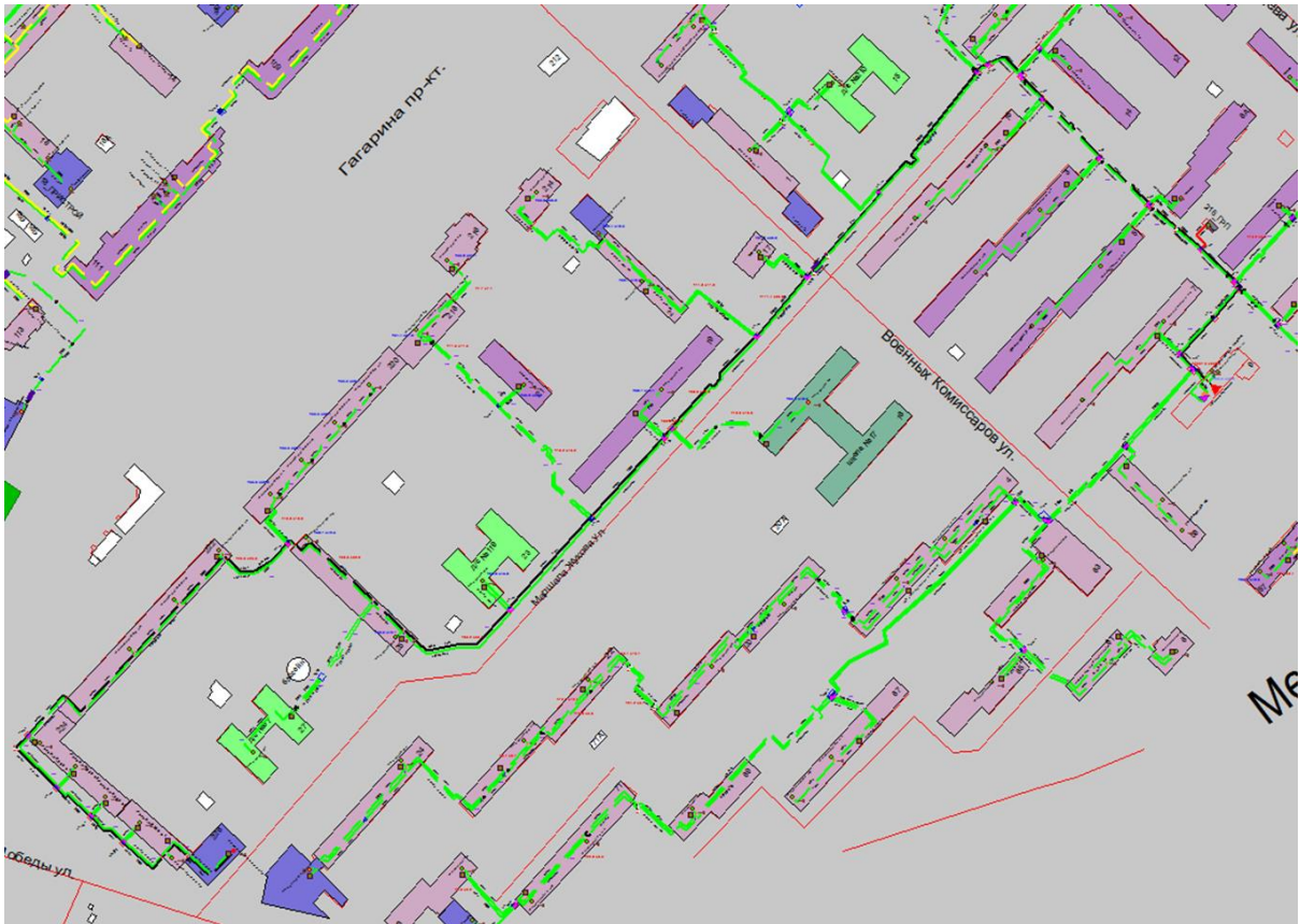
Рисунок Ошибка! Текст указанного стиля в документе отсутствует..31 Результат гидравлического расчета - расчетный путь теплоносителя от котельной Военных комиссаров, 9 до ПТ-Гагар.пр,226 пристр
