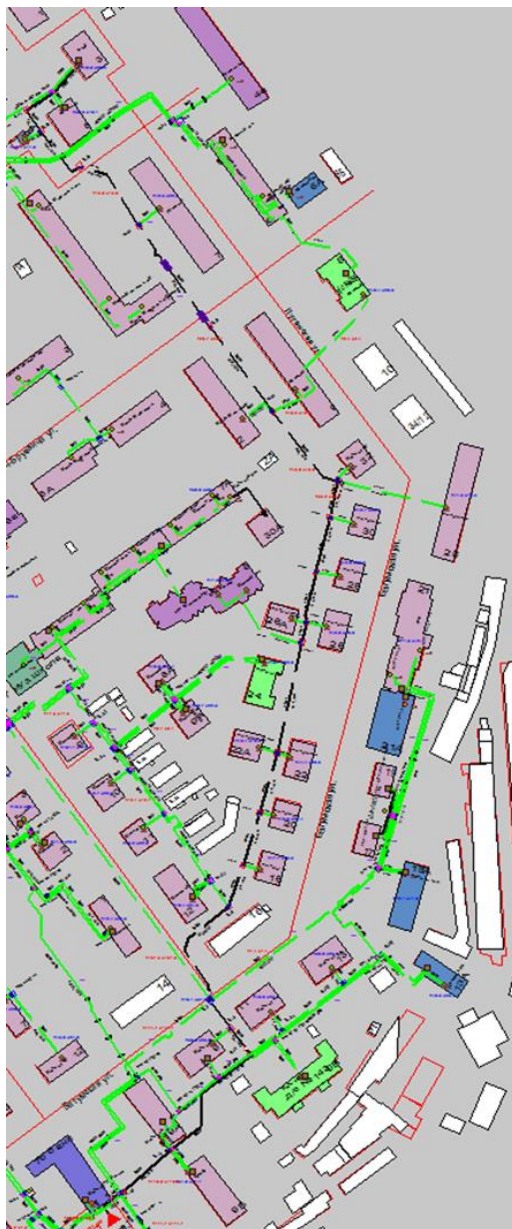
Рисунок Ошибка! Текст указанного стиля в документе отсутствует..107 Результат гидравлического расчета - расчетный путь теплоносителя от котельной ул. Углова, 7 до ПТ-Луган,3
