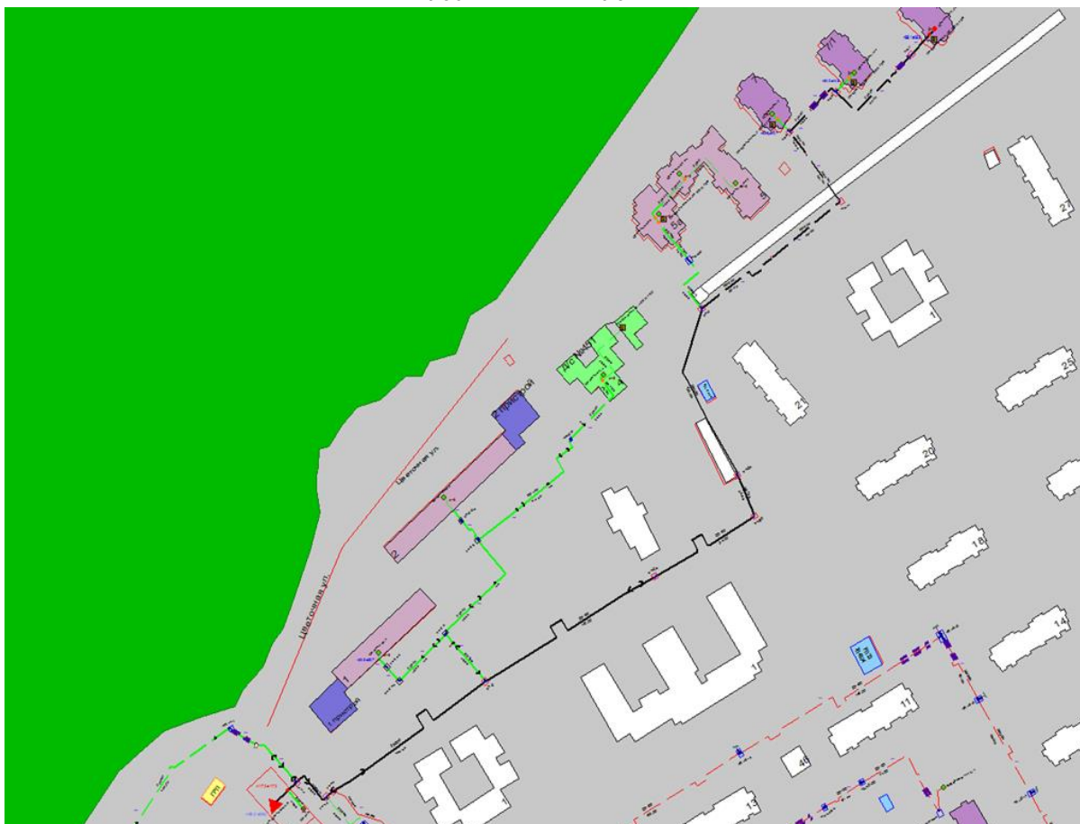
Рисунок Ошибка! Текст указанного стиля в документе отсутствует..47 Результат гидравлического расчета - расчетный путь теплоносителя от котельной Цветочная, 3-а до ПТ-Цветочная,7/2
