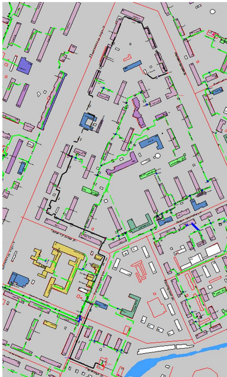
Рисунок Ошибка! Текст указанного стиля в документе отсутствует..13 Результат гидравлического расчета - расчетный путь теплоносителя от котельной Геройская, 11-а до ПТ-пр. Ленина, 38а
