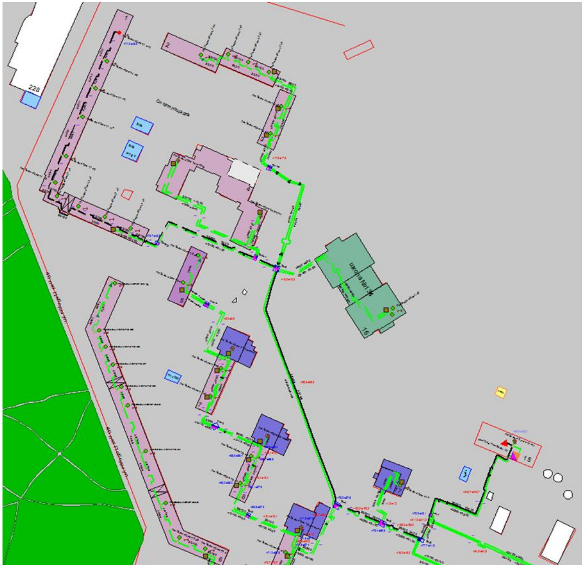
Рисунок Ошибка! Текст указанного стиля в документе отсутствует..43 Результат гидравлического расчета - расчетный путь теплоносителя от котельной 40 лет Победы, 15 до ПТ-Победы 40лет,1 з10
