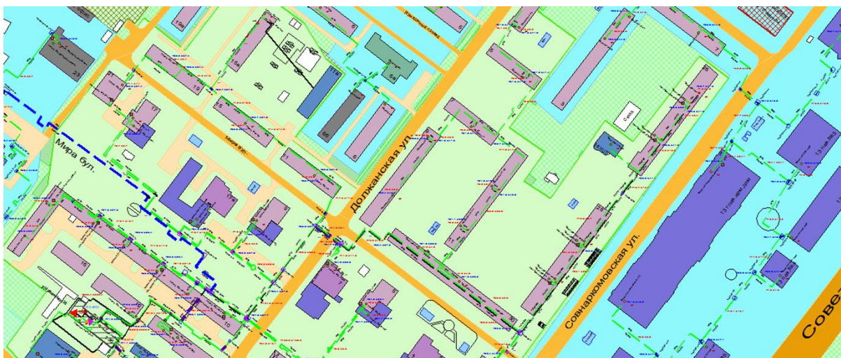
Рисунок 1.207 Результат гидравлического расчета - расчетный путь теплоносителя от котельной Мурашкинская, 136 до ПТ-Совн, 26 маг
