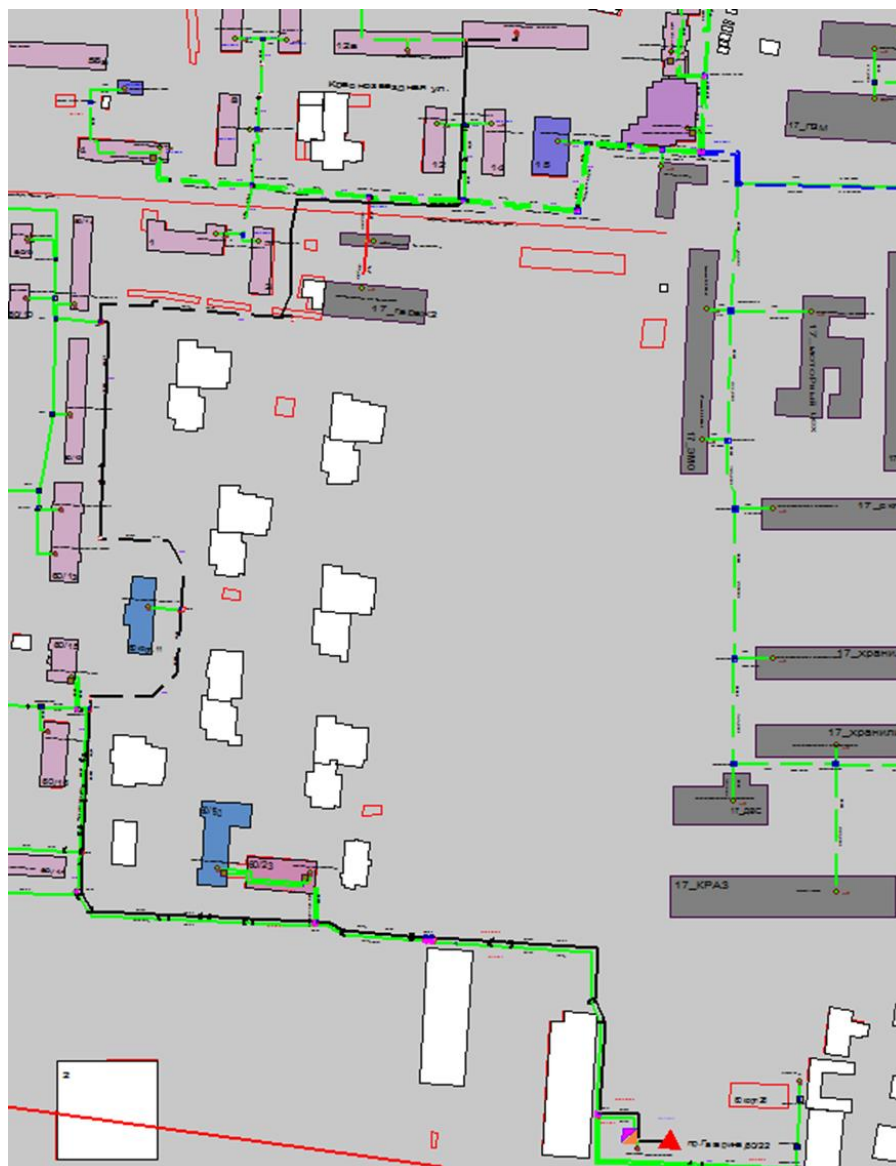
Рисунок Ошибка! Текст указанного стиля в документе отсутствует..57 Результат гидравлического расчета - расчетный путь теплоносителя от котельной Гагарина, 60 корп. 22 до ПТ-Краснозв,12а вв2
