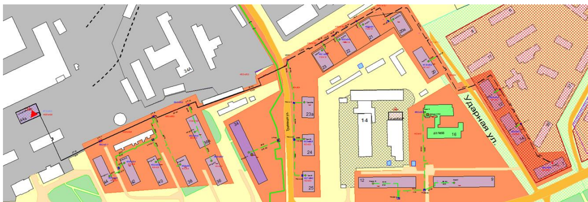
Рисунок Ошибка! Текст указанного стиля в документе отсутствует..91 Результат гидравлического расчета - расчетный путь теплоносителя от котельной Федосеенко, 44а до ПТ-Федос,7
