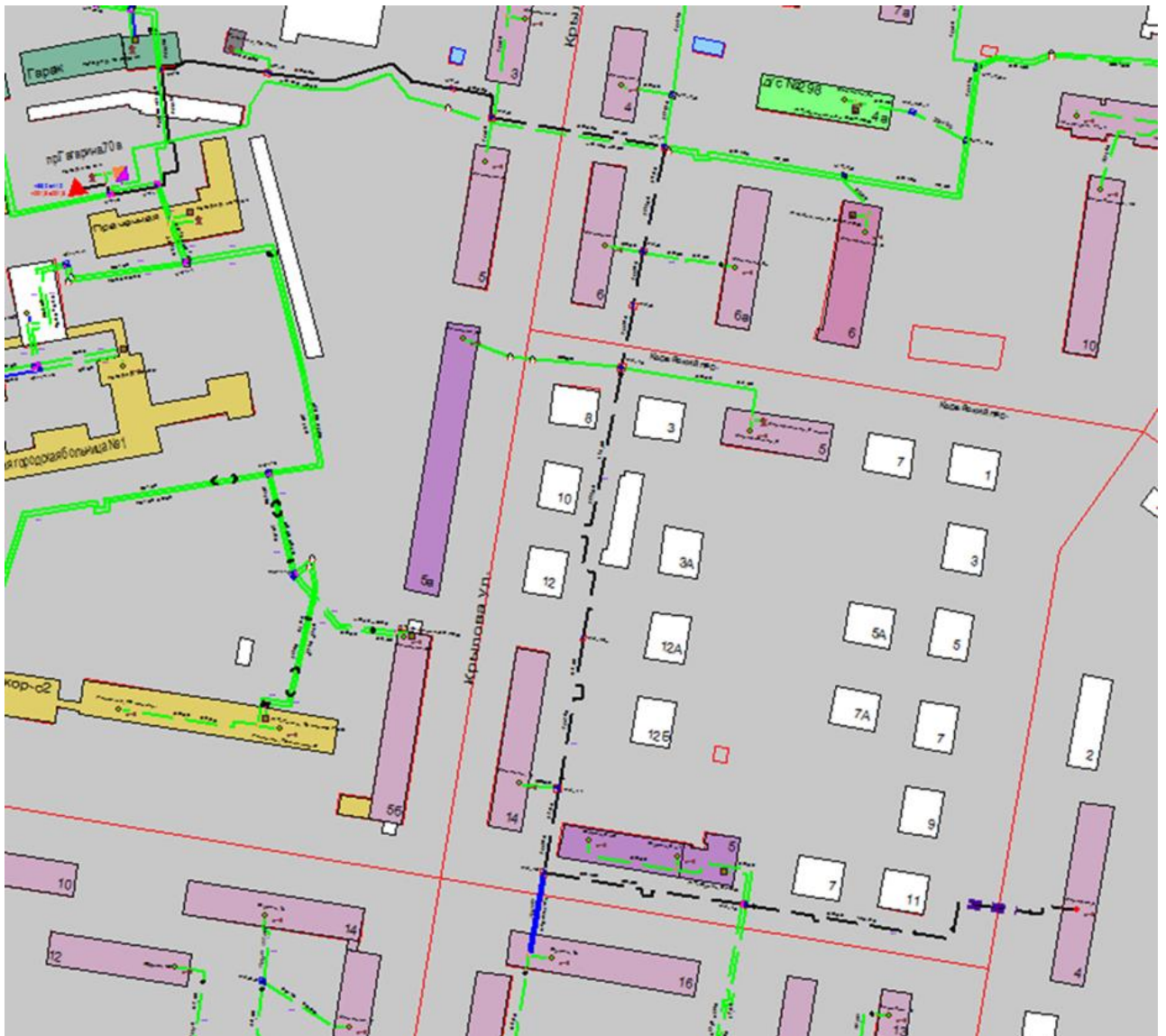
Рисунок 3.65 – Трассировка теплопровода от котельной АО «Теплоэнерго» «Медицинская академия» по пр. Гагарина, д. 70А до конечного потребителя «ПТ-Корейск,4»
