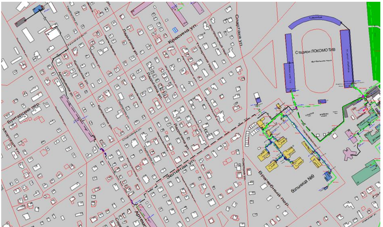
Рисунок 3.59 – Трассировка теплопровода от котельной АО «Теплоэнерго» по ул. Климовская, д. 86А до конечного потребителя «ПТ-Клим,3»
