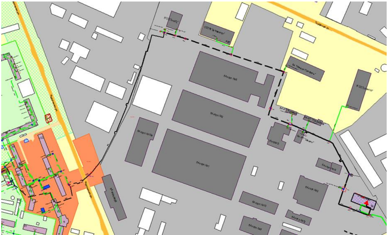
Рисунок Ошибка! Текст указанного стиля в документе отсутствует..113 – Трассировка теплопровода от котельной ФГУП «Завод Электромаш» по ул. Федосеенко, д. 64 до конечного потребителя «ЦТП-ул.Федосеен,89а»
