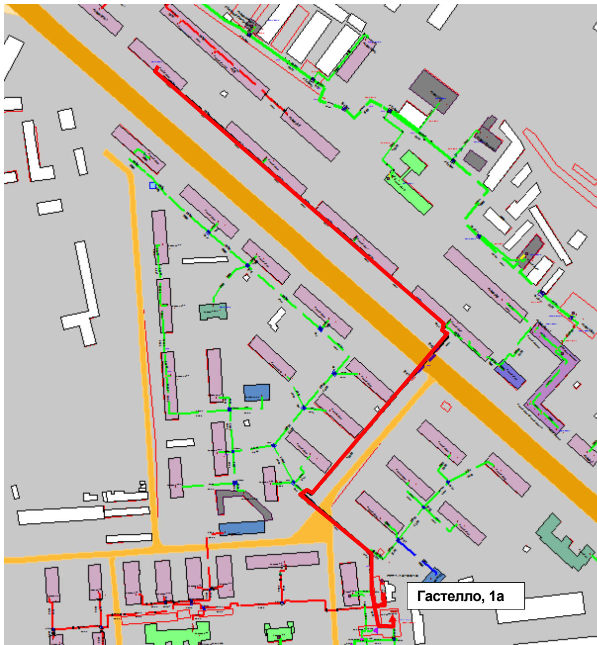
Рисунок Ошибка! Текст указанного стиля в документе отсутствует..12 – Результат гидравлического расчета - расчетный путь теплоносителя от котельной Гаселло, 1а до ПТ-Героев пр,39
