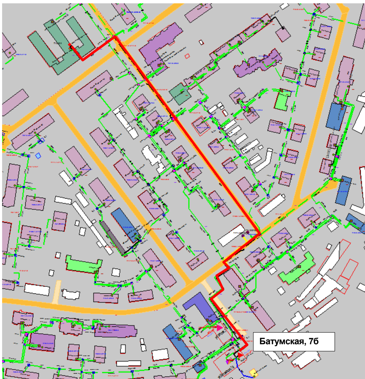
Рисунок Ошибка! Текст указанного стиля в документе отсутствует..16 – Результат гидравлического расчета - расчетный путь теплоносителя от котельной Батумская, 76 до ПТ-ПП-2.94-2016
