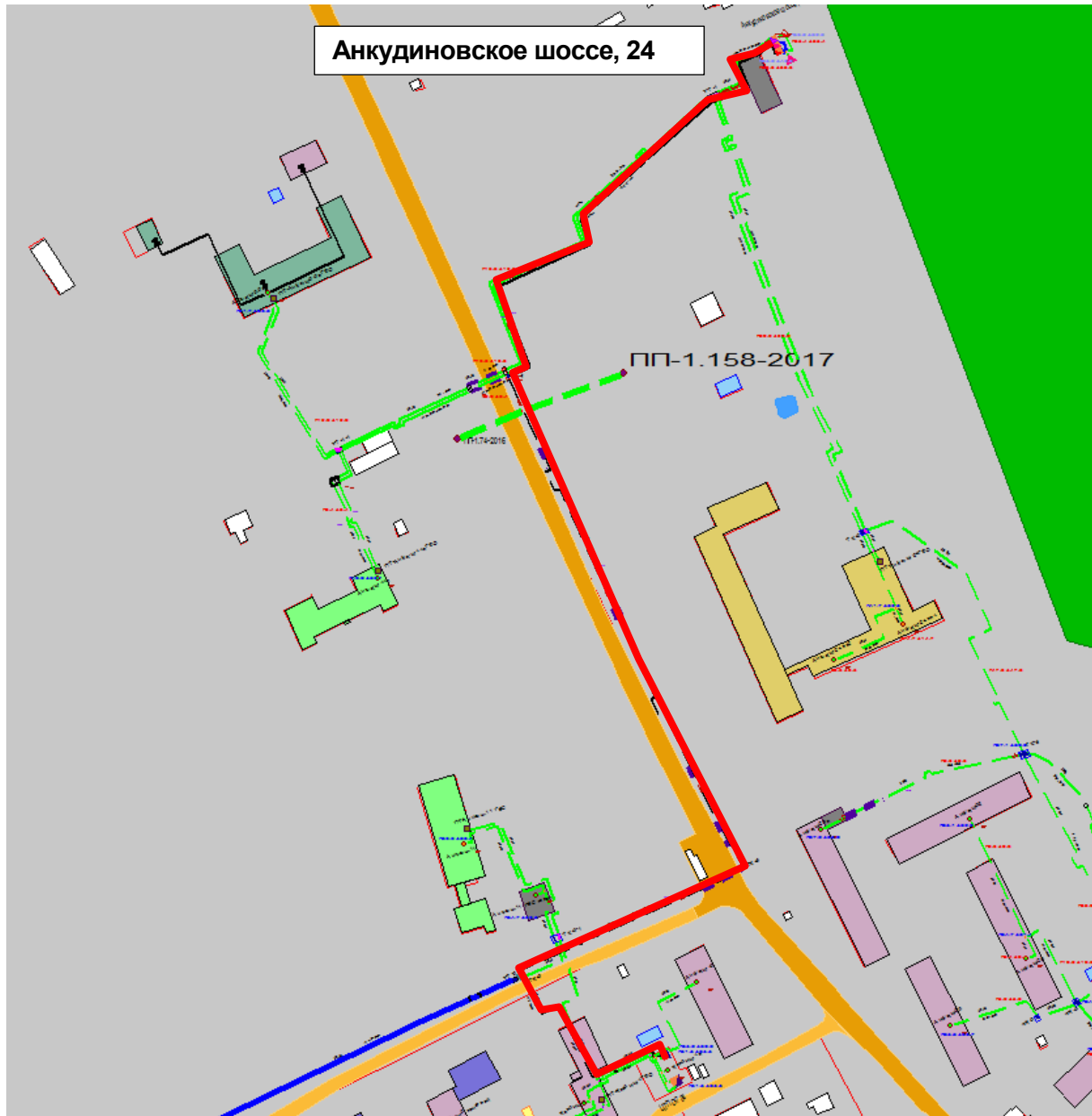
Рисунок Ошибка! Текст указанного стиля в документе отсутствует..54 – Результат гидравлического расчета - расчетный путь теплоносителя от котельной Анкудиновское шоссе, 24 до ЦТП-704 ВВП от
