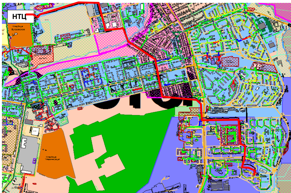
Рисунок 3.33 – Результат гидравлического расчета - расчетный путь теплоносителя от котельной НТЦ до ПТ-Малин,2 пристрой
