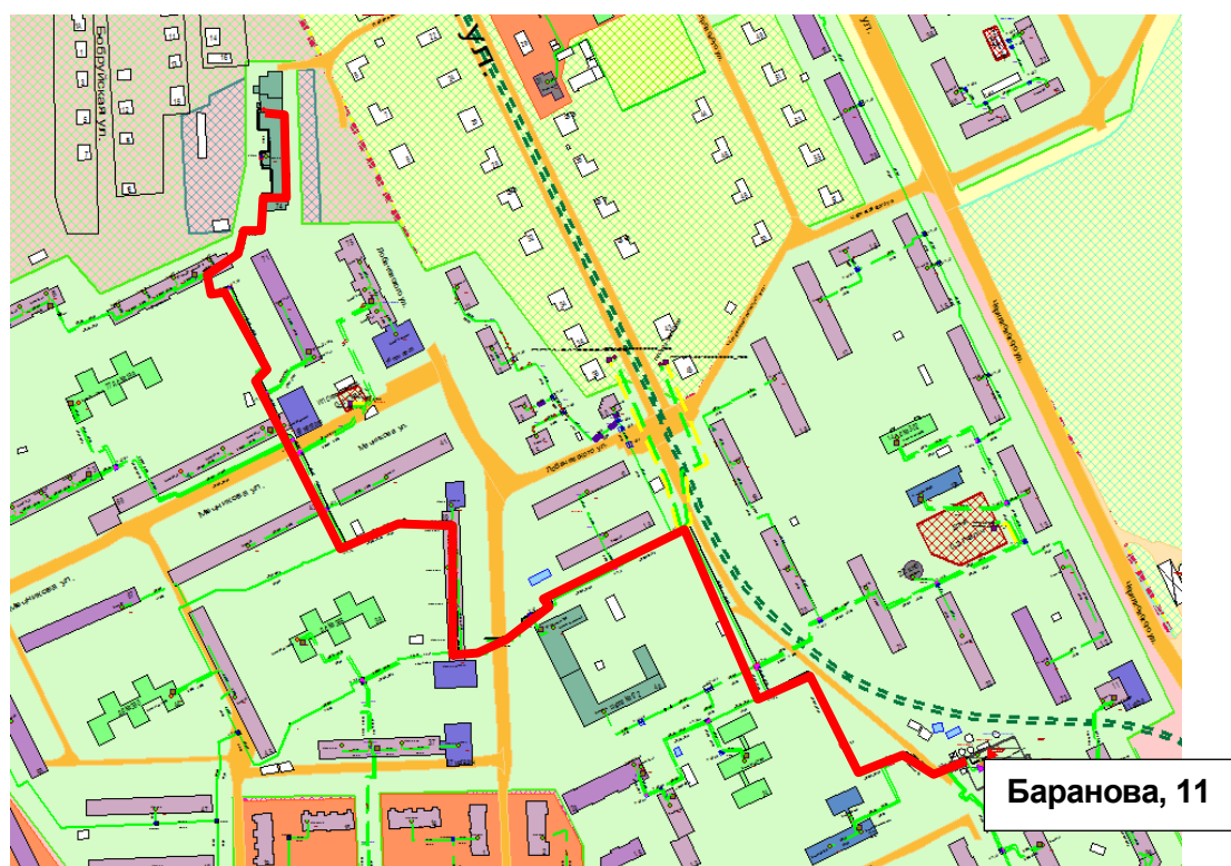
Рисунок 3.25 – Результат гидравлического расчета - расчетный путь теплоносителя от котельной Баранова, 11 до ПТ-Мечн, 74 маст
