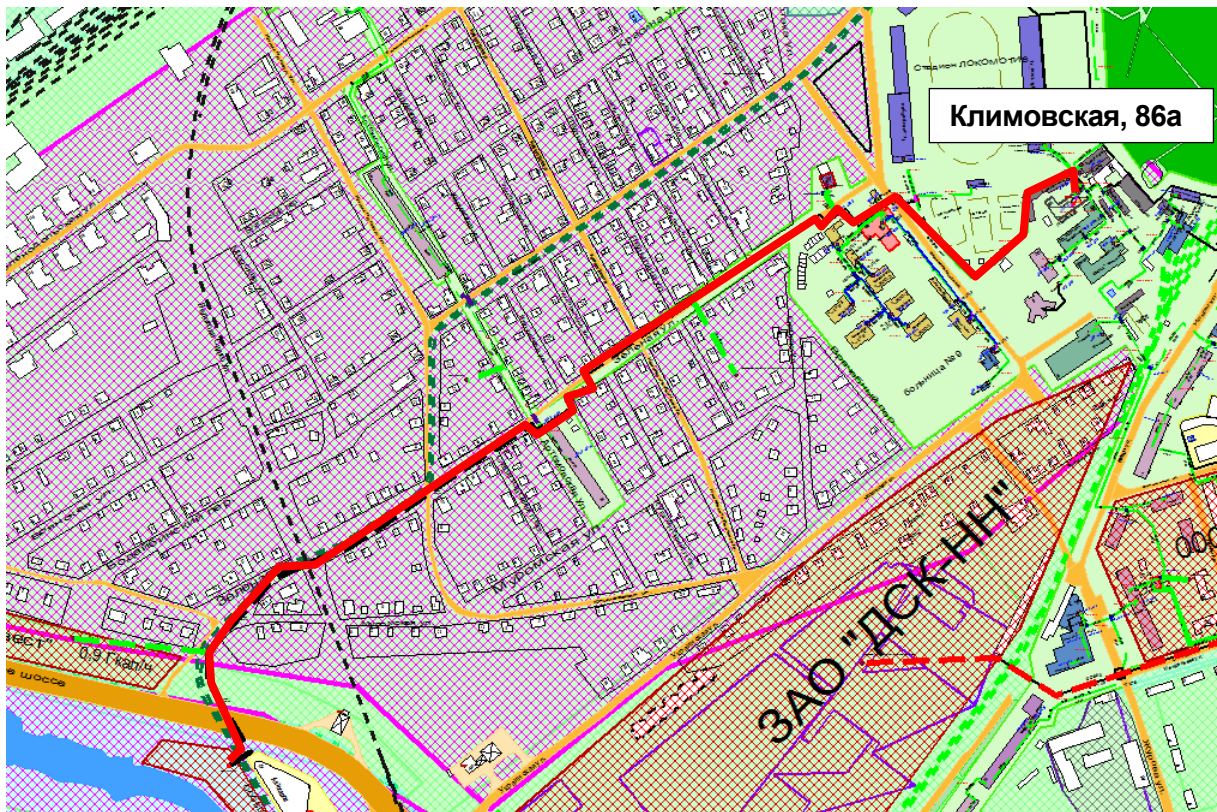
Рисунок 3.31 – Результат гидравлического расчета - расчетный путь теплоносителя от котельной Климовская, 86а до ПТ-ПП-2.227-2016
