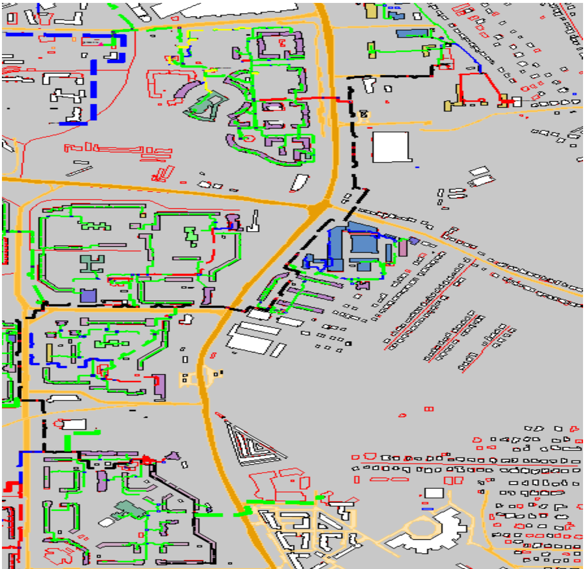
Рисунок 3.53 – Результат гидравлического расчета - расчетный путь теплоносителя от котельной ул. Родионова, 1946 до ПТ-Богдан.1 пр.
