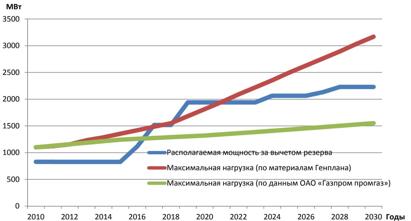
Рисунок 14 - Динамика изменения электрической нагрузки и мощности города Нижний Новгород (вариант 4)
