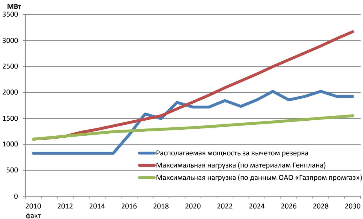
Рисунок 10 - График изменения электрической нагрузки и мощности города Нижний Новгород на перспективу до 2030 года по варианту 2.
