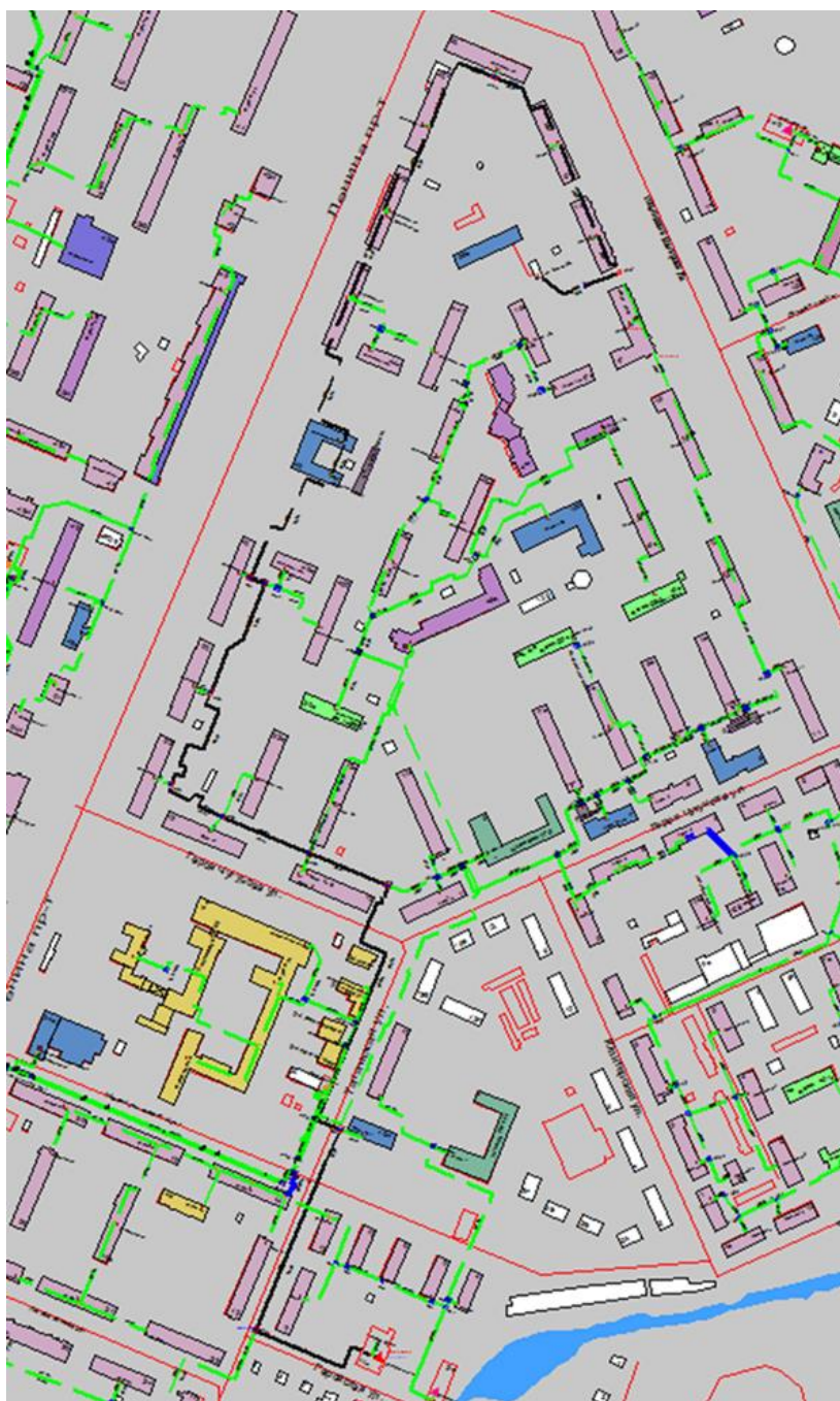
Рисунок 3.97 – Трассировка теплопровода от котельной АО «Теплоэнерго» по ул. Геройская, д. 11А до конечного потребителя «ПТ-пр.Ленина,38а»
