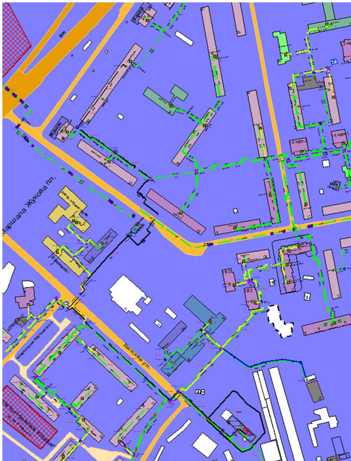
Рисунок 3.111 – Трассировка теплопровода от котельной АО «Теплоэнерго» «Вятская» по ул. Голованова, д. 25А до конечного потребителя «ПТ-Гагар.пр,184 э2»
