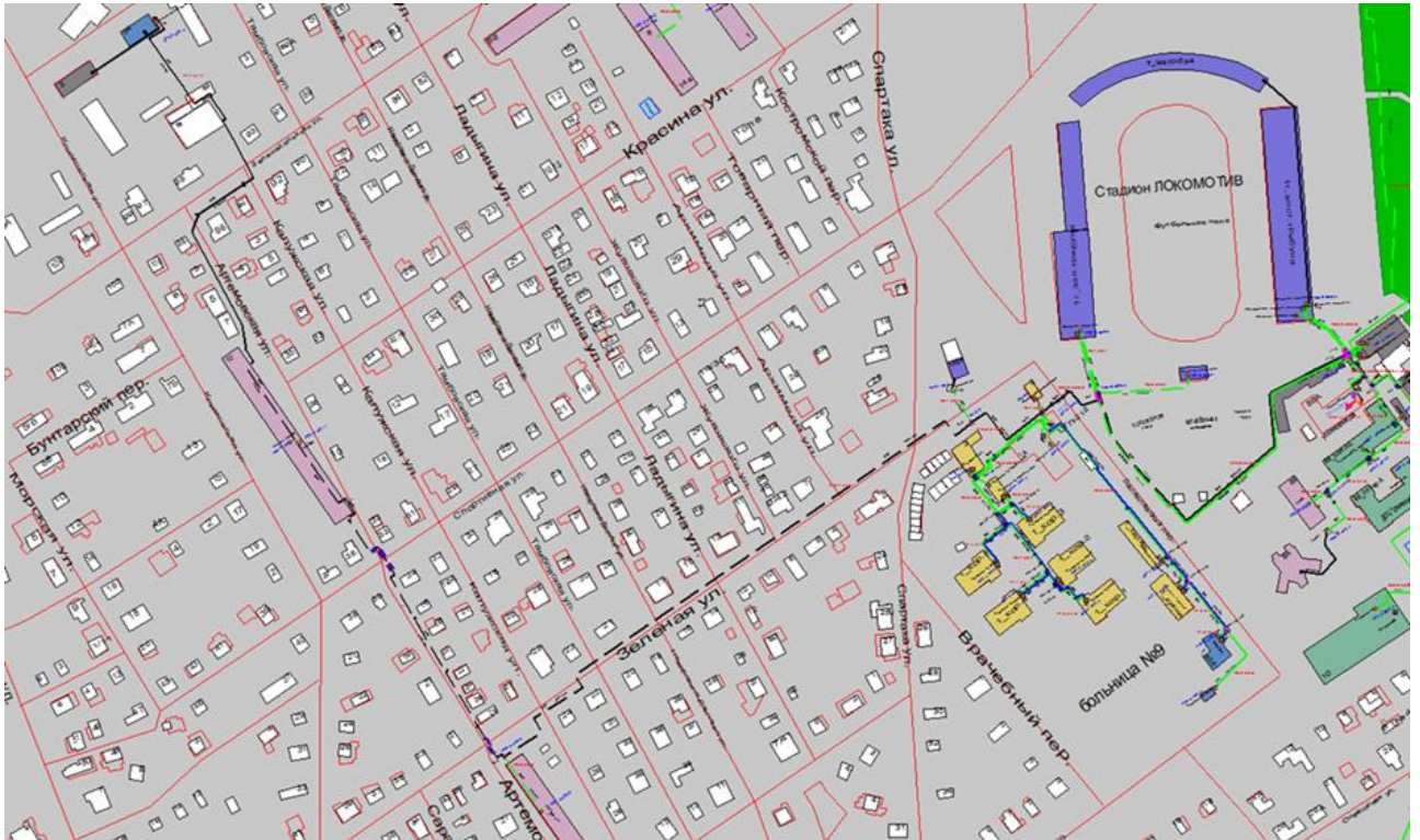
Рисунок 3.43 – Трассировка теплопровода от котельной АО «Теплоэнерго» по ул. Климовская, д. 86А до конечного потребителя «ПТ-Клим,3»
