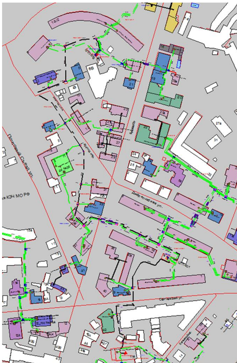
Рисунок 3.101 – Трассировка теплопровода от котельной АО «Теплоэнерго» по пер. Плотничный, д. 11 до конечного потребителя «ЦТП-602»
