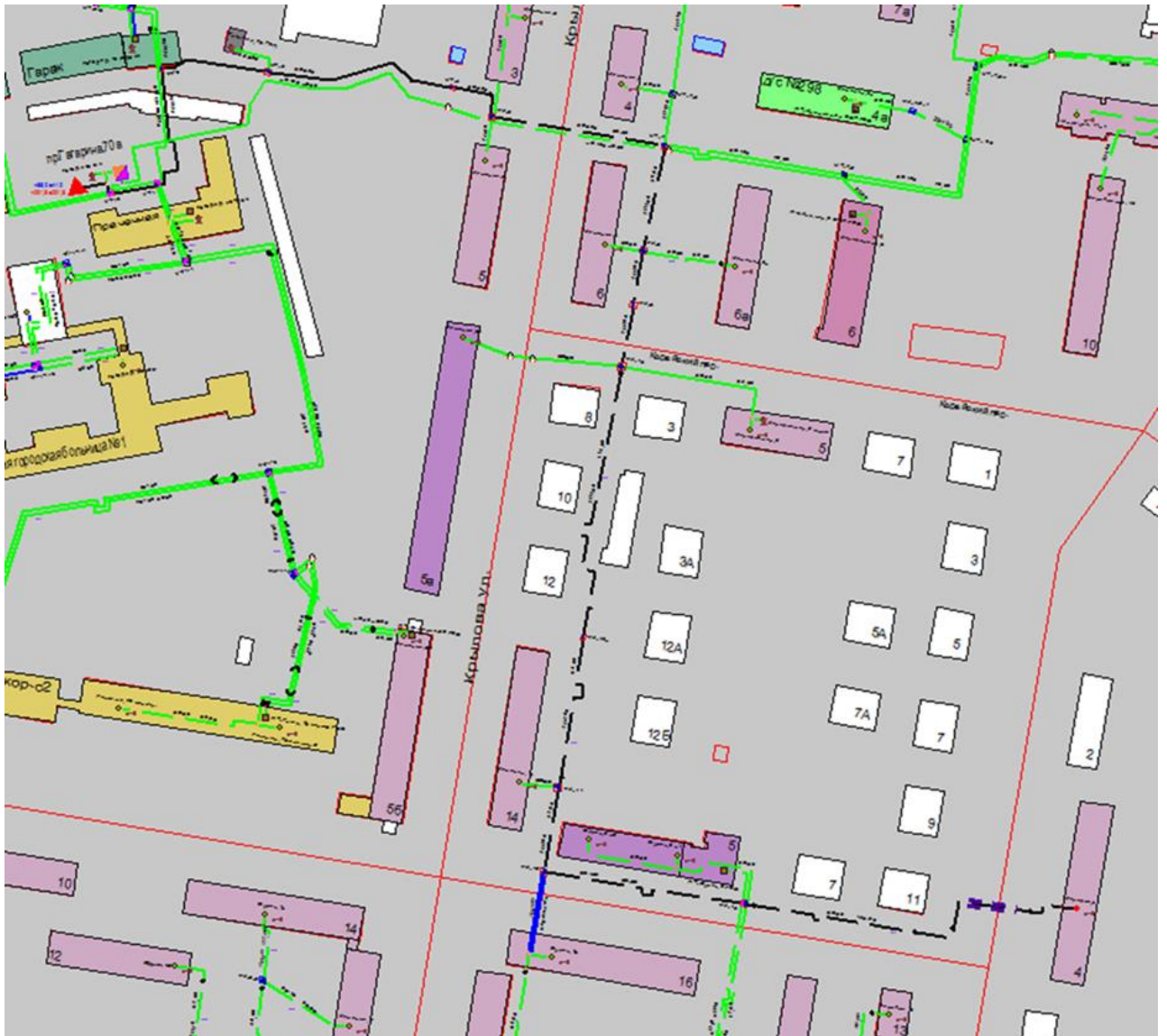
Рисунок 3.45 – Трассировка теплопровода от котельной АО «Теплоэнерго» «Медицинская академия» по пр. Гагарина, д. 70А до конечного потребителя «ПТ-Корейск,4»
