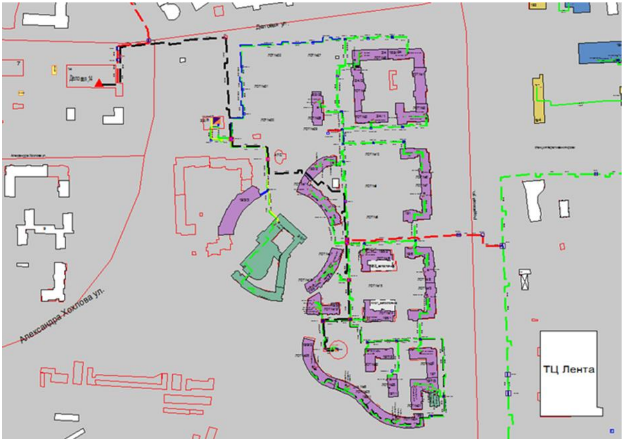
Рисунок 3.133 – Трассировка теплопровода от котельной ООО «Нижновтеплоэнерго» по ул. Деловая, д. 14 до конечного потребителя «ПТ-Род.197/2_н»
