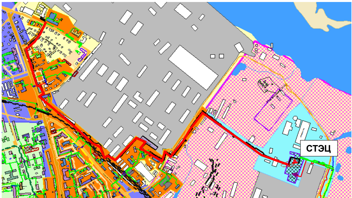
Рисунок 3.7- Результат гидравлического расчета - расчетный путь теплоносителя от СТЭЦ до ПТ-ПП-2.23-2016
