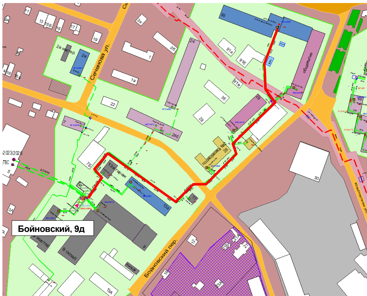
Рисунок 3.13 – Результат гидравлического расчета - расчетный путь теплоносителя от Бойновский, 9д до ПТ-Б.Печер, 93 МВД
