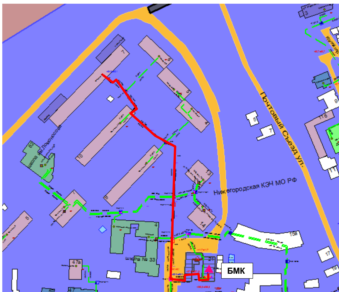
Рисунок 3.11 – Результат гидравлического расчета - расчетный путь теплоносителя от котельной Суетинская, 21 до ПТ-Федор,7
