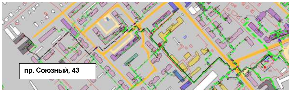
Рисунок 2.75 – Результат гидравлического расчета - расчетный путь теплоносителя от котельной пр. Союзный, 43 до ПТ-Комин, 256 э2
