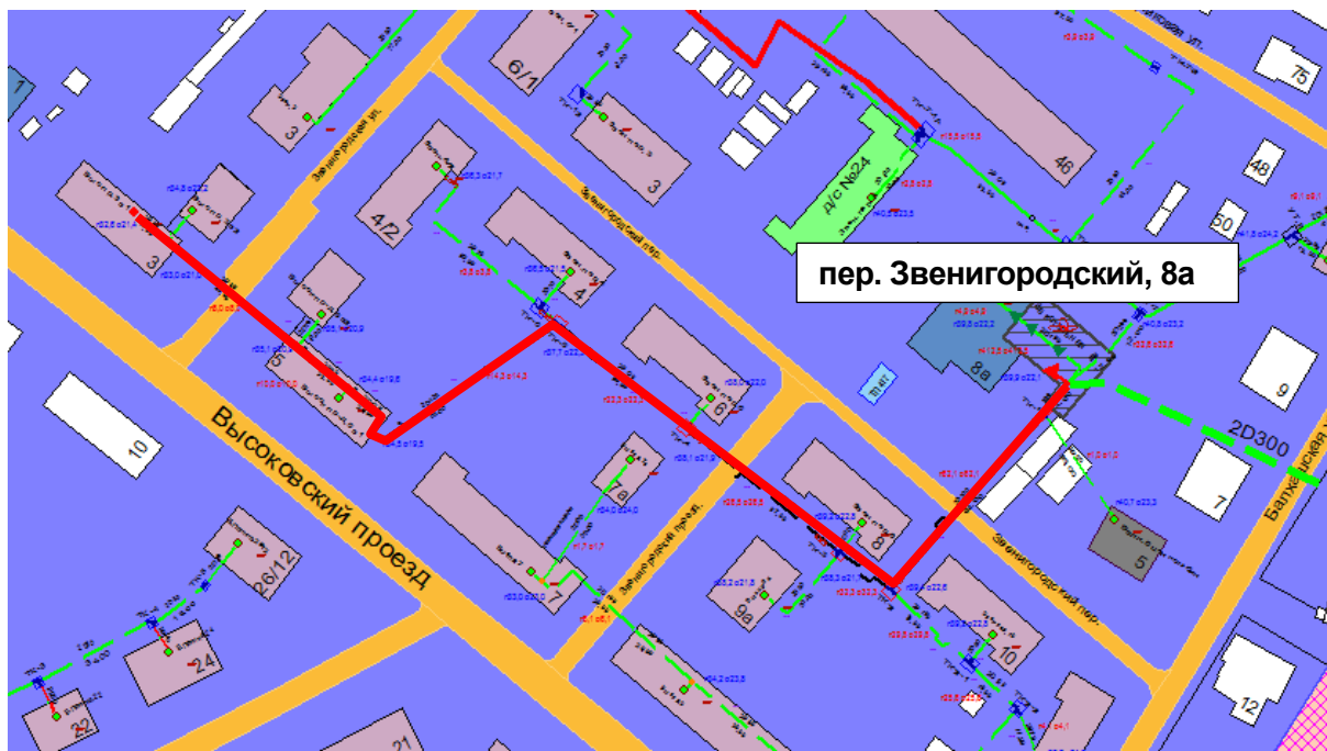
Рисунок 2.51 – Результат гидравлического расчета - расчетный путь теплоносителя от котельной пер. Звенигородский, 8а до ПТ-Выс.пр,3 в1
