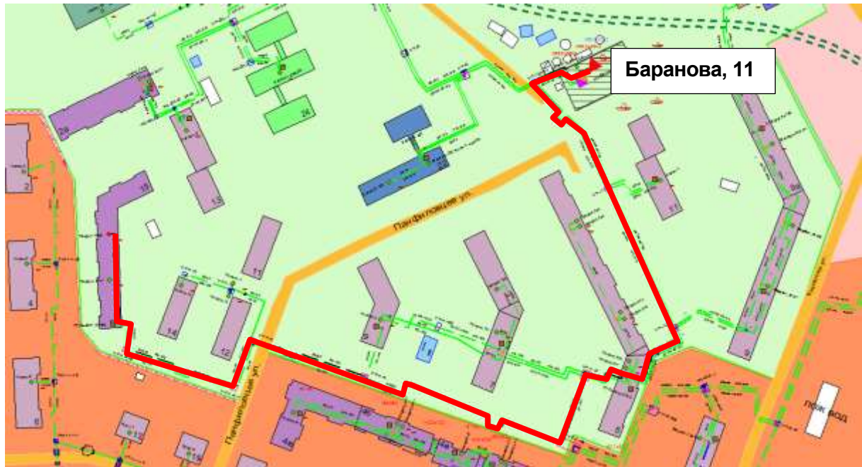
Рисунок 2.41 – Результат гидравлического расчета - расчетный путь теплоносителя от котельной Баранова, 11 до ПТ-Панфил,15 э2
