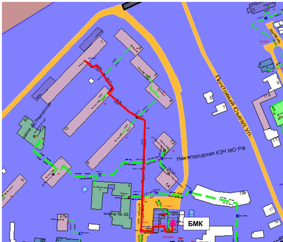
Рисунок 2.11 – Результат гидравлического расчета - расчетный путь теплоносителя от от котельной Суетинская, 21 до ПТ-Федор,7
