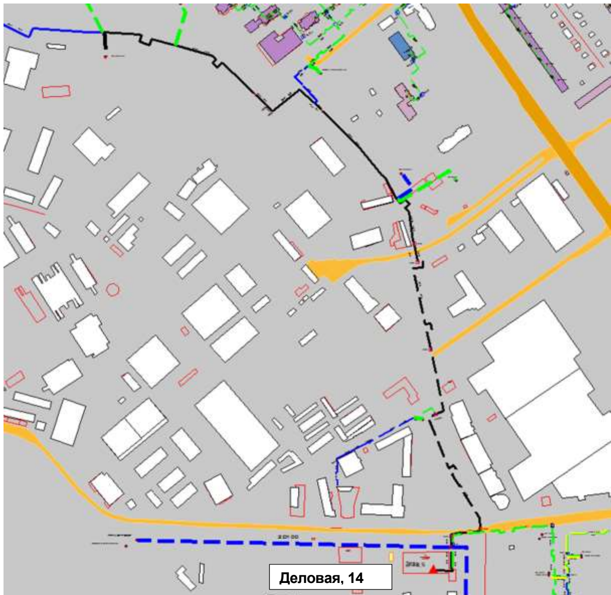
Рисунок 2.29 – Результат гидравлического расчета - расчетный путь теплоносителя от котельной Деловая, 14 до ПТ-ПП-2.99-2017-2018
