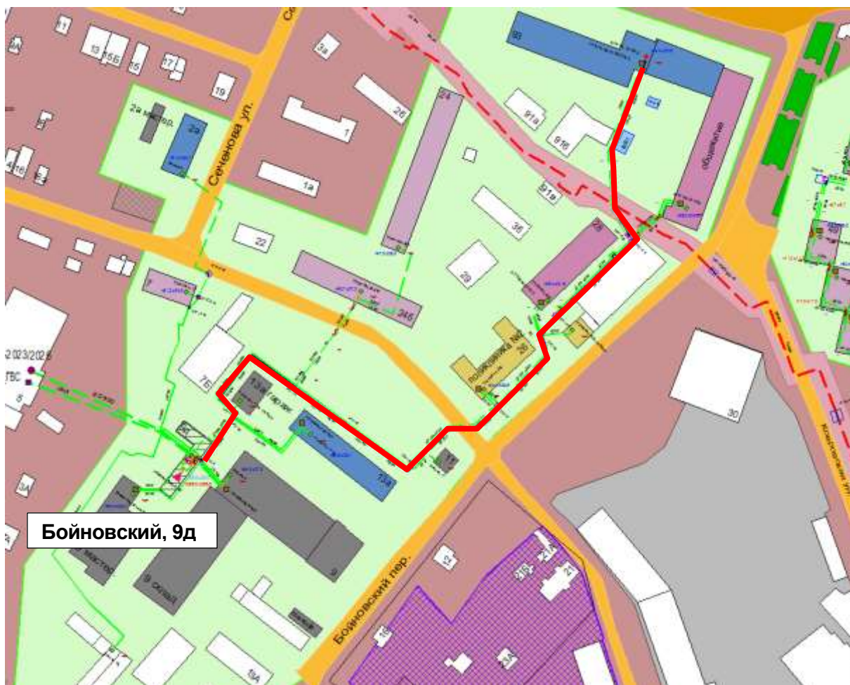
Рисунок 2.23 – Результат гидравлического расчета - расчетный путь теплоносителя от Бойновский, 9д до ПТ-Б.Печер, 93 МВт
