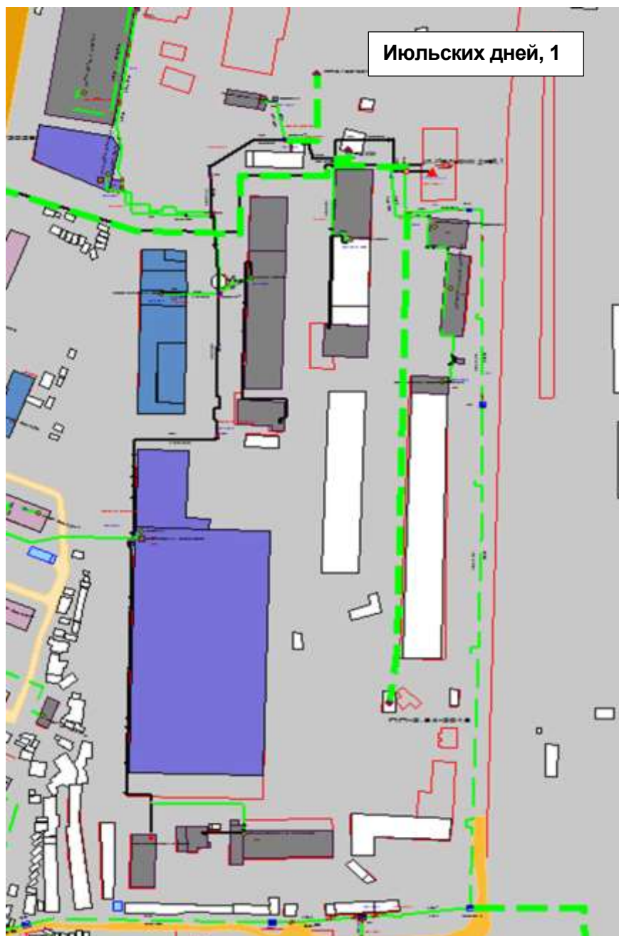
Рисунок 2.33 – Результат гидравлического расчета - расчетный путь теплоносителя от Июльских дней, 1 до ПТ-Деревооб, 1а АБК
