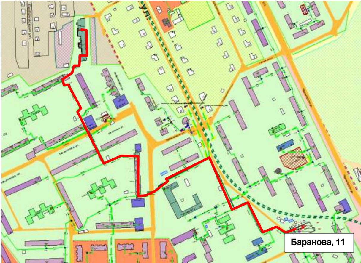
Рисунок 2.39 – Результат гидравлического расчета - расчетный путь теплоносителя от котельной Баранова, 11 до ПТ-Мечн,74 мasts
