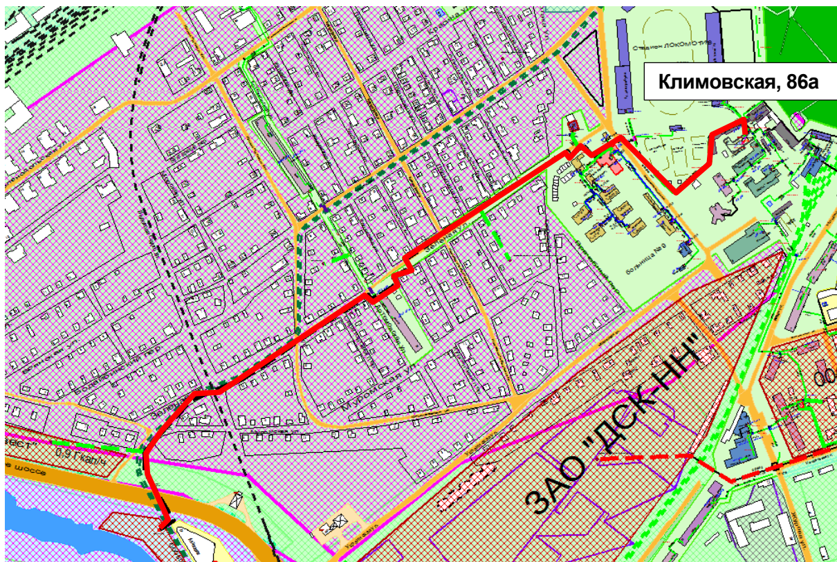
Рисунок 2.45 – Результат гидравлического расчета - расчетный путь теплоносителя от котельной Климовская, 86а до ПТ-ПП-2.227-2016
