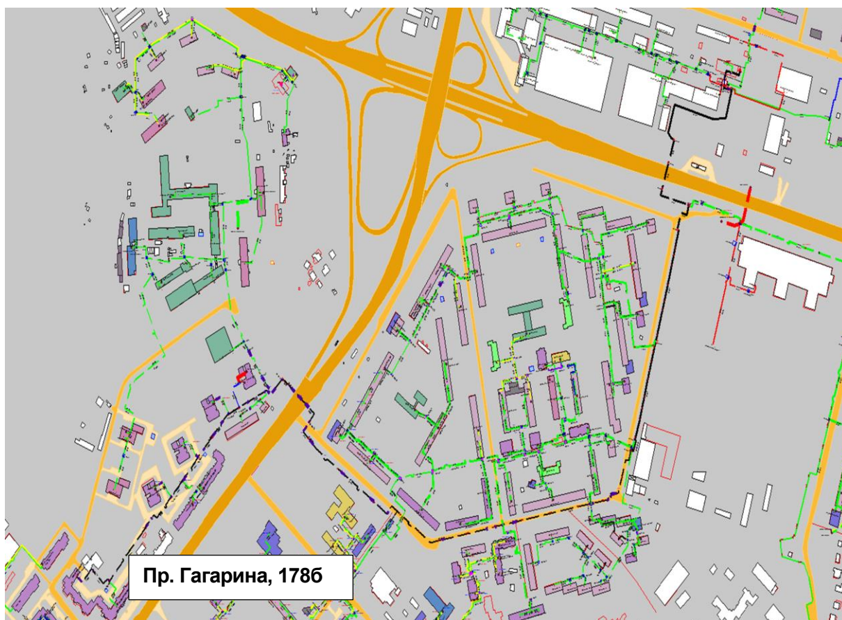
Рисунок 2.69 – Результат гидравлического расчета - расчетный путь теплоносителя от котельной пр. Гагарина, 1786 до ПТ-Гагар.пр.101/5 ИТП №2.
