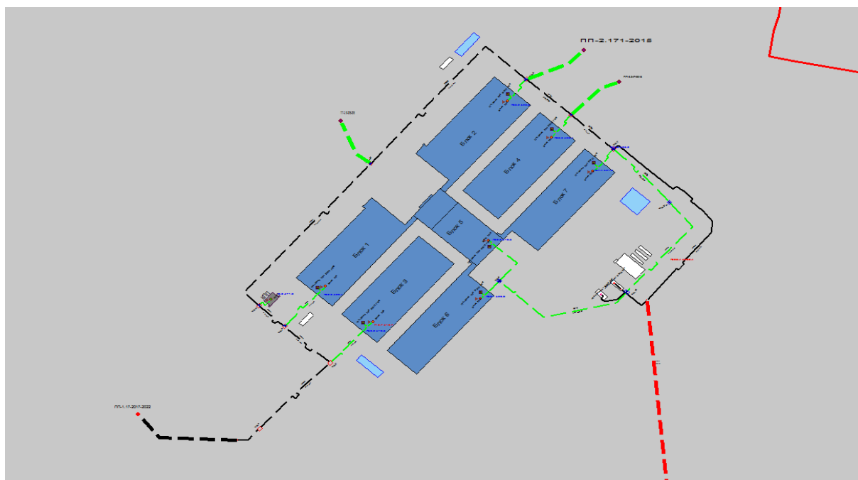
Рисунок 2.81 – Результат гидравлического расчета - расчетный путь теплоносителя от котельной «СБЕРБАНК» БМК №1 до ПТ-ПП-1,17-2017-2022.
