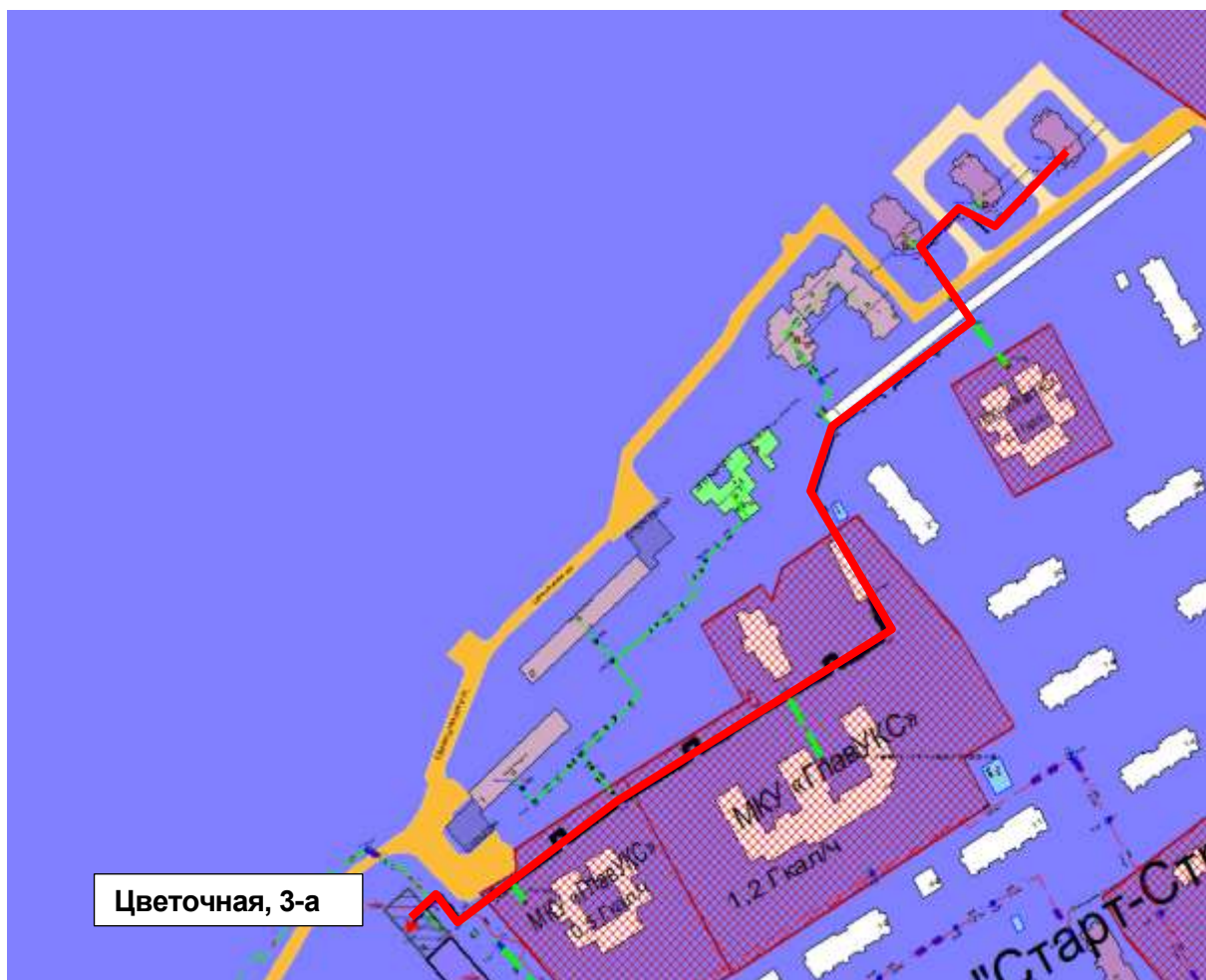
Рисунок Ошибка! Текст указанного стиля в документе отсутствует..84 – Результат гидравлического расчета - расчетный путь теплоносителя от котельной Цветочная, 3-а до ПТ-Цветочная,7/2
