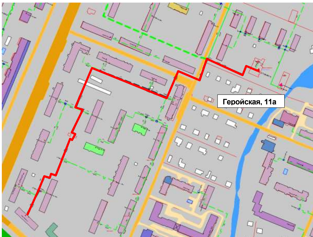
Рисунок Ошибка! Текст указанного стиля в документе отсутствует..20 – Результат гидравлического расчета - расчетный путь теплоносителя от котельной Геройская, 11а до ПТ-Адм.Нахим, 4
