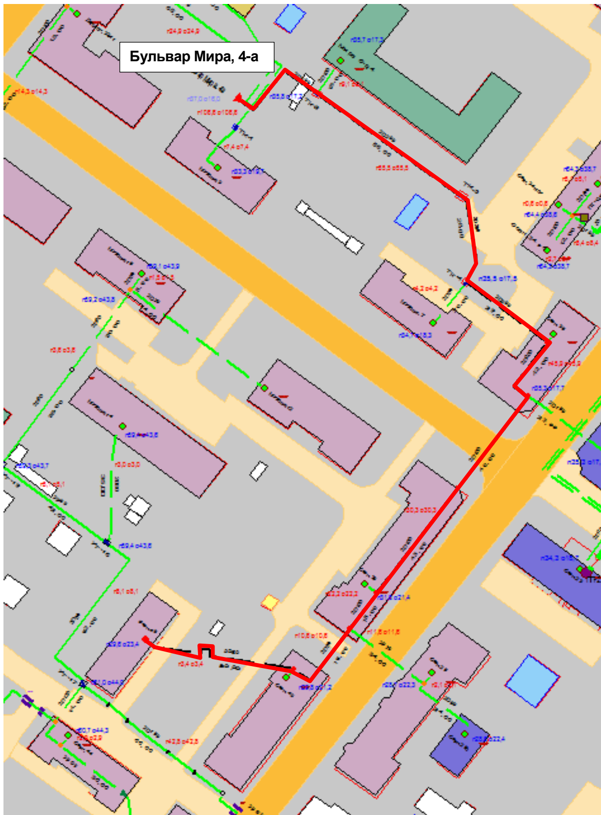
Рисунок Ошибка! Текст указанного стиля в документе отсутствует..30 – Результат гидравлического расчета - расчетный путь теплоносителя от котельной Бульвар Мира, 4-а до ПТ-Совн,46
