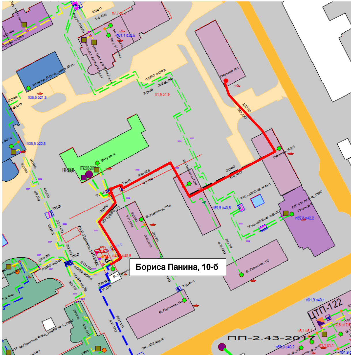
Рисунок Ошибка! Текст указанного стиля в документе отсутствует..36 – Результат гидравлического расчета - расчетный путь теплоносителя от котельной Бориса Панина, 10-6 до ПТ-Полтава,51
