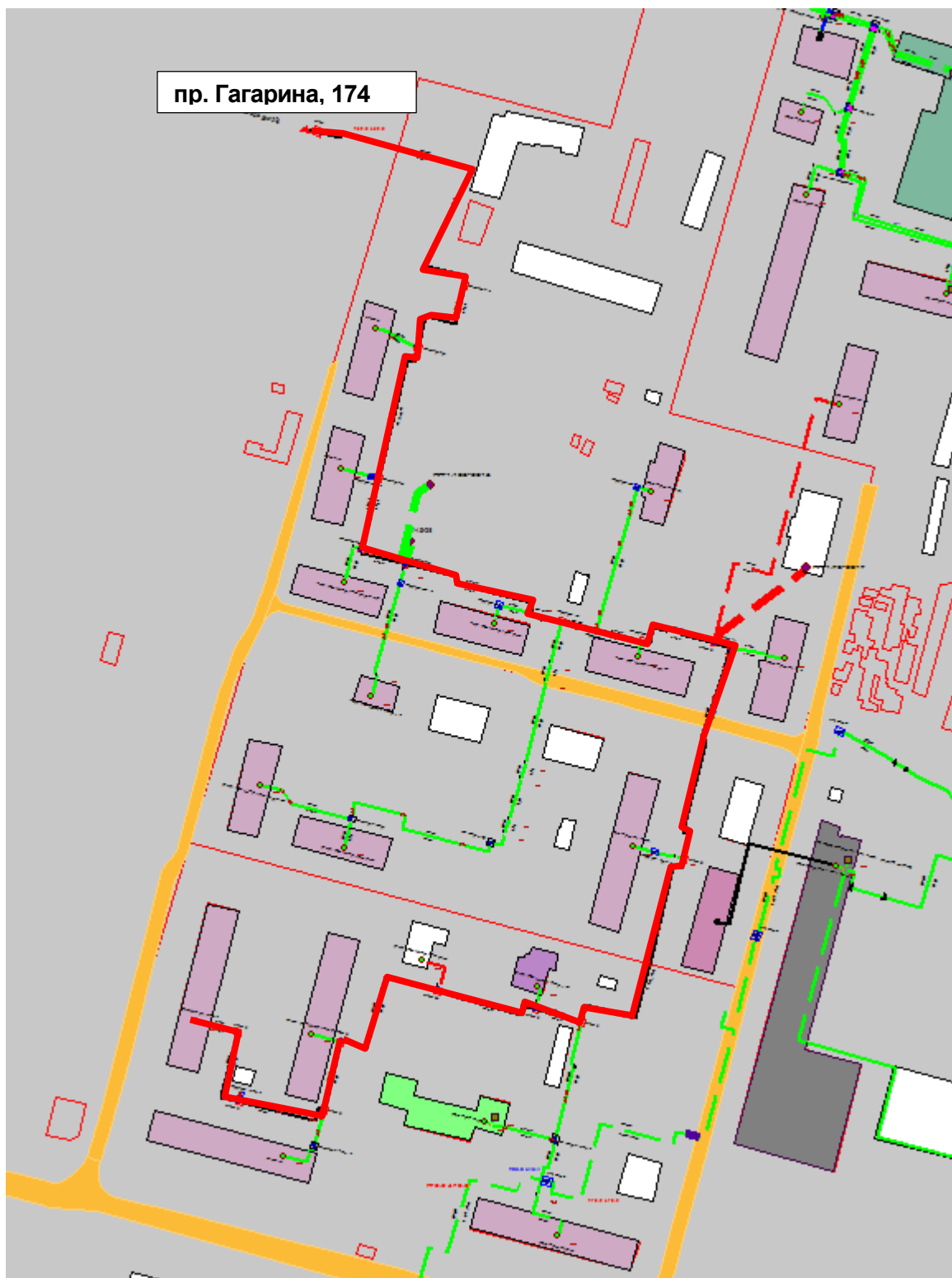
Рисунок Ошибка! Текст указанного стиля в документе отсутствует..26 – Результат гидравлического расчета - расчетный путь теплоносителя от котельной ОАО «ННПО имени М.В.Фрунзе» до ПТ-Кемер,16/1
