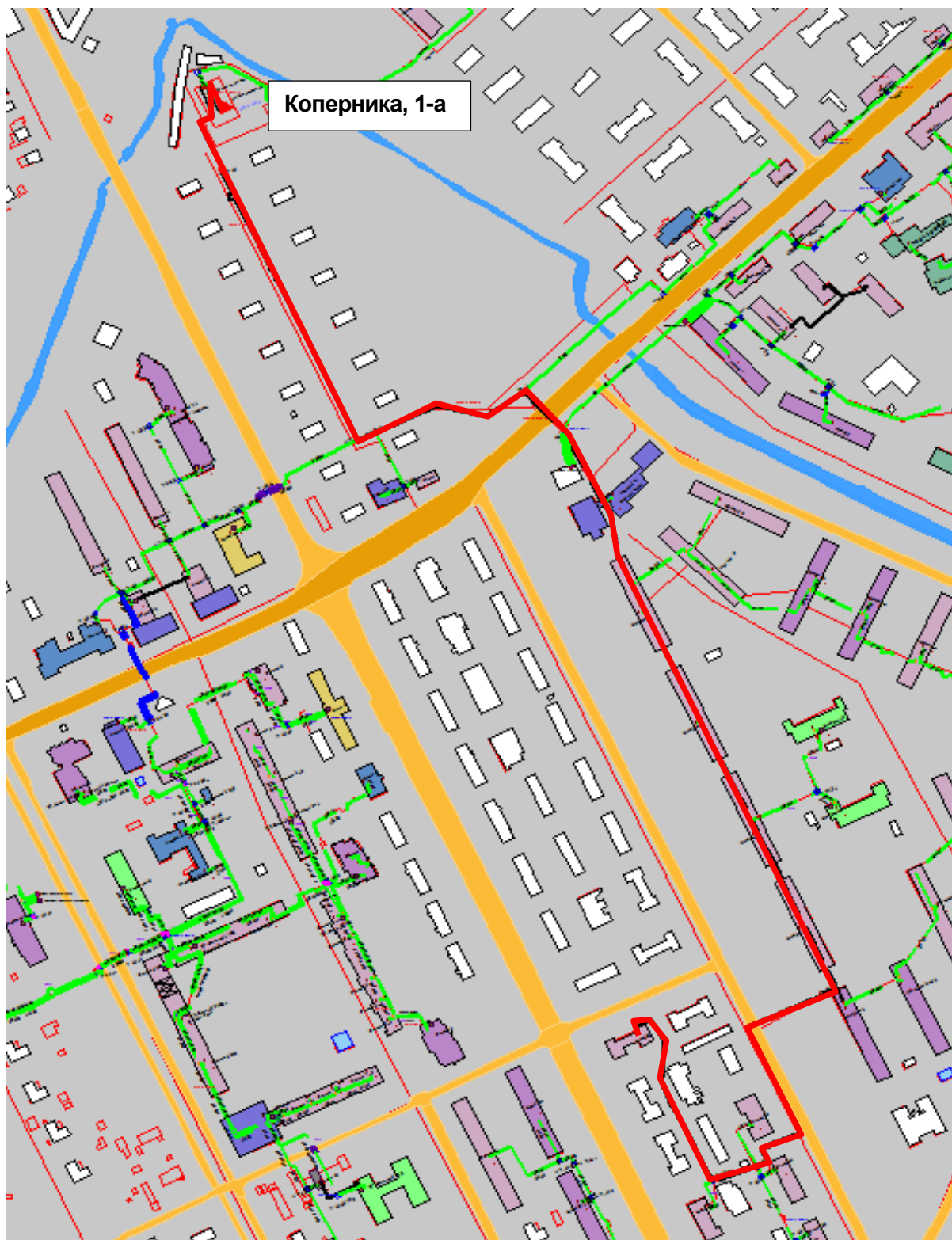
Рисунок Ошибка! Текст указанного стиля в документе отсутствует..80 – Результат гидравлического расчета - расчетный путь теплоносителя от котельной Коперника, 1-а до ПТ-Циол,32
