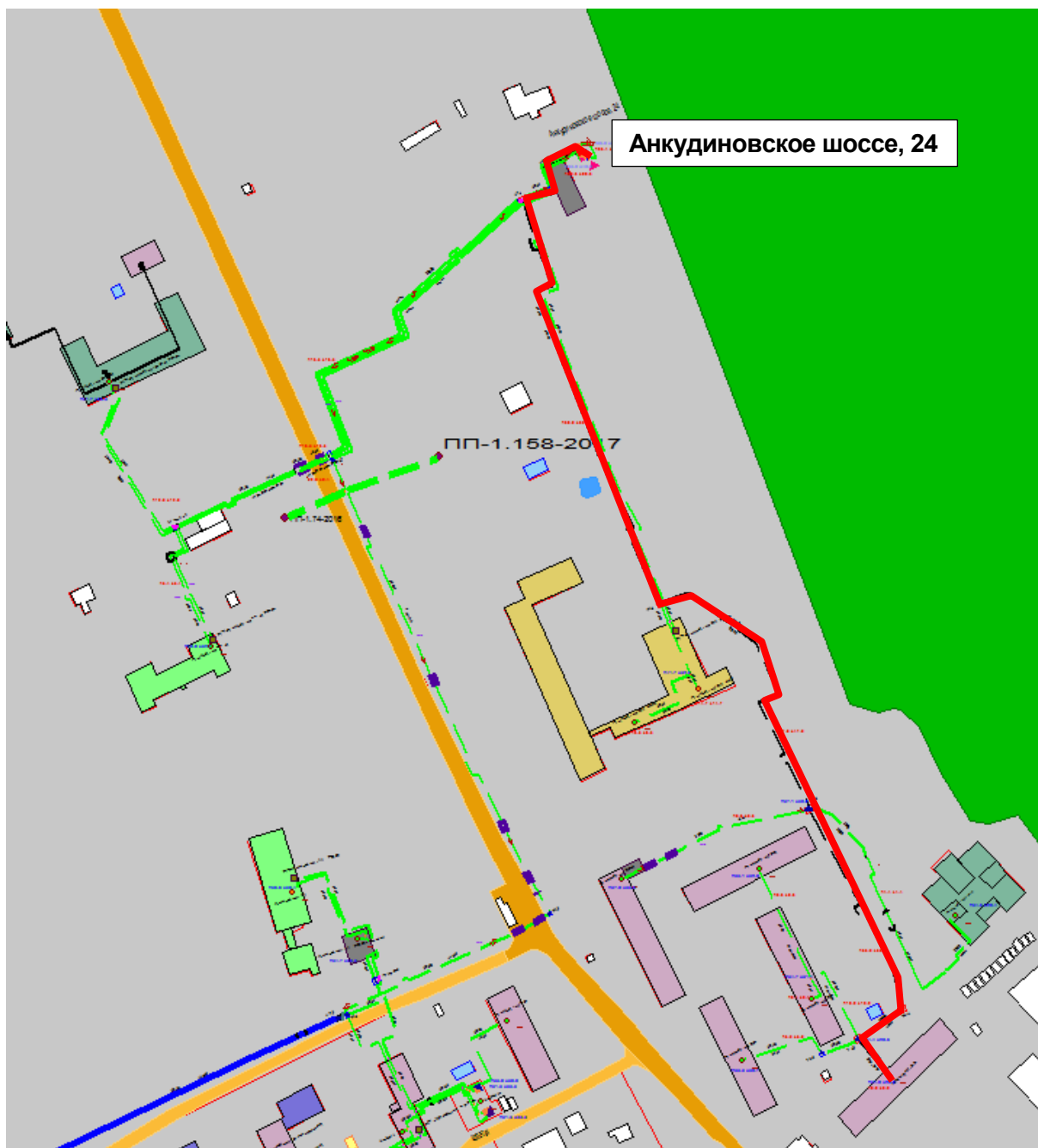
Рисунок Ошибка! Текст указанного стиля в документе отсутствует..52 – Результат гидравлического расчета - расчетный путь теплоносителя от котельной Анкудиновское шоссе, 24 до ПТ-Анкуд.ш,30
