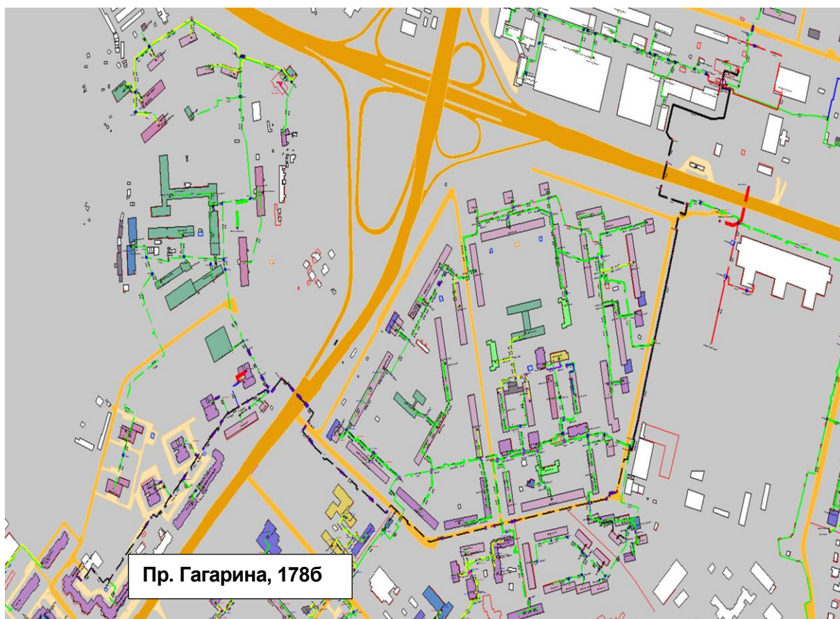
Рисунок 0.69 – Результат гидравлического расчета - расчетный путь теплоносителя от котельной пр. Гагарина, 1786 до ПТ-Гагар.пр.101/5 ИТП №2.
