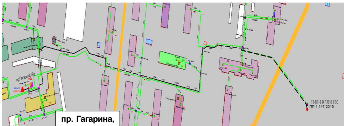
Рисунок 0.57 – Результат гидравлического расчета - расчетный путь теплоносителя от котельной пр. Гагарина, 70а до ПТ- ПП-1.147-2016
