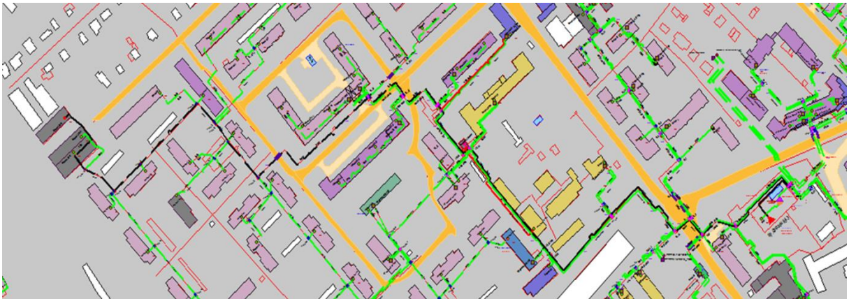
Рисунок 0.47 - Результат гидравлического расчета - расчетный путь теплоносителя от котельной пр . Союзный, 43 до ПТ-Комин,256 э2
