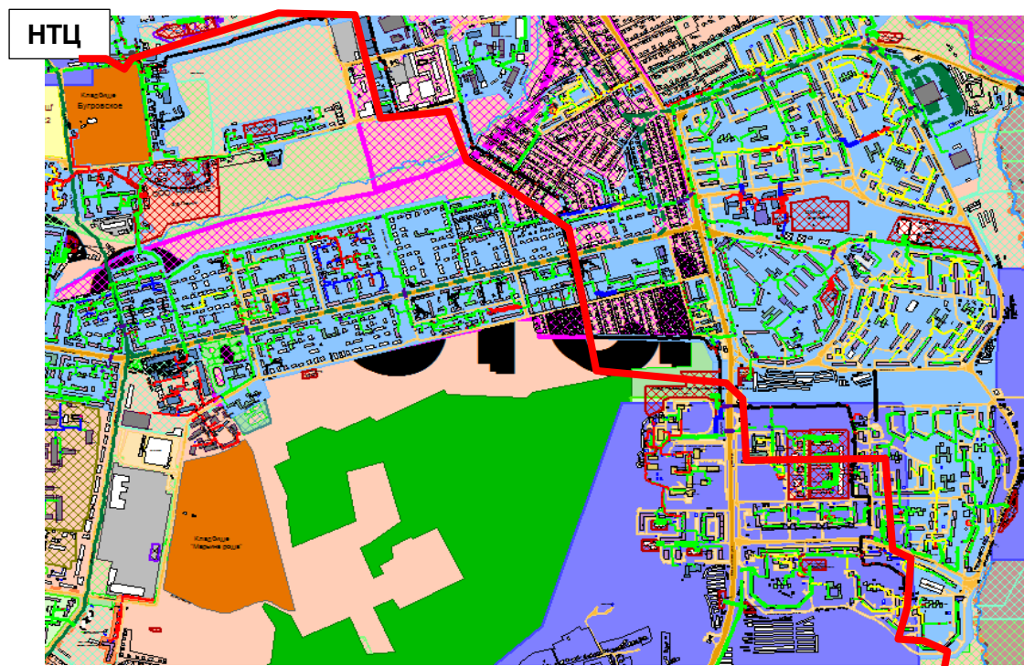
Рисунок 0.106 – Результат гидравлического расчета - расчетный путь теплоносителя от котельной НТЦ до ПТ-Малин,2 пристрой
