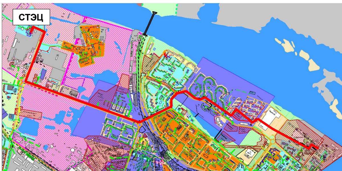
Рисунок 0.3 - Результат гидравлического расчета - расчетный путь теплоносителя от СТЭЦ до ПТ-ПП-2.64-2017
