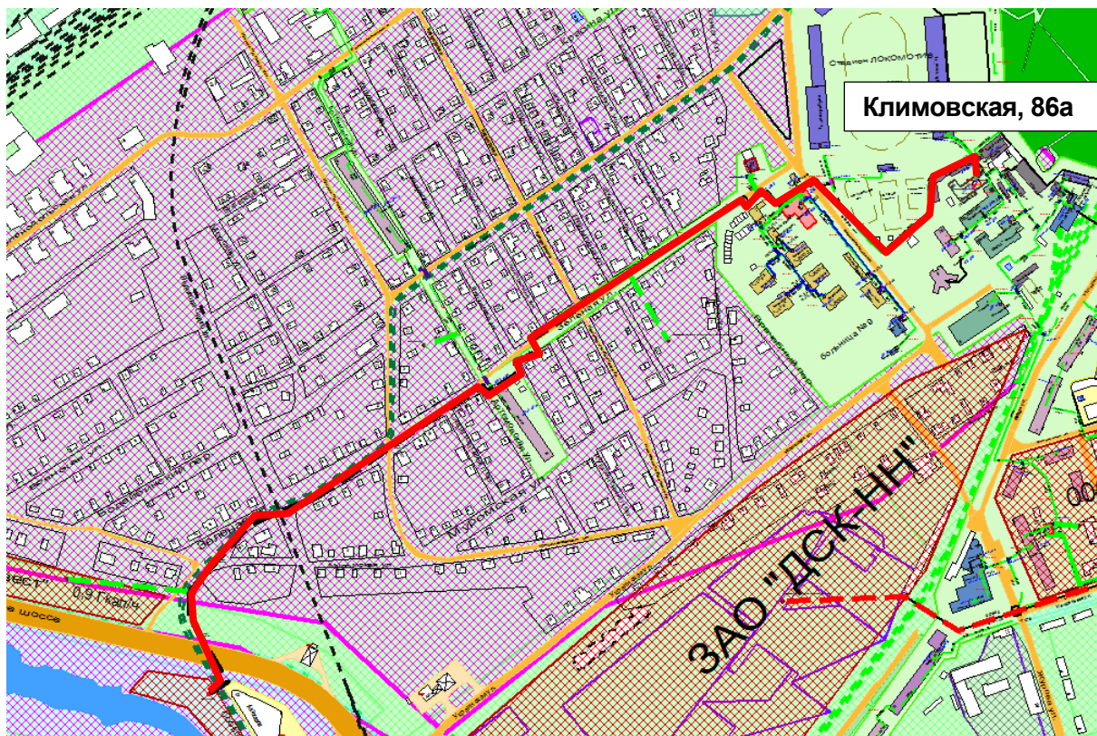
Рисунок 0.45 – Результат гидравлического расчета - расчетный путь теплоносителя от котельной Климовская, 86а до ПТ-ПП-2.227-2016
