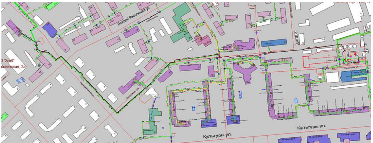
Рисунок 3.112 – Трассировка теплопровода от котельной АО «Теплоэнерго» по ул. Пугачева, д. 1 до конечного потребителя «ПТ-Судостр,28»
