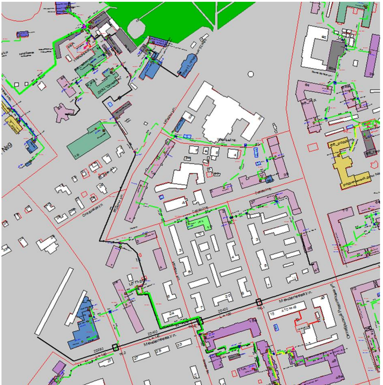
Рисунок 3.57 – Трассировка теплопровода от котельной АО «Теплоэнерго» по ул. Климовская, д. 86А до конечного потребителя «ПТ-Искры,11а»
