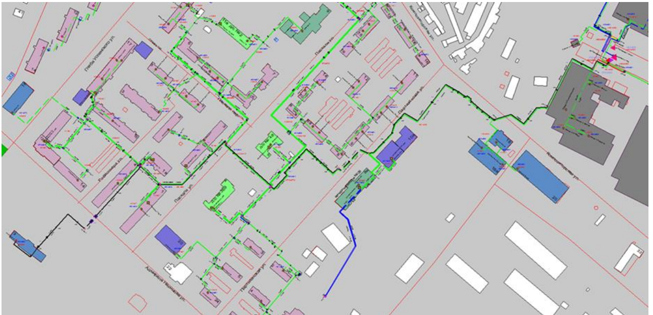
Рисунок 3.37 – Трассировка теплопровода от котельной АО «Теплоэнерго» по ул. Памирская, д. 11 до конечного потребителя «ПТ-Нахимова,3»
