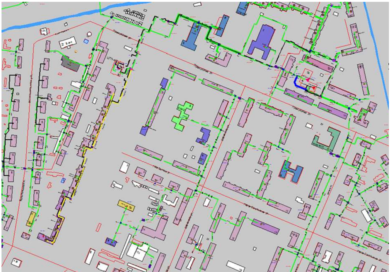
Рисунок 3.118 – Трассировка теплопровода от котельной АО «Теплоэнерго» по ул. Премудрова, д. 12А до конечного потребителя «ПТ-Днепр,16 э4»
