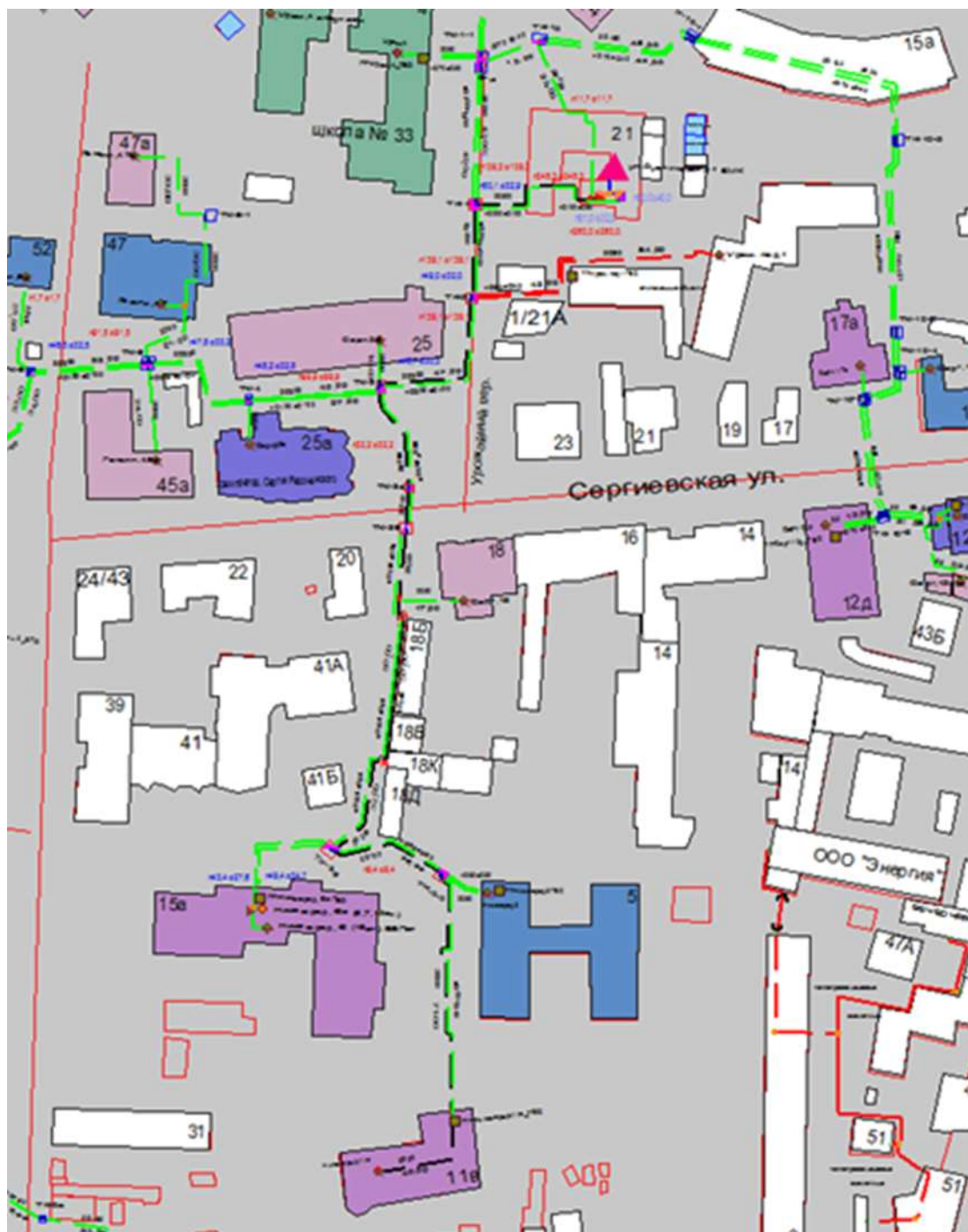
Рисунок 3.31 – Трассировка теплопровода от котельной АО «Теплоэнерго» по ул. Суетинская, д. 21 (БМК) до конечного потребителя «ПТ-Нижнегород,11в»
