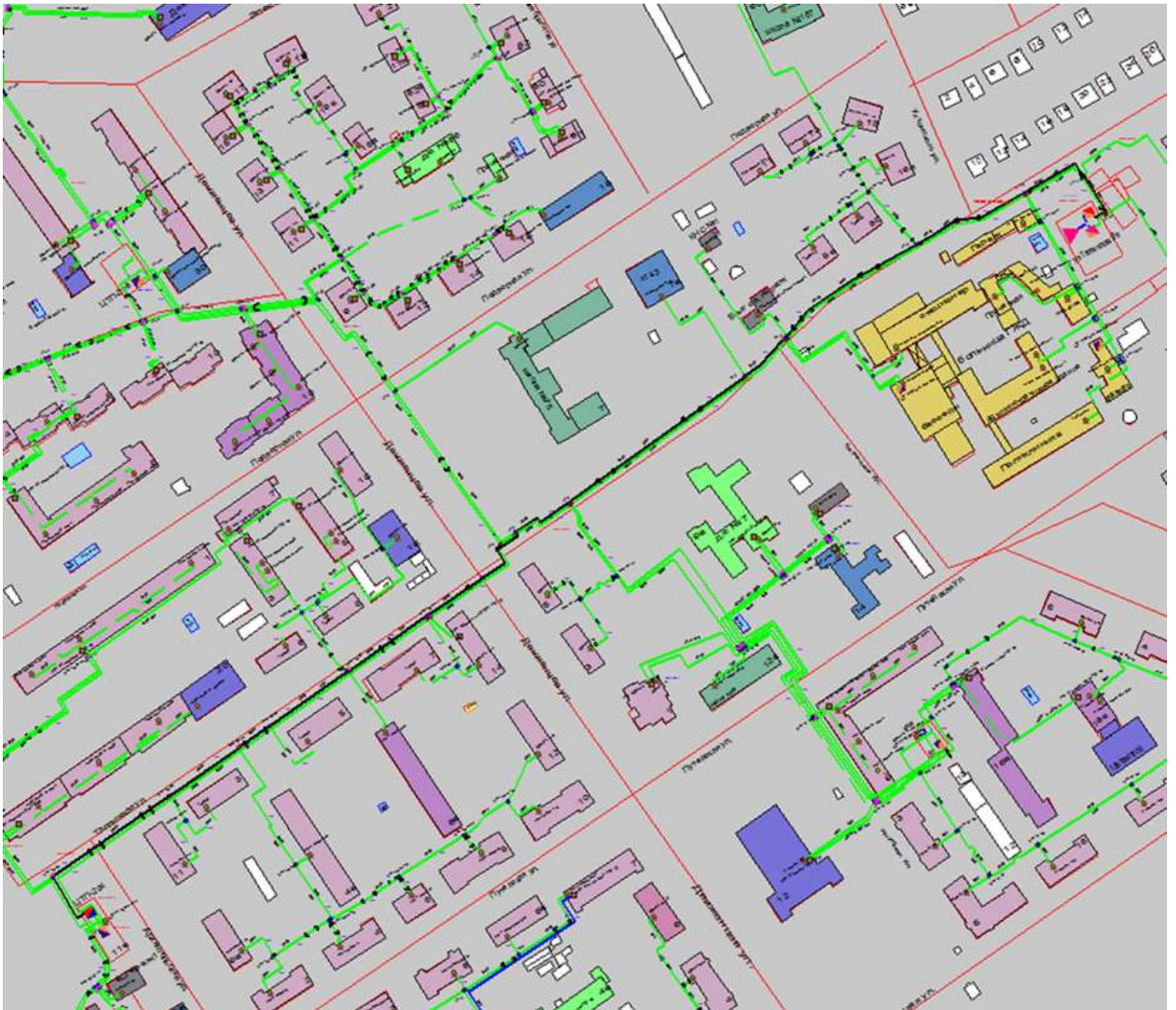
Рисунок 3.110 – Трассировка теплопровода от котельной АО «Теплоэнерго» по ул. Таллинская, д. 15В до конечного потребителя «ЦТП-204»
