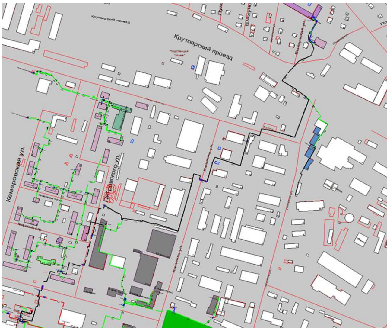
Рисунок 3.75 – Трассировка теплопровода от котельной АО «Теплоэнерго» «Термаль» по пр. Гагарина, д. 178Б до конечного потребителя «ЦТП-706»
