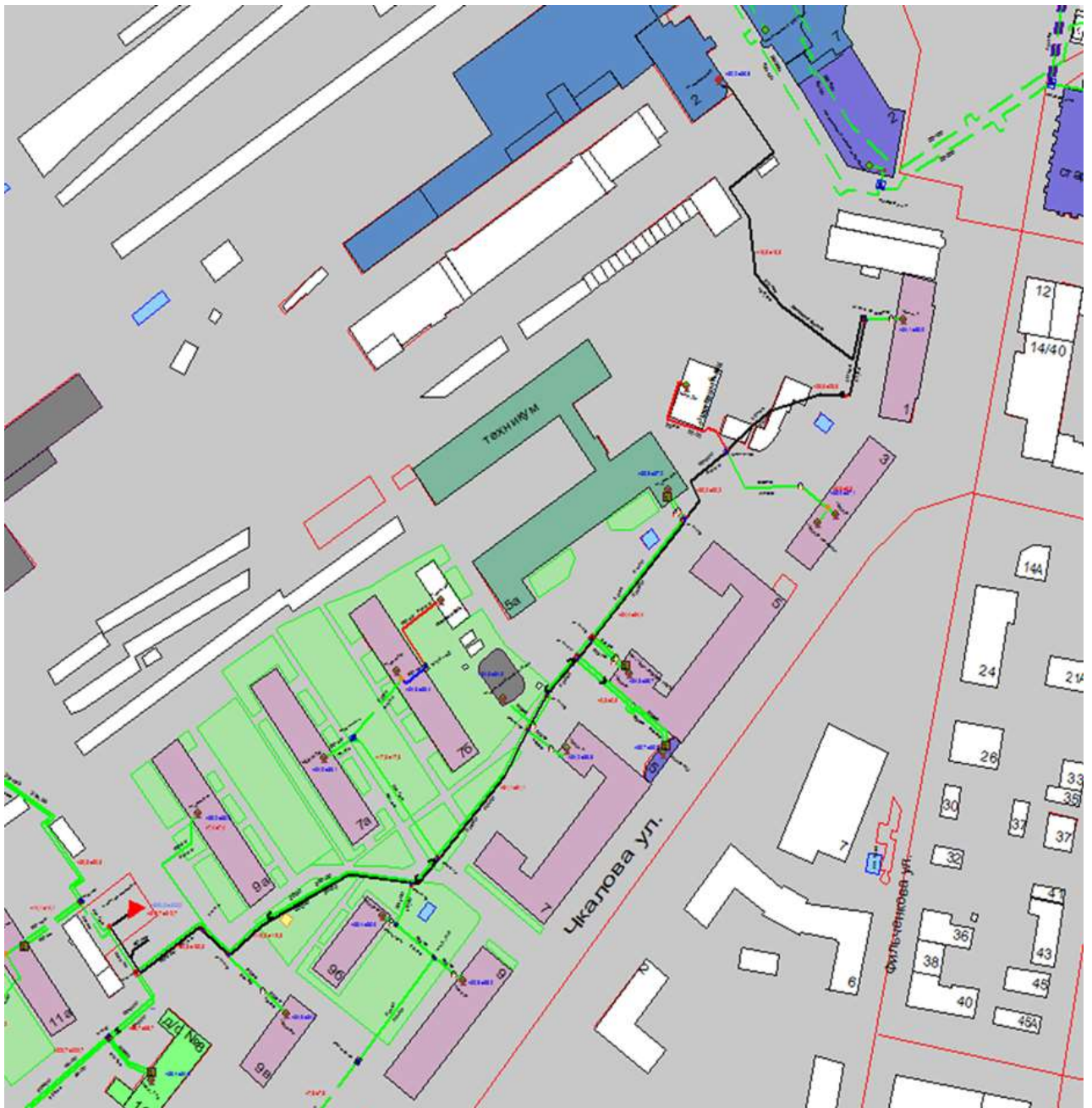
Рисунок 3.104 – Трассировка теплопровода от котельной АО «Теплоэнерго» по ул. Чкалова, д. 9Г до конечного потребителя «ПТ-Революция,2»
