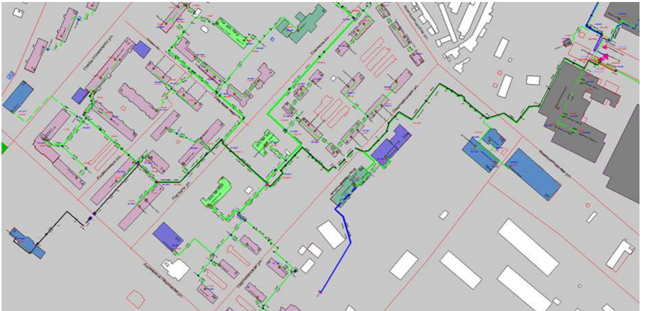
Рисунок 3.37 – Трассировка теплопровода от котельной АО «Теплоэнерго» по ул. Памирская, д. 11 до конечного потребителя «ПТ-Нахимов,3»
