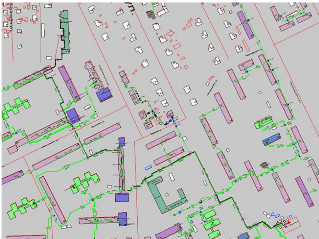
Рисунок 3.53 – Трассировка теплопровода от котельной АО «Теплоэнерго» по ул. Баранова, д. 11 до конечного потребителя «ПТ-Мечн,74 маст»
