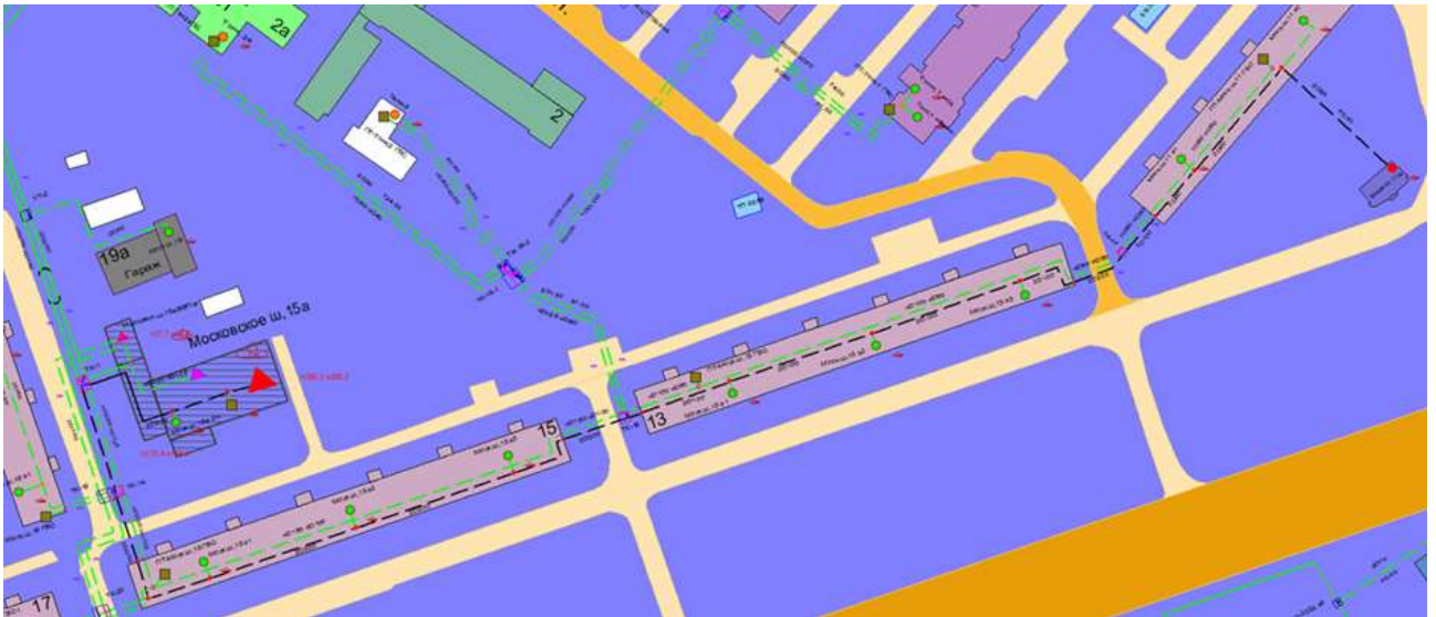
Рисунок 3.47 – Трассировка теплопровода от котельной АО «Теплоэнерго» Московское шоссе, д. 15а до конечного потребителя «ПТ-Моск.ш,11а»
