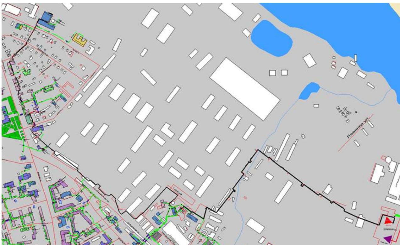
Рисунок 3.10 – Трассировка теплопровода от Сормовской ТЭЦ до конечного потребителя «ПТ-Свободы,57 ПЭКпр.1эт»
