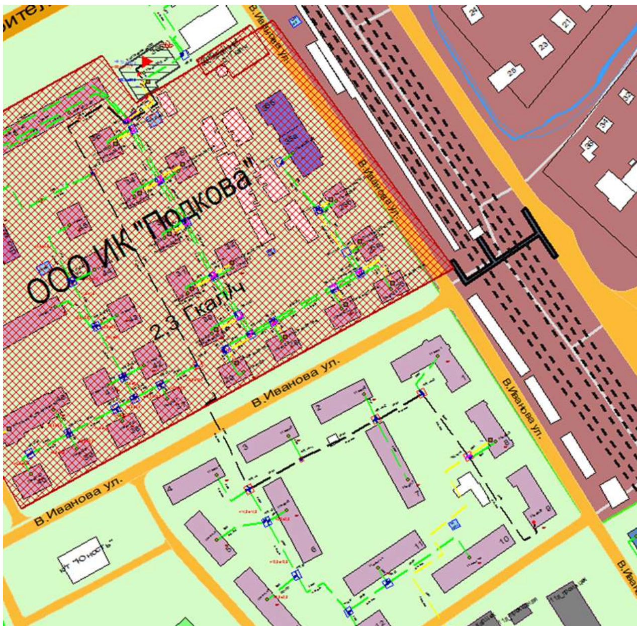
Рисунок 3.124 – Трассировка теплопровода от котельной АО «Теплоэнерго» по ул. Иванова, д. 36Б до конечного потребителя «ПТ-Иван,9»
