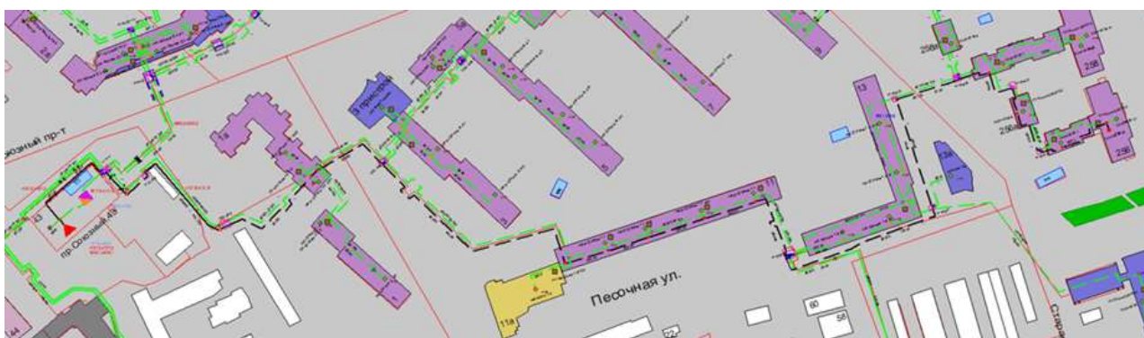
Рисунок 3.78 – Трассировка теплопровода от котельной АО «Теплоэнерго» по пр. Союзный, д. 43 до конечного потребителя «ПТ-Комин,256 э2»
