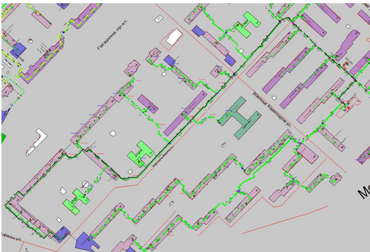
Рисунок Ошибка! Текст указанного стиля в документе отсутствует..33 – Трассировка теплопровода от котельной АО «Теплоэнерго» «Щербинки МР 2» по ул. Военных Комиссаров, д. 9 до конечного потребителя «ПТ-Гагар.пр,226 пристр»
