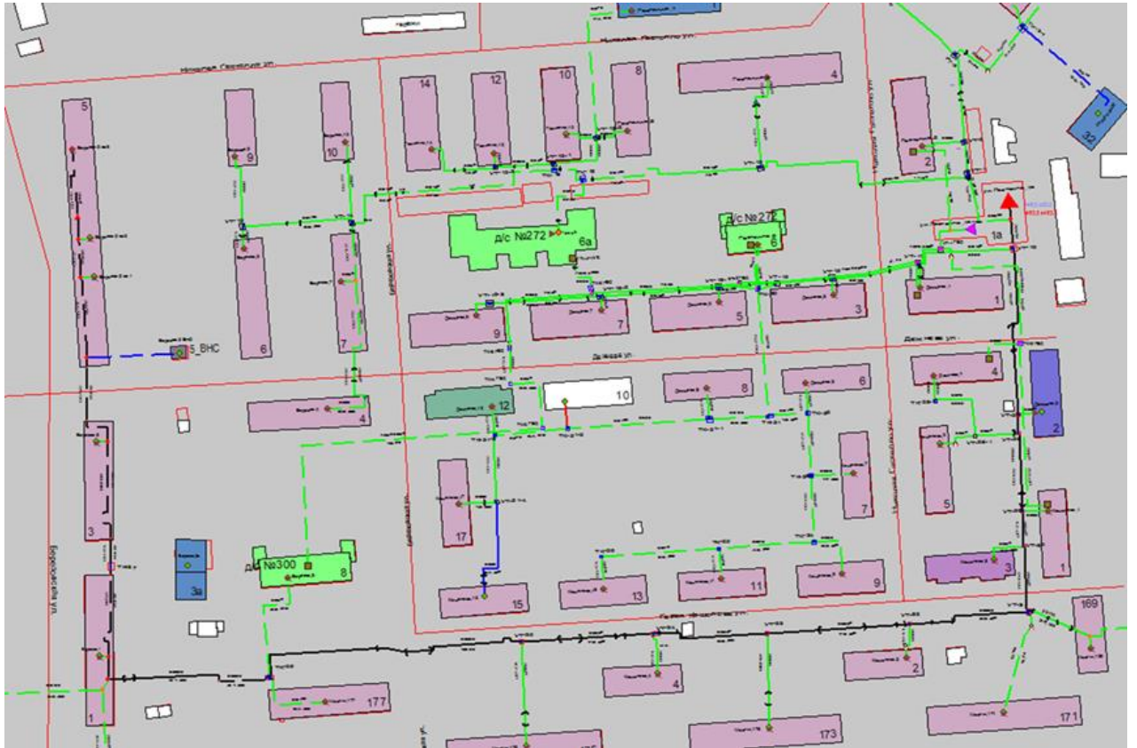
Рисунок Ошибка! Текст указанного стиля в документе отсутствует..21 – Трассировка теплопровода от котельной АО «Теплоэнерго» по ул. Гагаринов, д. 1А до конечного потребителя «ПТ-Березов,5 вв3»
