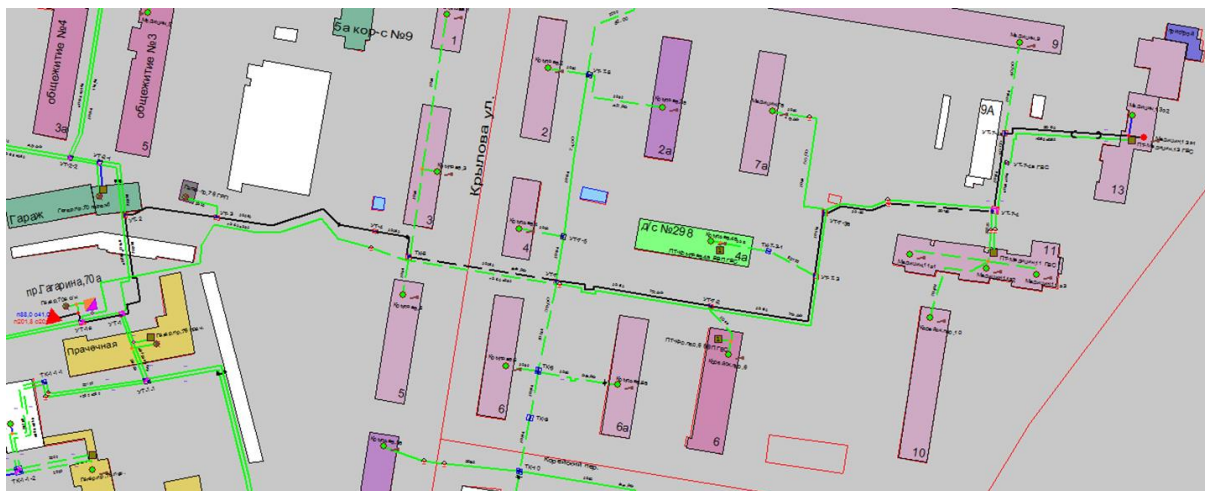
Рисунок 1.47 Результат гидравлического расчета - расчетный путь теплоносителя от котельной пр. Гагарина, 70а до ПТ-Медицин,13 э1
