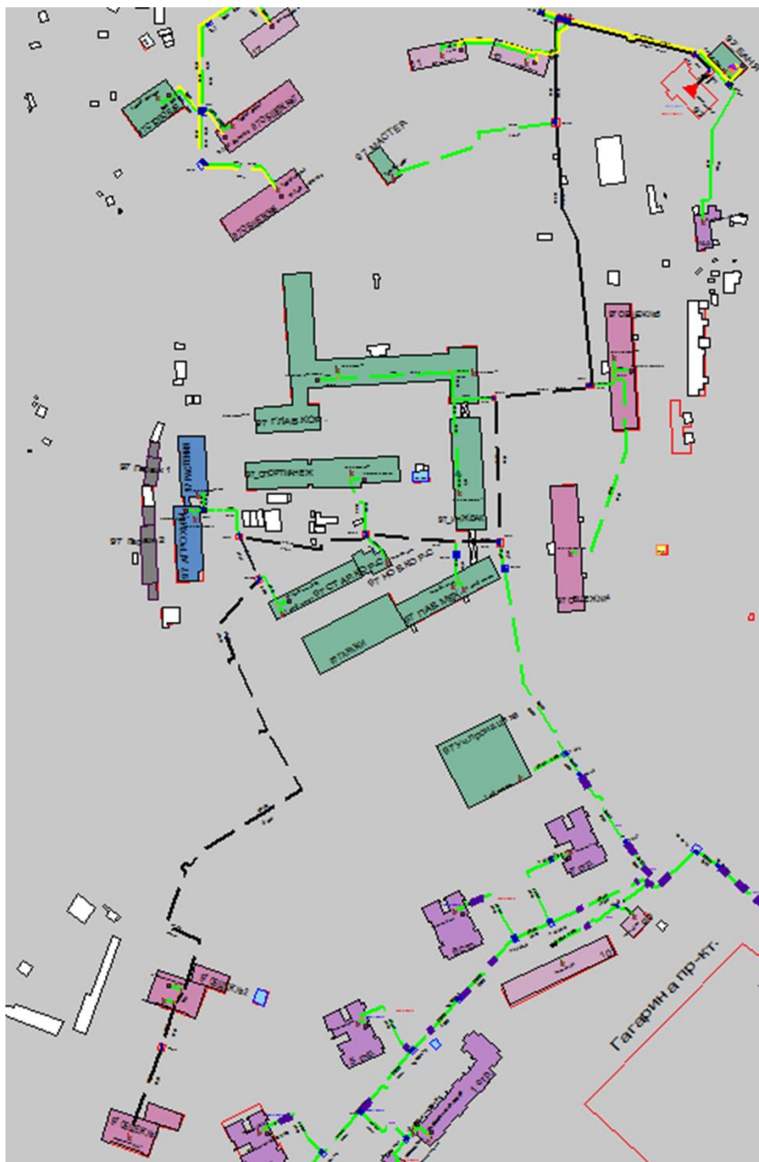
Рисунок 1.31 Результат гидравлического расчета - расчетный путь теплоносителя от котельной пр. Гагарина, 97 до ПТ-Гагар,97 общ.№1
