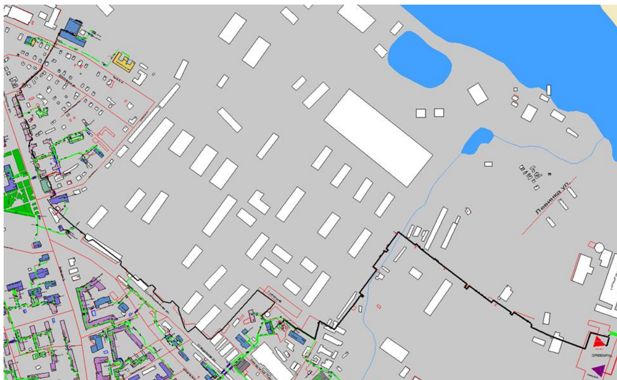
Рисунок 1.7 Результат гидравлического расчета - расчетный путь теплоносителя от СТЭЦ до ПТ-Свободы,57 ПЭКпр.1эт
