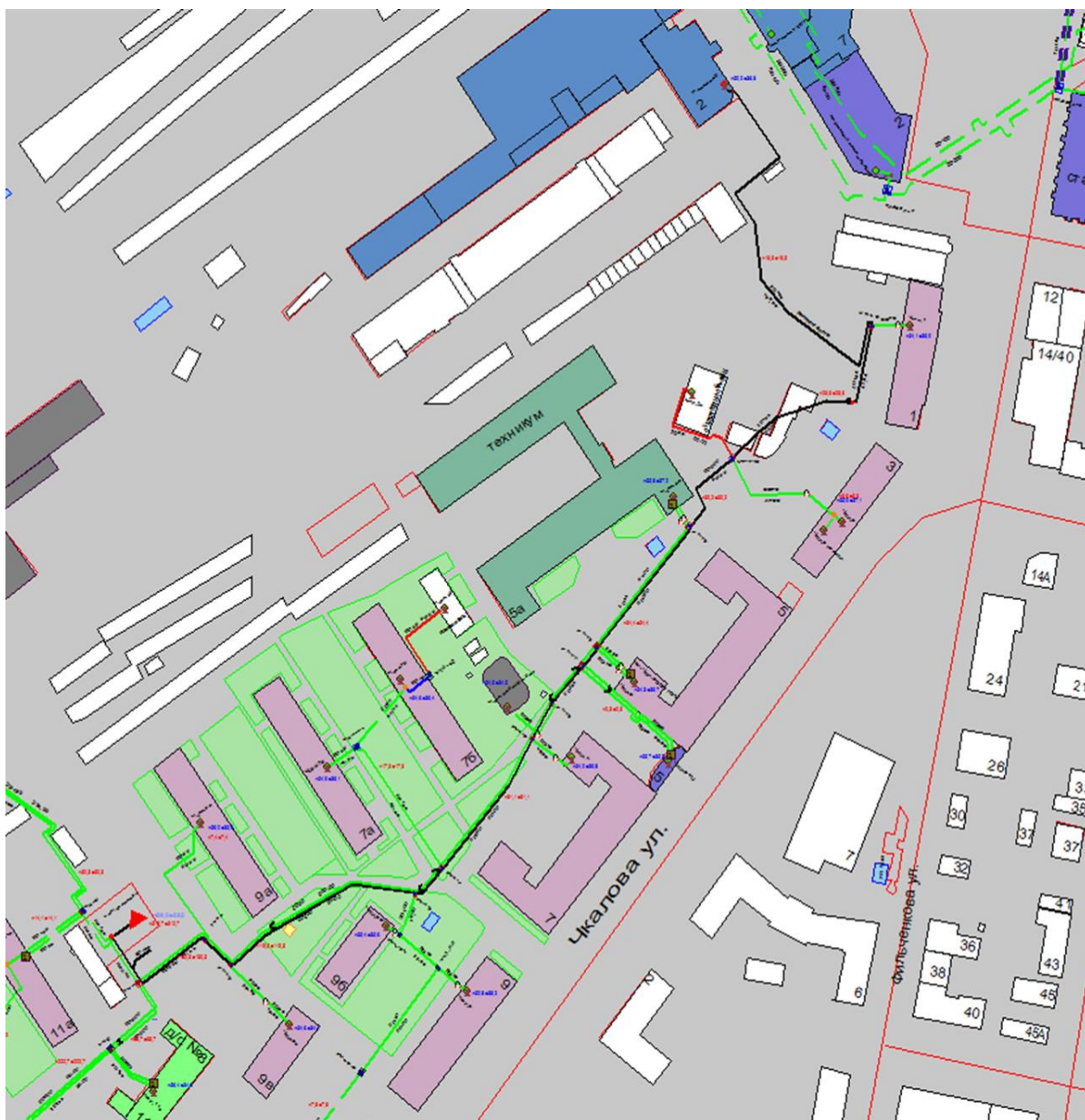
Рисунок 1.95 Результат гидравлического расчета - расчетный путь теплоносителя от котельной Чкалова, 9д до ПТ-Револ.пл.2
