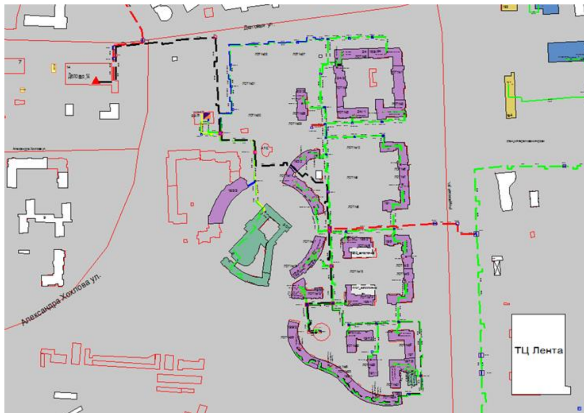
Рисунок 1.21 Результат гидравлического расчета - расчетный путь теплоносителя от котельной Деловая, 14 до ПТ-Род.199/2_н
