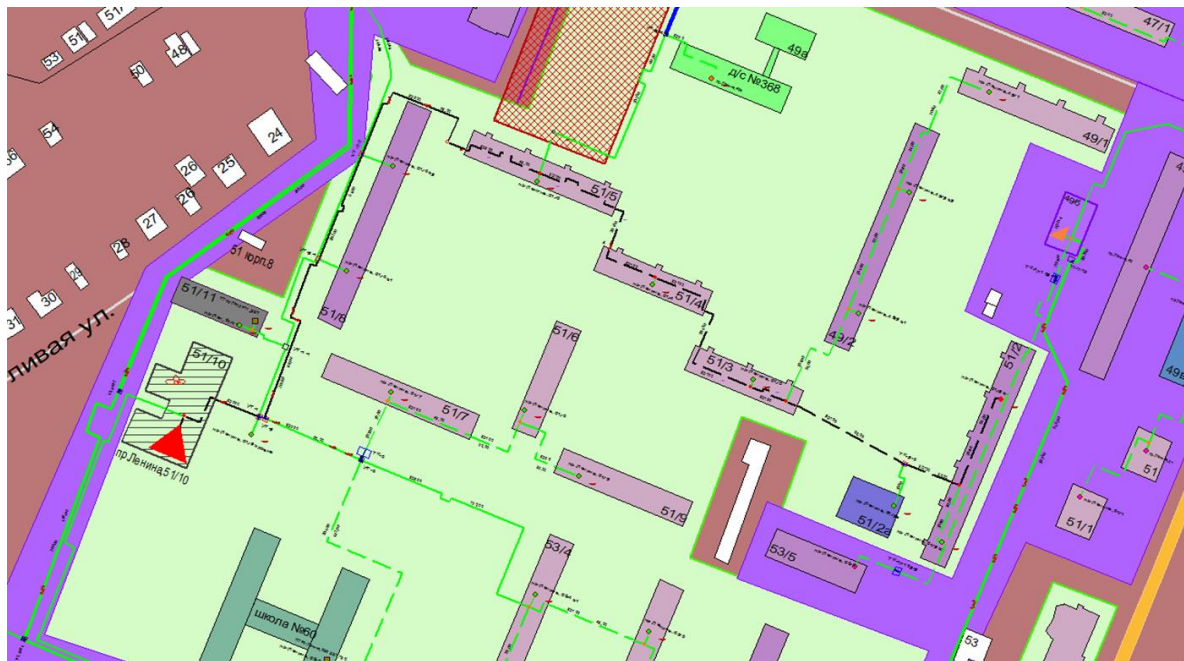
Рисунок 1.85 Результат гидравлического расчета - расчетный путь теплоносителя от котельной пр. Ленина, 51 корпус 10 до ПТ-пр.Ленина,51/2 э1
