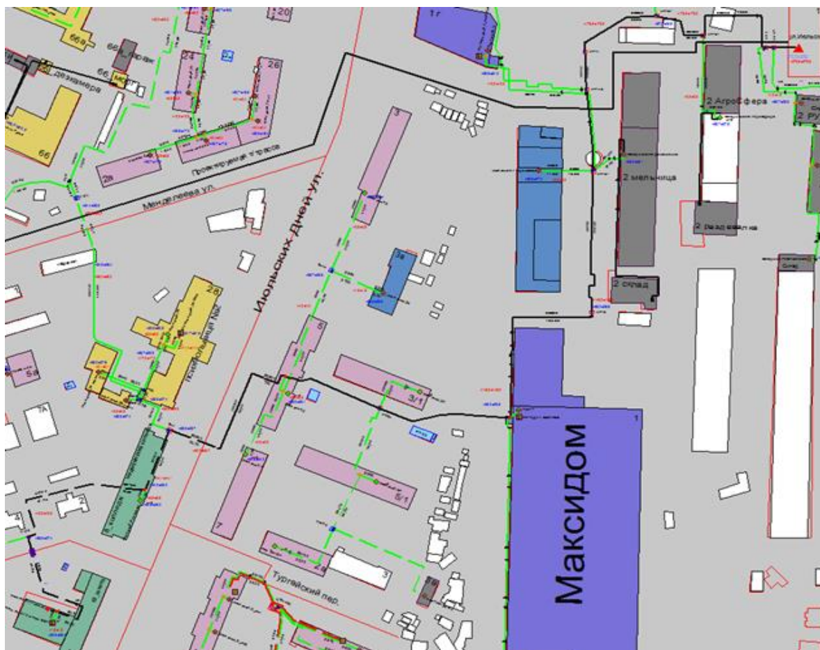
Рисунок 1.23 Результат гидравлического расчета - расчетный путь теплоносителя от Июльских дней, 1 до ПТ-Июльских,10 школа
