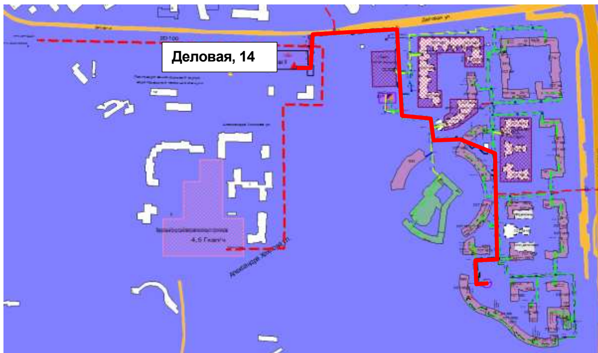
Рисунок 1.27 – Результат гидравлического расчета - расчетный путь теплоносителя от котельной Деловая, 14 до ПТ-Род.199/2_н
