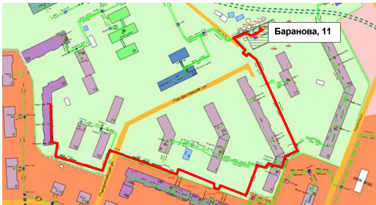
Рисунок 1.37 – Результат гидравлического расчета - расчетный путь теплоносителя от котельной Баранова, 11 до ПТ-Панфил,15 э2
