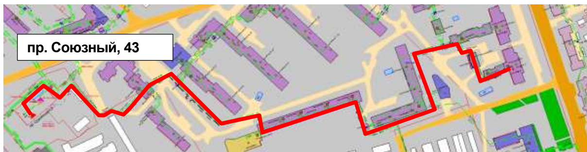
Рисунок 1.71 – Результат гидравлического расчета - расчетный путь теплоносителя от котельной пр. Союзный, 43 до ПТ-Комин,256 э2
