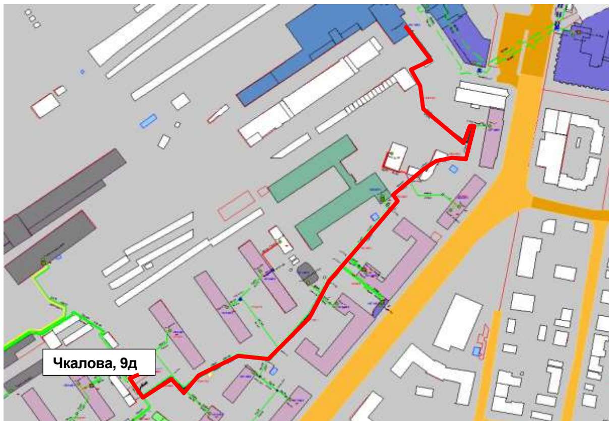
Рисунок 1.115 – Результат гидравлического расчета - расчетный путь теплоносителя от котельной Чкалова, 9д до ПТ-Революц.пл,2
