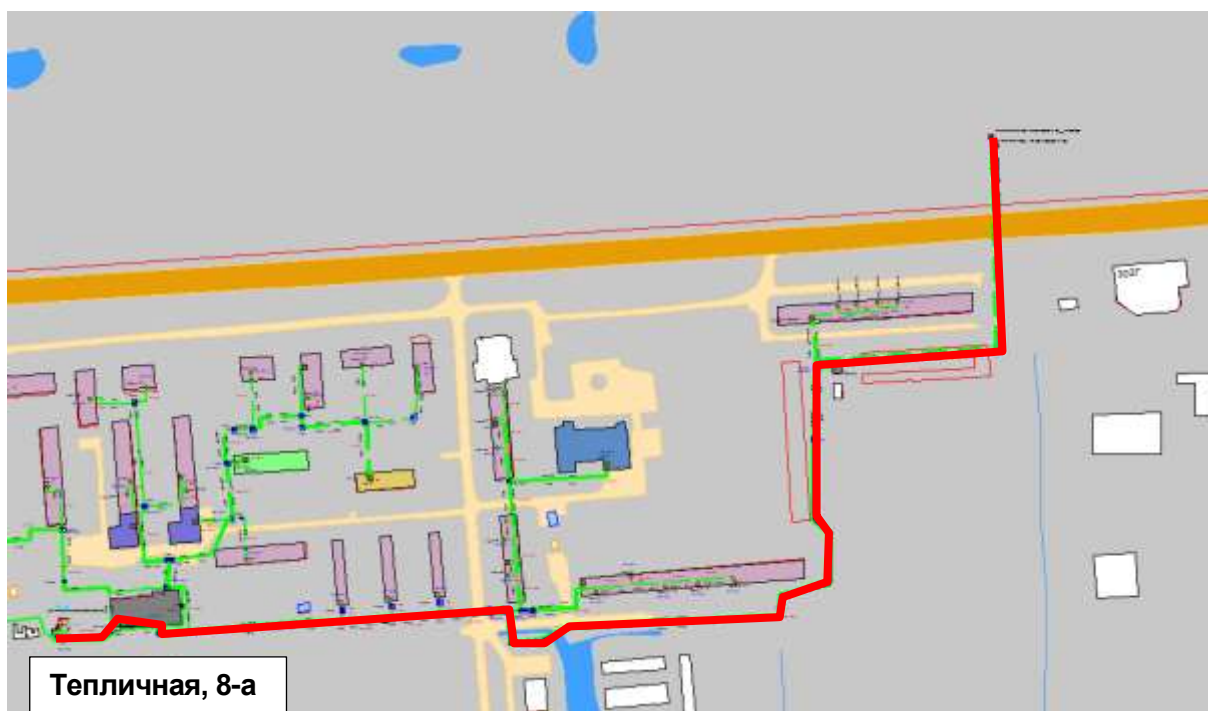
Рисунок 1.121 – Результат гидравлического расчета - расчетный путь теплоносителя от котельной Тепличная, 8-а до ПТ-ПП-2.75-2018
