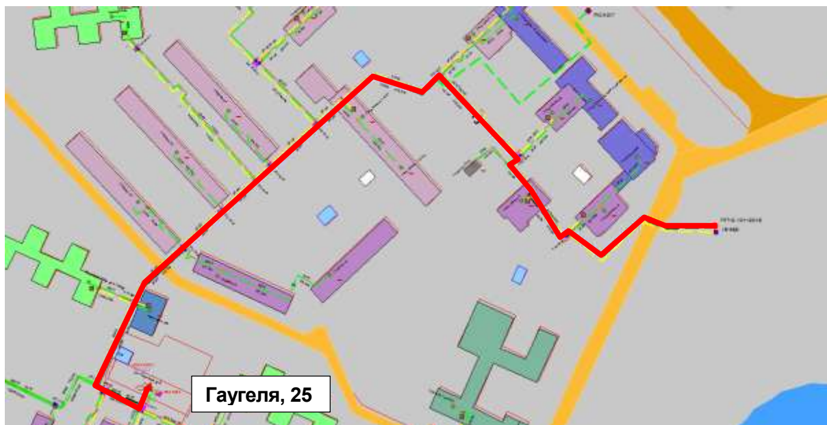
Рисунок 1.83 – Результат гидравлического расчета - расчетный путь теплоносителя от котельной ул. Иванова, 14б до ПТ-Светлояр.38_полик
