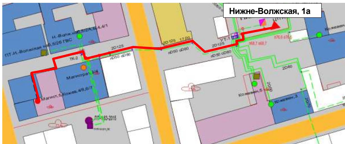
Рисунок 1.23 – Результат гидравлического расчета - расчетный путь теплоносителя от Нижне-Волжская, 2а до ПТ-Магист,5,Кожев,4/8,6/7
