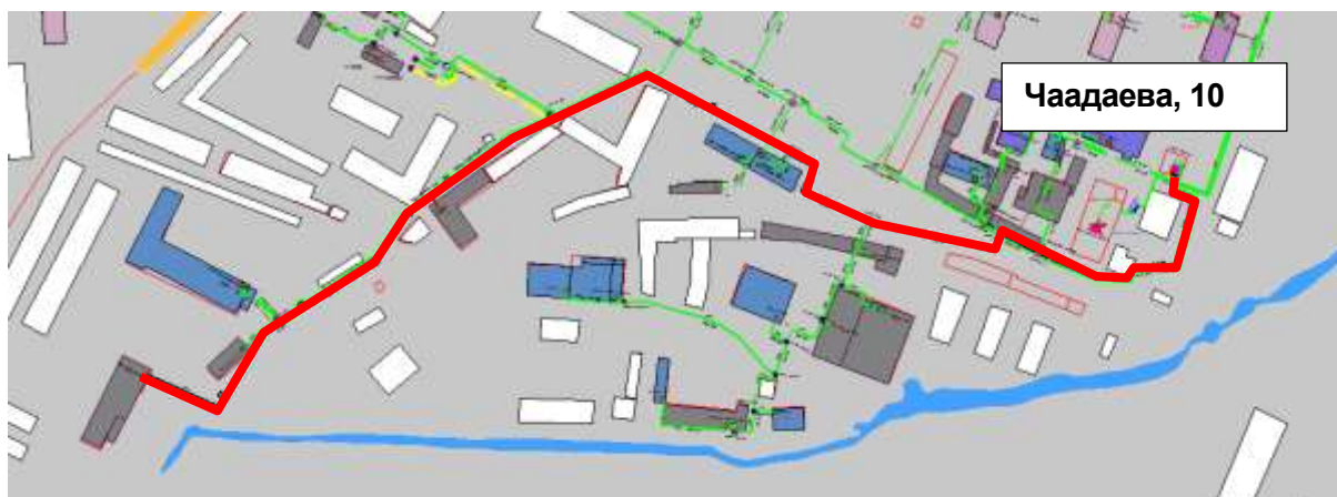
Рисунок 1.113 – Результат гидравлического расчета - расчетный путь теплоносителя от котельной Чаадаева, 10 до ПТ-Чаад,44а гар.нов.
