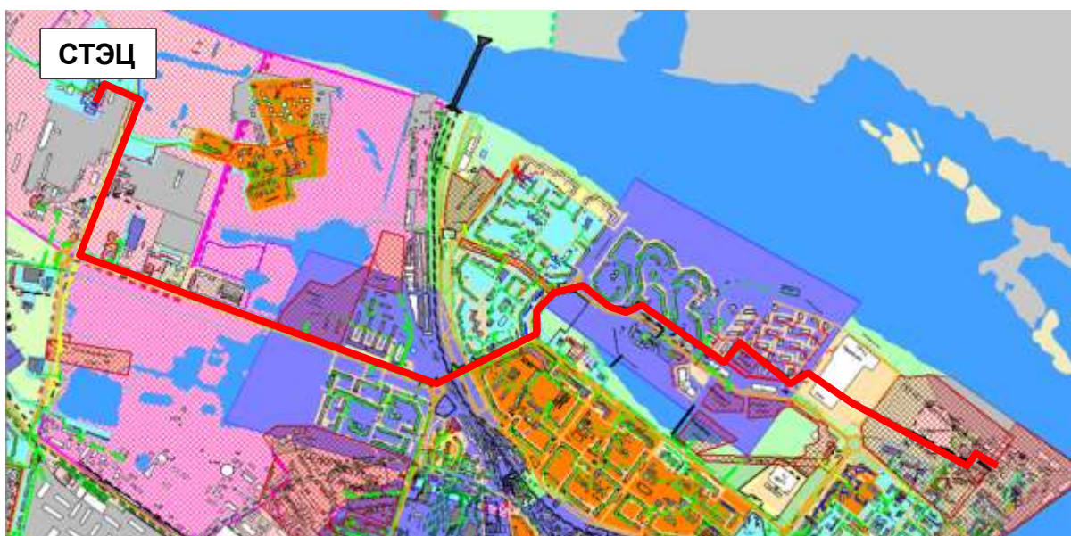
Рисунок 1.3 - Результат гидравлического расчета - расчетный путь теплоносителя от СТЭЦ до ПТ-ПП-2.64-2017
