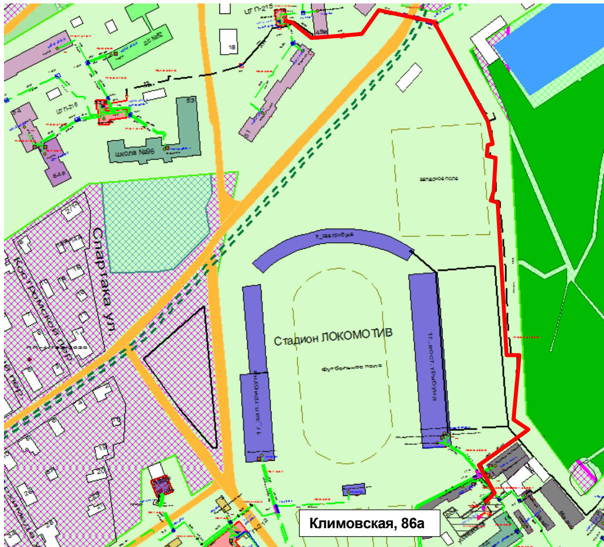
Рисунок 1.43 – Результат гидравлического расчета - расчетный путь теплоносителя от котельной Климовская, 86а до ЦТП-216
