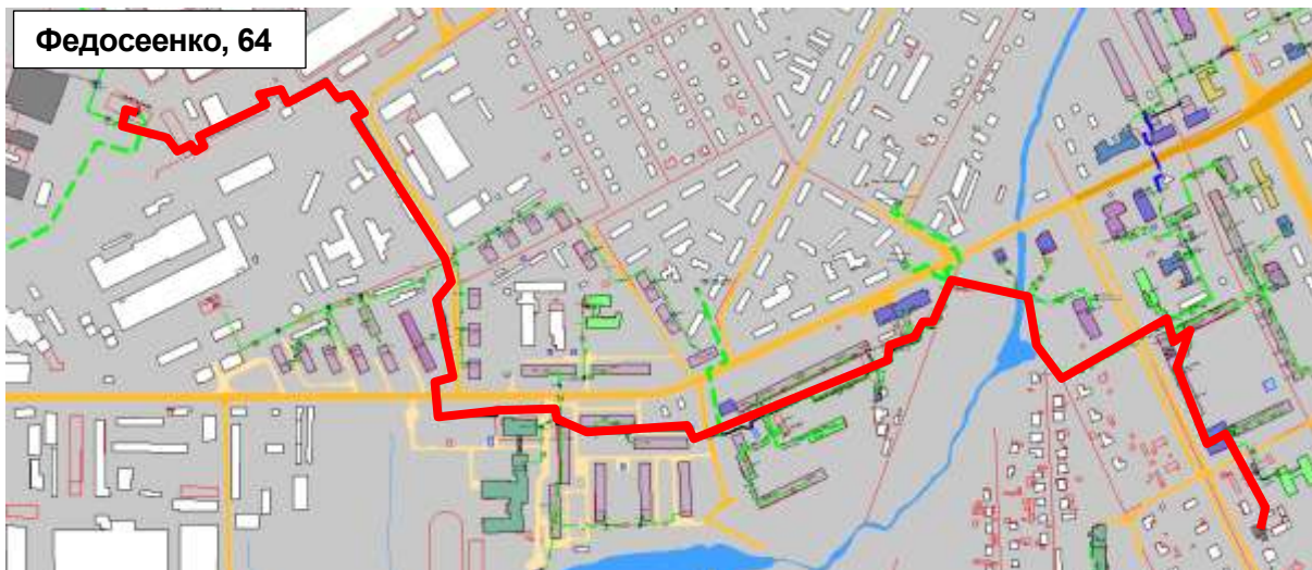
Рисунок 1.111 – Результат гидравлического расчета - расчетный путь теплоносителя от котельной ФГУП «Завод «Электромаш» до ПТ-Коммуны,31
