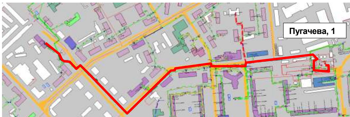
Рисунок 1.127 – Результат гидравлического расчета - расчетный путь теплоносителя от котельной Пугачева, 1 до ПТ-Судостр.28
