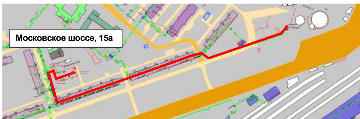
Рисунок 1.31 – Результат гидравлического расчета - расчетный путь теплоносителя от котельной Московское шоссе, 15а до ПТ-ПП-2.208-2016
