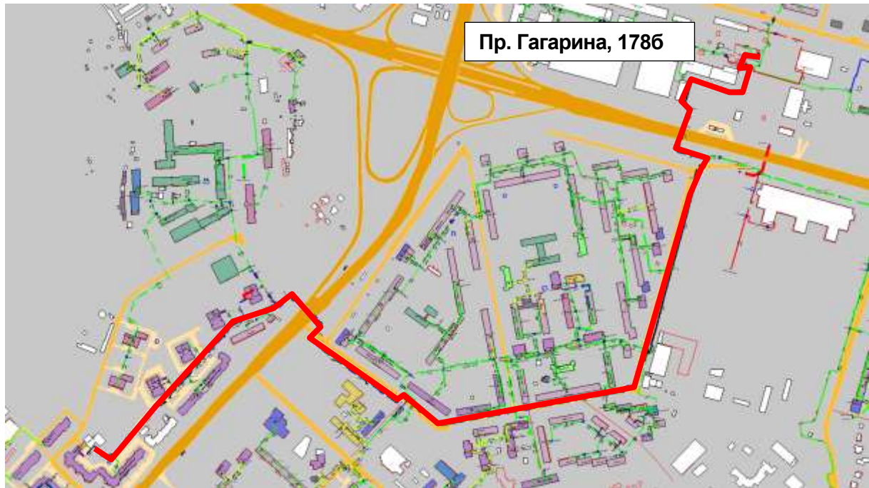
Рисунок 1.67 – Результат гидравлического расчета - расчетный путь теплоносителя от котельной пр. Гагарина, 1786 до ПТ-Гагар.пр,101/5 ИТП №2
