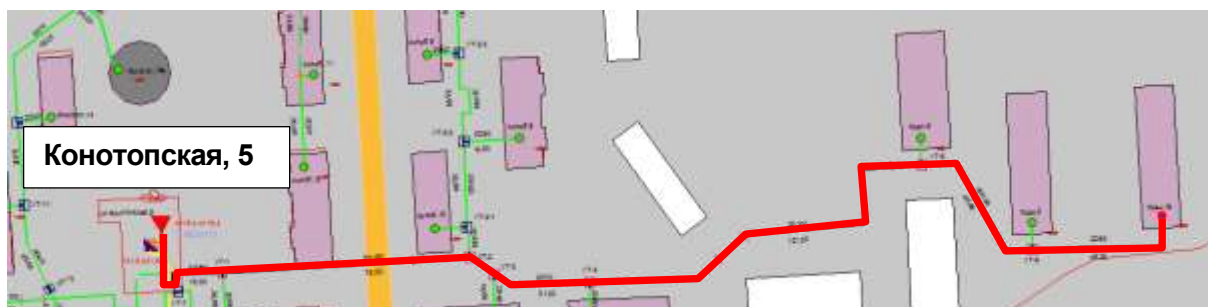
Рисунок 1.95 – Результат гидравлического расчета - расчетный путь теплоносителя от котельной Конопотская, 5 до ПТ-Кран,1а
