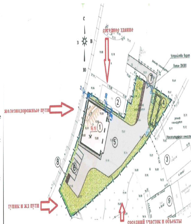
Схема 1. Взаимное расположение предполагаемого для строительства здания и границ земельного участка 52:18:0010014:236.
