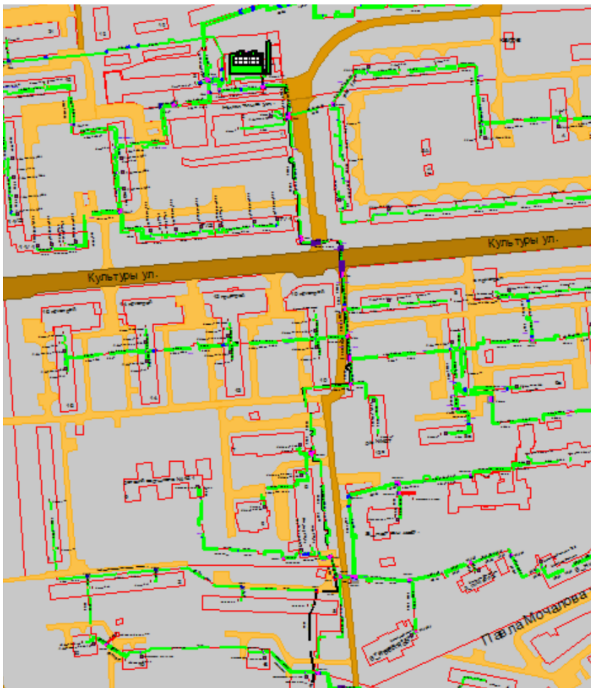
Рисунок 1.105 Результат гидравлического расчета - расчетный путь теплоносителя от котельной Пугачева, 1 до ПТ-Юбилейн. б-р,17
