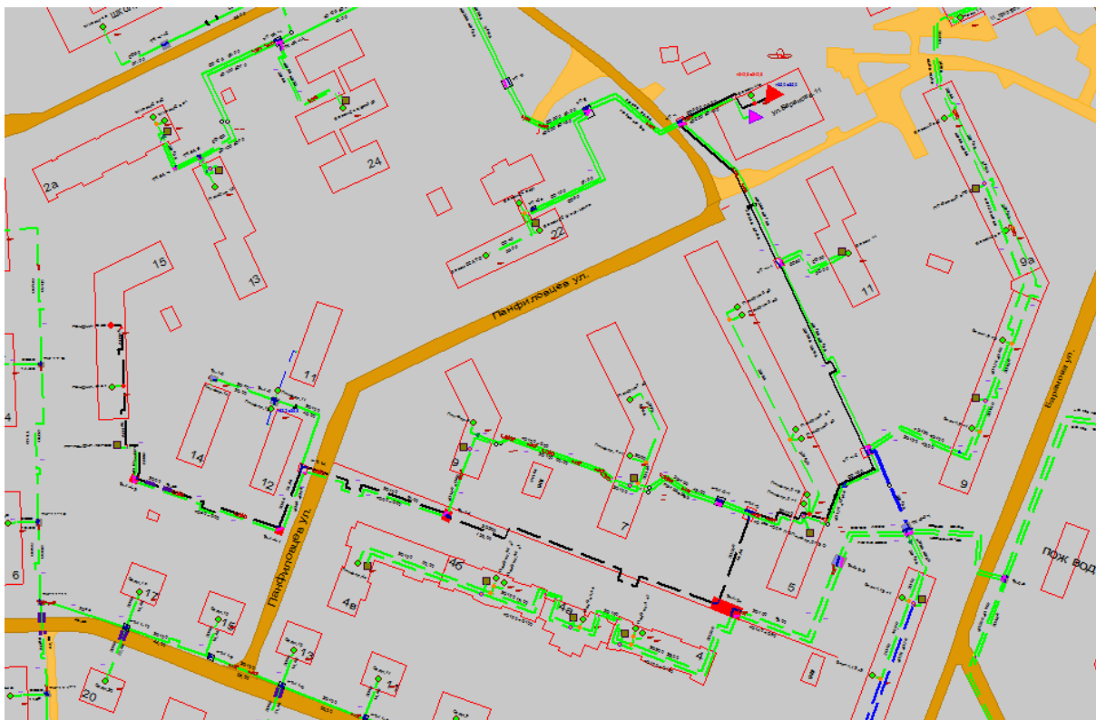
Рисунок 1.35 Результат гидравлического расчета - расчетный путь теплоносителя от котельной Баранова, 11 до ПТ-Панфил,15 э2
