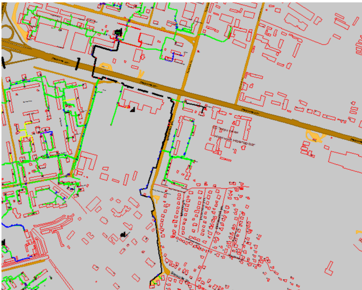
Рисунок 1.55 Результат гидравлического расчета - расчетный путь теплоносителя от котельной пр. Гагарина, 1786 до ПТ-Кащенко,14а
