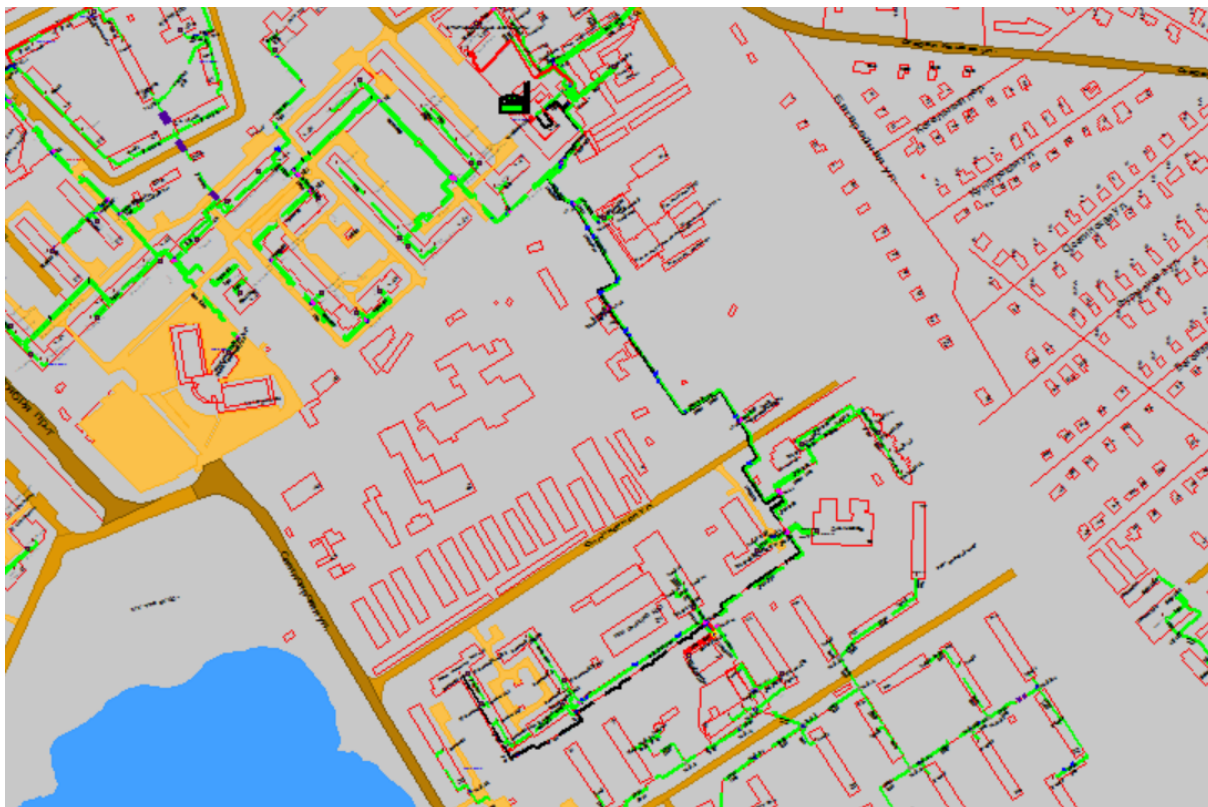
Рисунок 1.77 Результат гидравлического расчета - расчетный путь теплоносителя от котельной ул. Иванова, 14д до ПТ-Светлояр.38_полик
