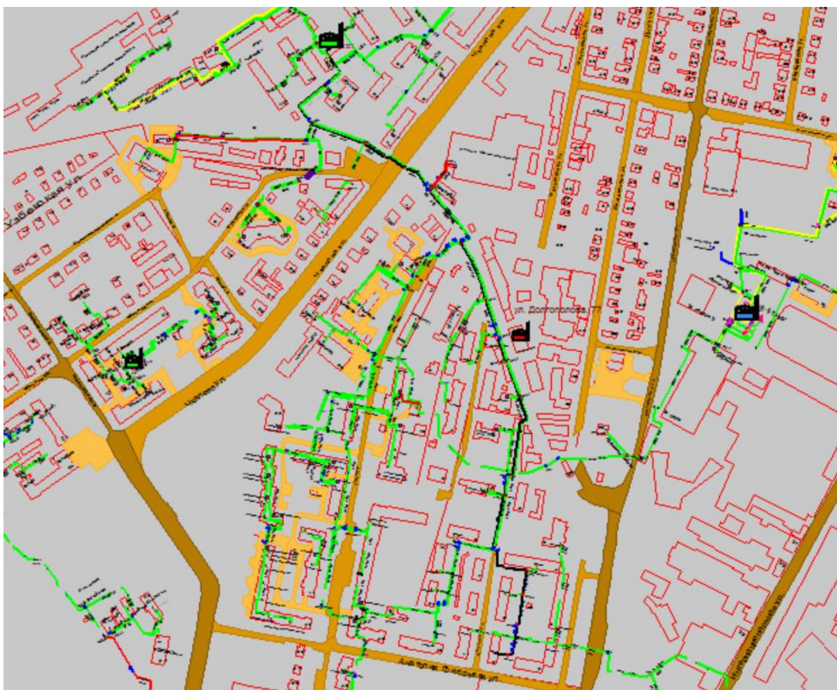
Рисунок 1.97 Результат гидравлического расчета - расчетный путь теплоносителя от котельной Чкалова, 9д до ПТ-Вольск,8
