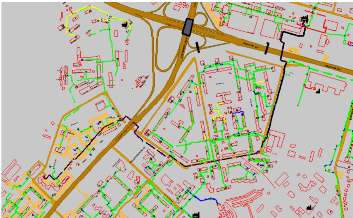
Рисунок 1.57 Результат гидравлического расчета - расчетный путь теплоносителя от котельной пр. Гагарина, 1786 до ПТ-Гагар.пр,101/5 ИТП №2
