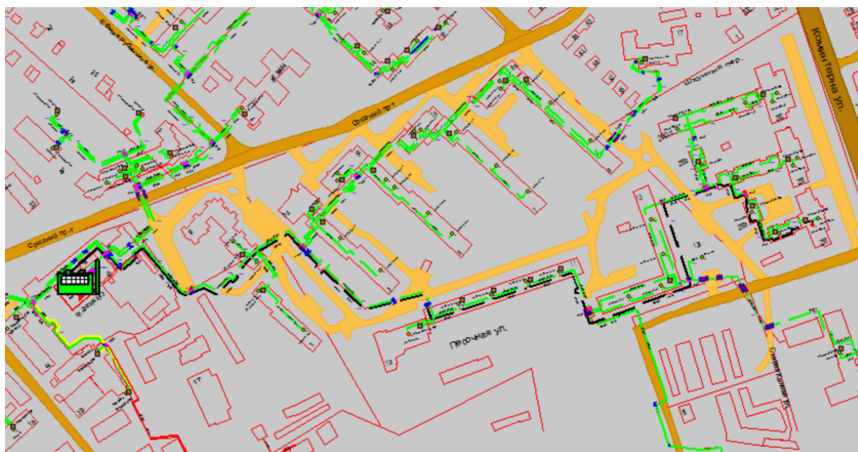
Рисунок 1.61 Результат гидравлического расчета - расчетный путь теплоносителя от котельной пр. Союзный, 43 до ПТ-Комин,256 э2
