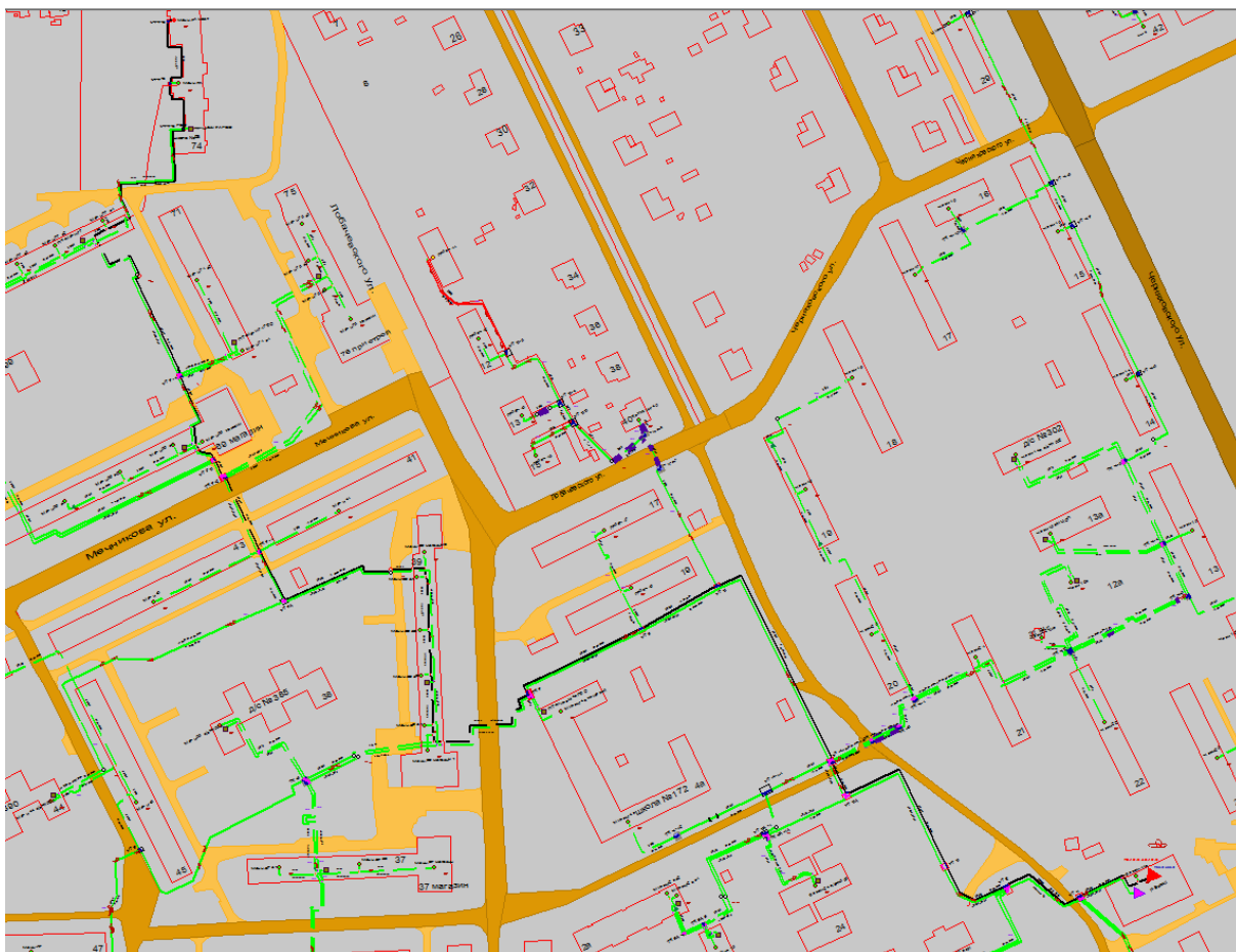
Рисунок 1.33 Результат гидравлического расчета - расчетный путь теплоносителя от котельной Баранова, 11 до ПТ-Мечн,74 маст
