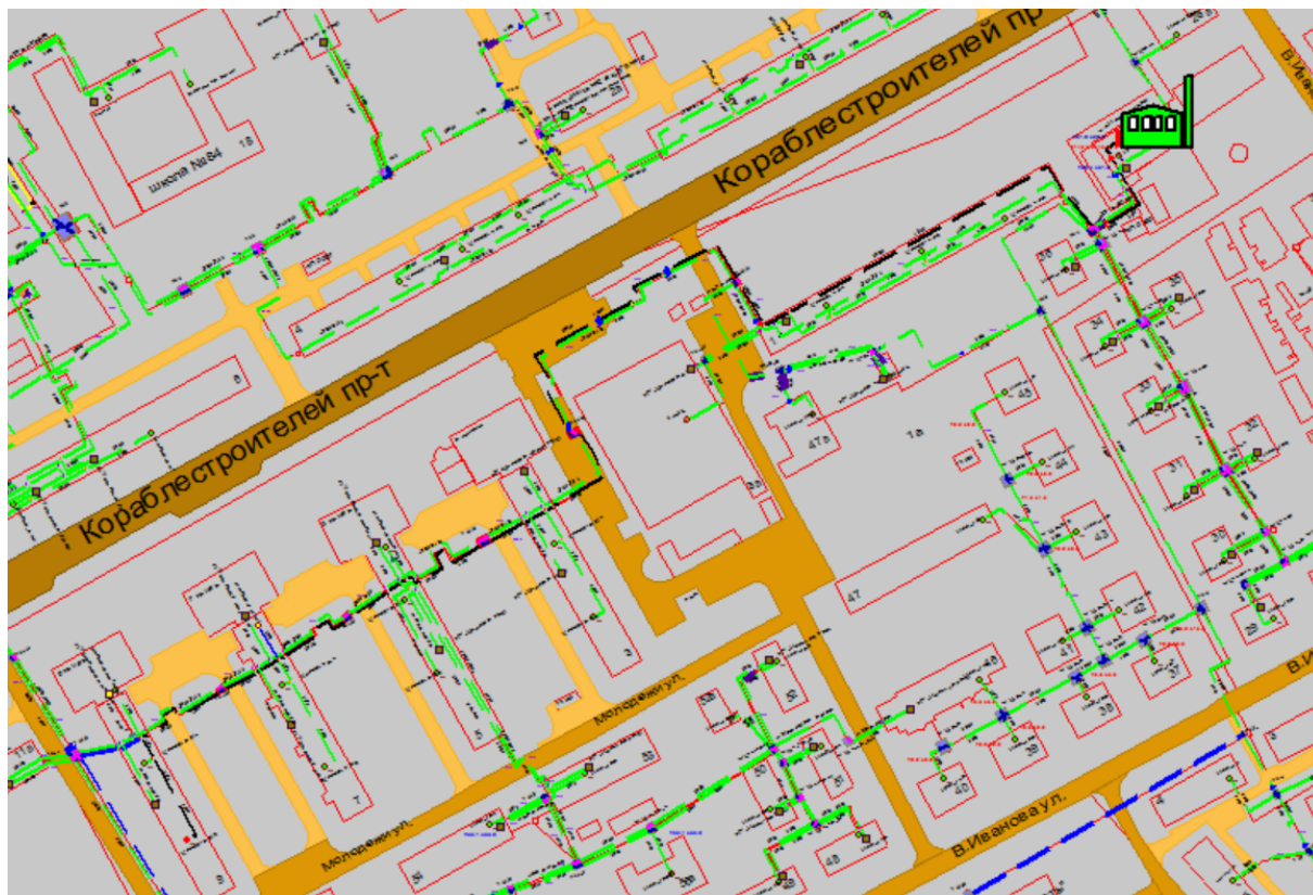
Рисунок 1.117 Результат гидравлического расчета - расчетный путь теплоносителя от котельной ул. Иванова, 36-б до ПТ-Кораб,9 Э2
