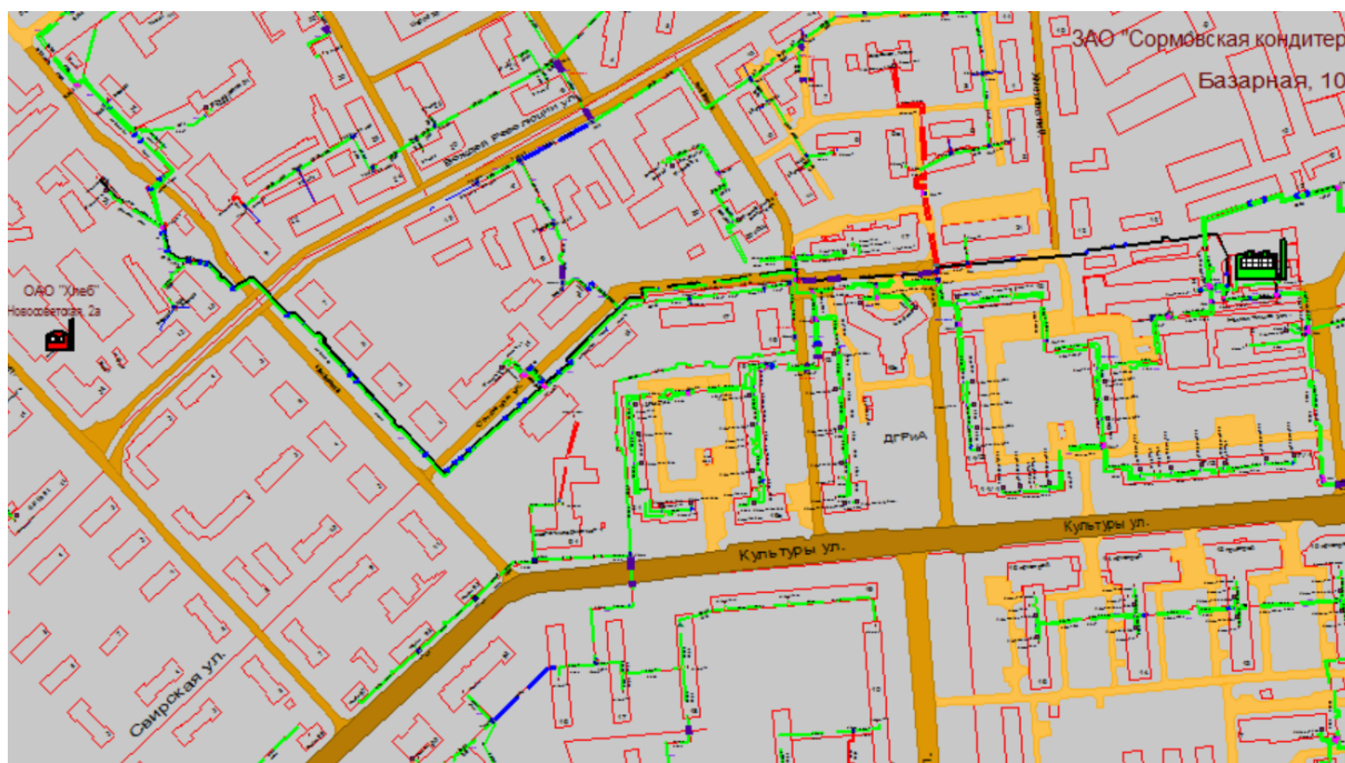
Рисунок 1.103 Результат гидравлического расчета - расчетный путь теплоносителя от котельной Пугачева, 1 до ПТ-Судостр.28
