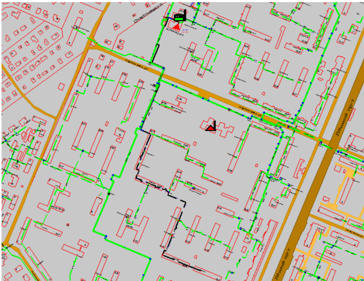
Рисунок 1.87 Результат гидравлического расчета - расчетный путь теплоносителя от котельной пр. Ленина, 51 корпус 10 до ПТ-пр.Ленина,63/1
