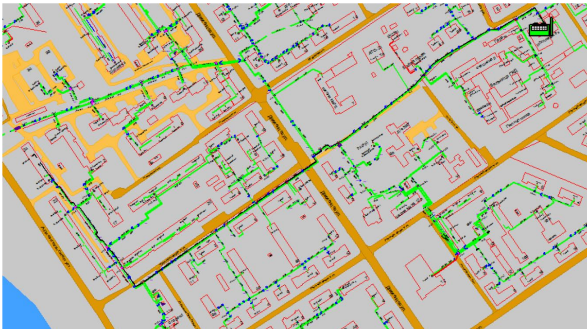
Рисунок 1.101 Результат гидравлического расчета - расчетный путь теплоносителя от котельной Таллинская, 15в до ПТ-Архан,24 вв2
