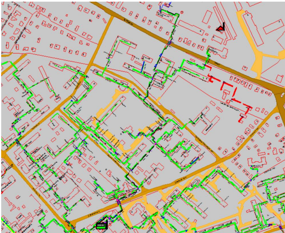
Рисунок 1.63 Результат гидравлического расчета - расчетный путь теплоносителя от котельной пр. Союзный, 43 до ПТ-Радищ,18
