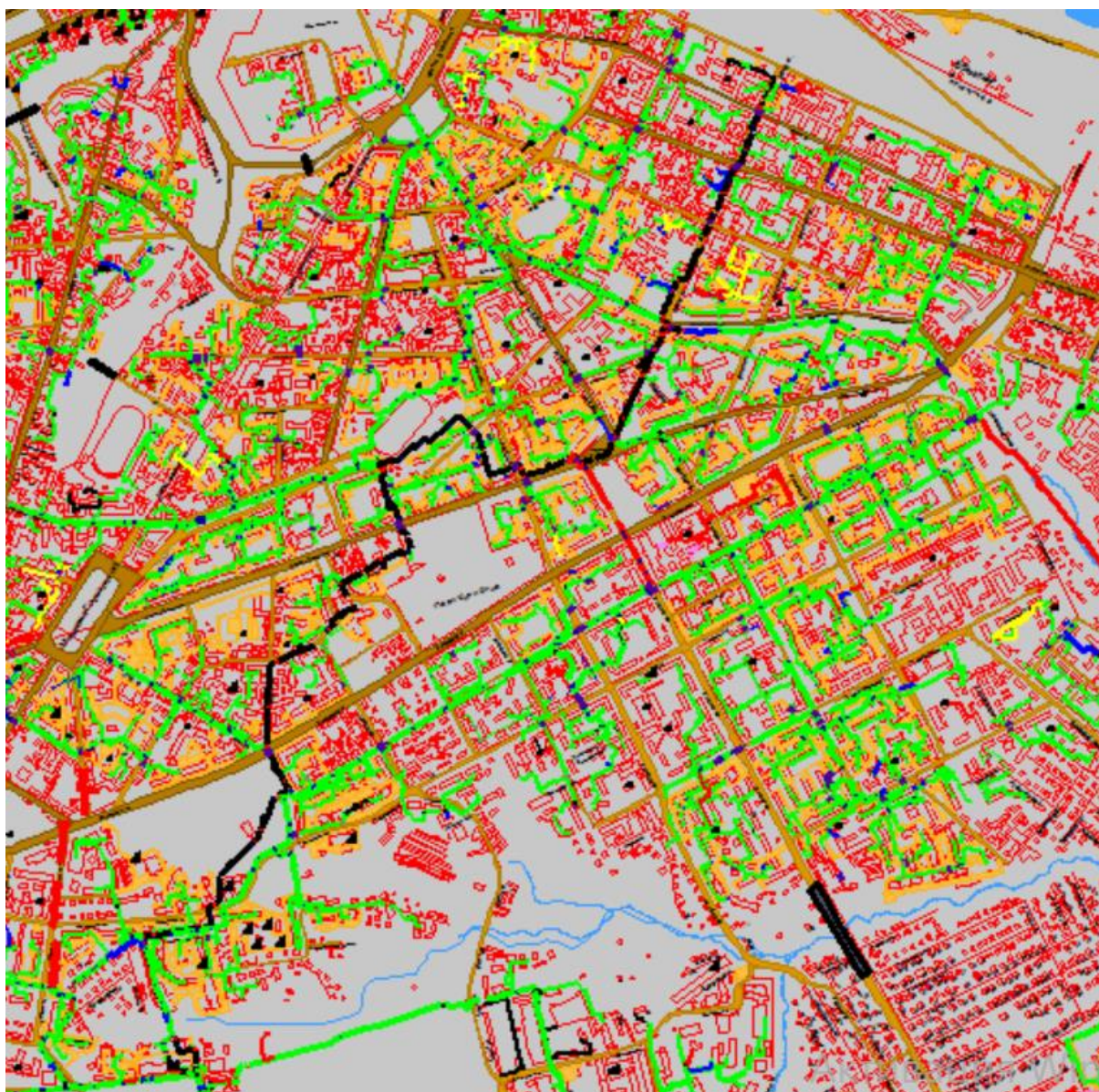
Рисунок 1.51 Результат гидравлического расчета - расчетный путь теплоносителя от котельной НТЦ до ПТ-Минина,20к
