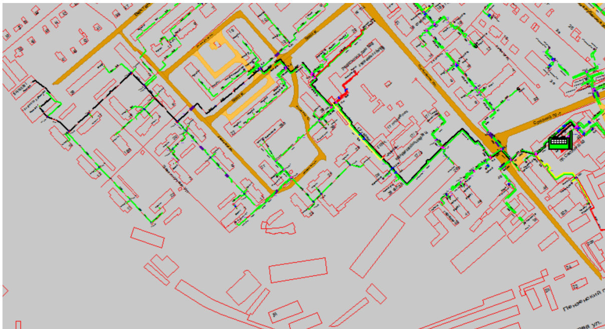
Рисунок 1.65 Результат гидравлического расчета - расчетный путь теплоносителя от котельной пр. Союзный, 43 до ПТ-Замкнут,15 э3
