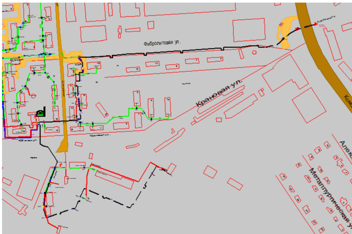
Рисунок 1.83 Результат гидравлического расчета - расчетный путь теплоносителя от котельной Московское шоссе, 62 до ПТ-Актьюб.17м.
