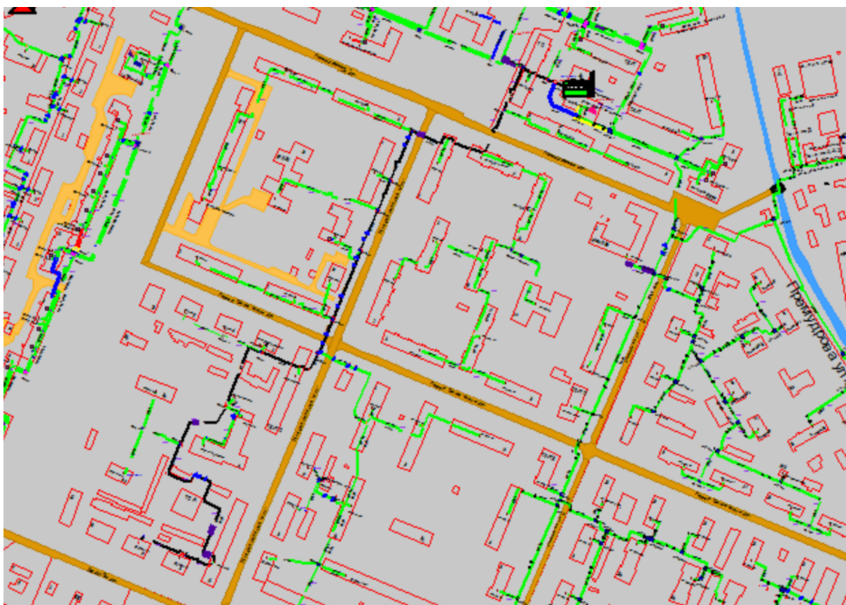
Рисунок 1.113 Результат гидравлического расчета - расчетный путь теплоносителя от котельной Премудрова, 12а до ПТ-Дружбы, 11
