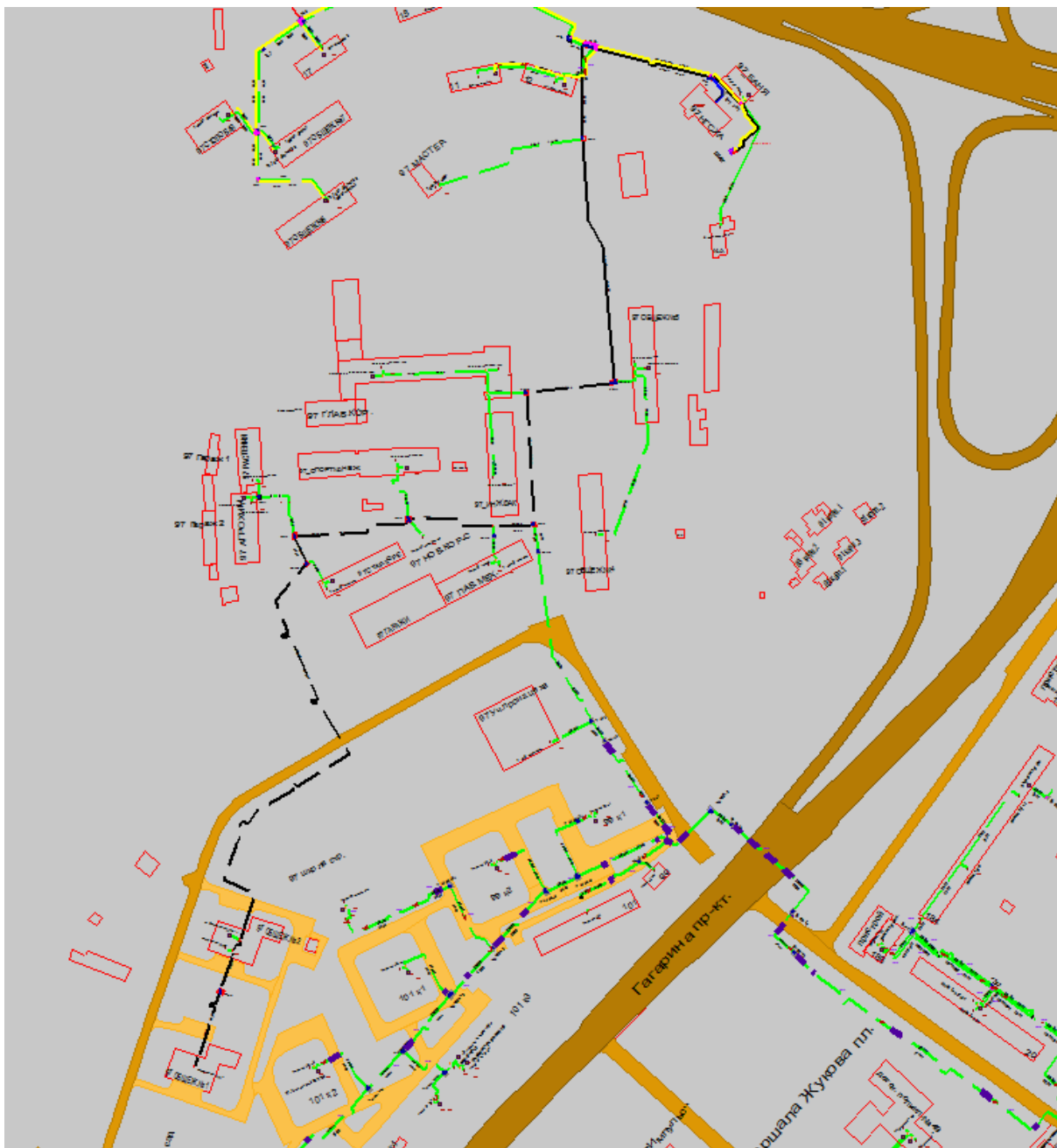
Рисунок 1.31 Результат гидравлического расчета - расчетный путь теплоносителя от котельной пр. Гагарина, 97 до ПТ-Гагар,97 общ.№1
