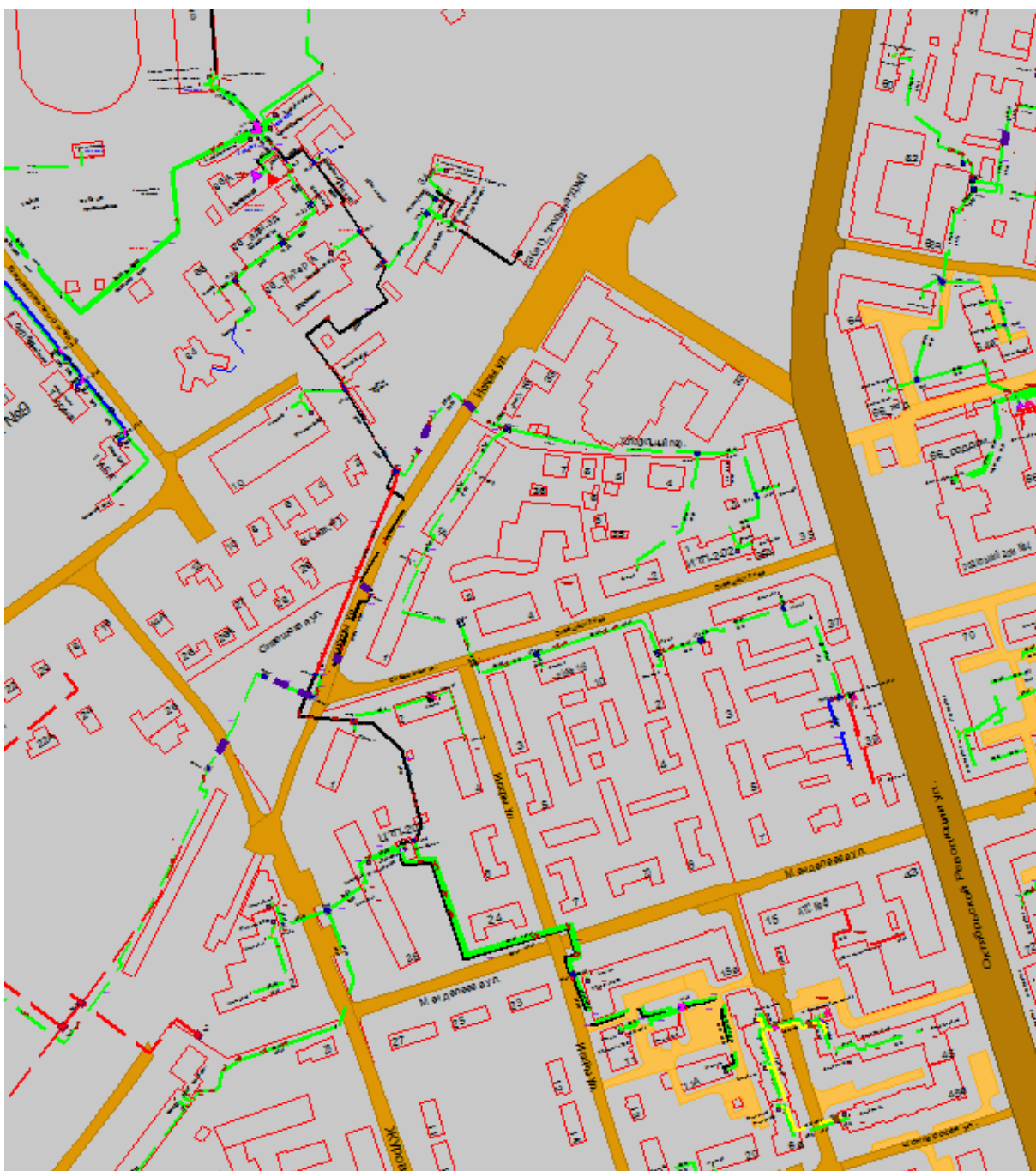
Рисунок 1.37 Результат гидравлического расчета - расчетный путь теплоносителя от котельной Климковская, 86а до ПТ-Искры,11а
