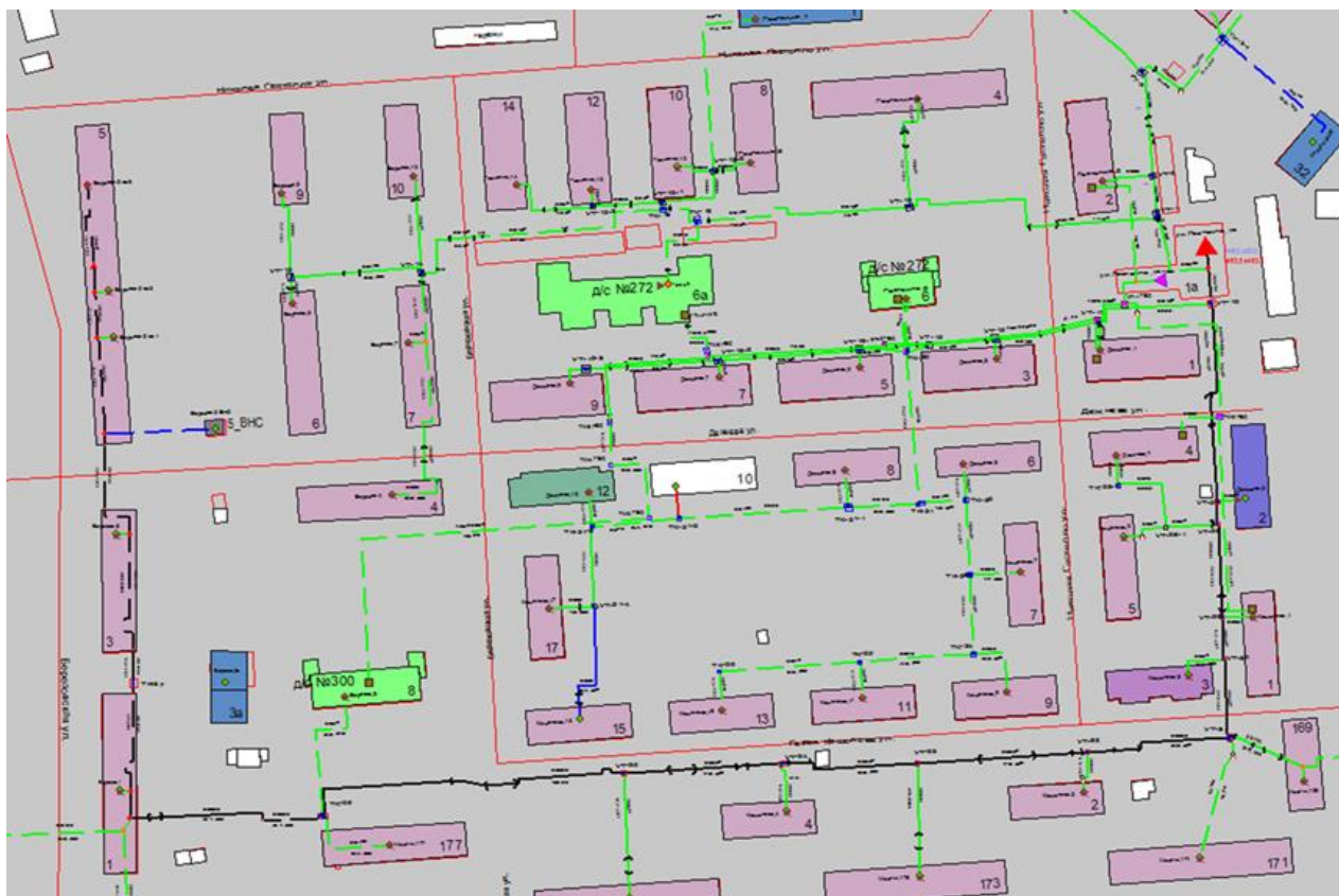
Рисунок Ошибка! Текст указанного стиля в документе отсутствует..21 – Трассировка теплопровода от котельной АО «Теплоэнерго» по ул. Гастелло, д. 1А до конечного потребителя «ПТ-Березов,5 вв3»
