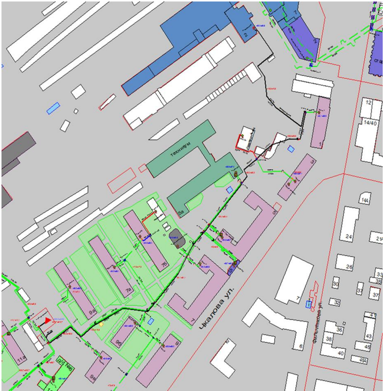
Рисунок 3.91 – Трассировка теплопровода от котельной АО «Теплоэнерго» по ул. Чкалова, д. 9Г до конечного потребителя «ПТ-Революц.пл,2»
