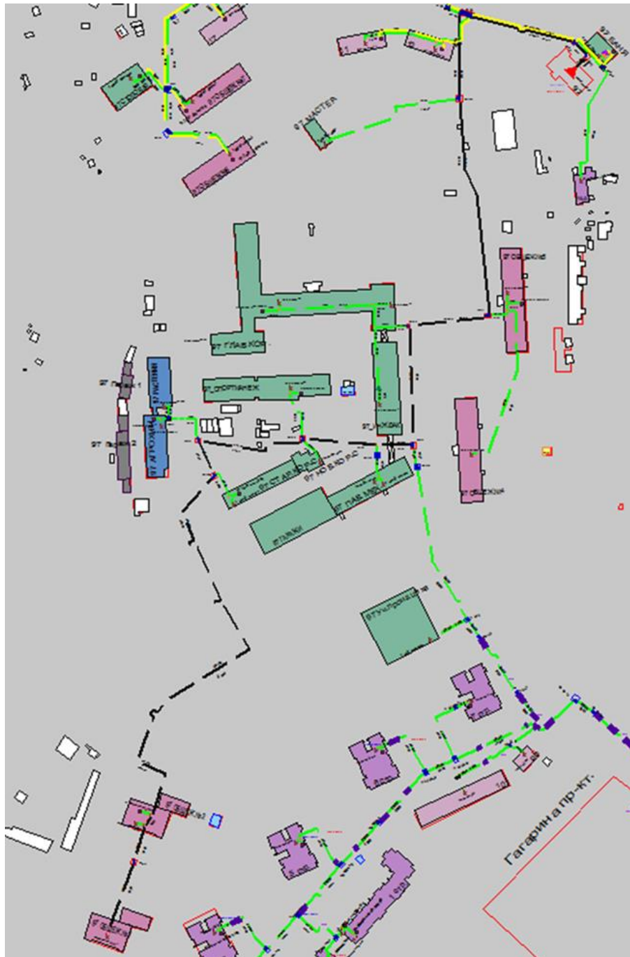
Рисунок 3.41 – Трассировка теплопровода от котельной АО «Теплоэнерго» пр. Гагарина, д. 97 до конечного потребителя «ПТ-Гагар,97 общ.№1»
