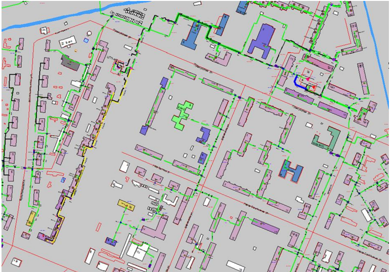
Рисунок 3.105 – Трассировка теплопровода от котельной АО «Теплоэнерго» по ул. Премудрова, д. 12А до конечного потребителя «ПТ-Днепр,16 э4»
