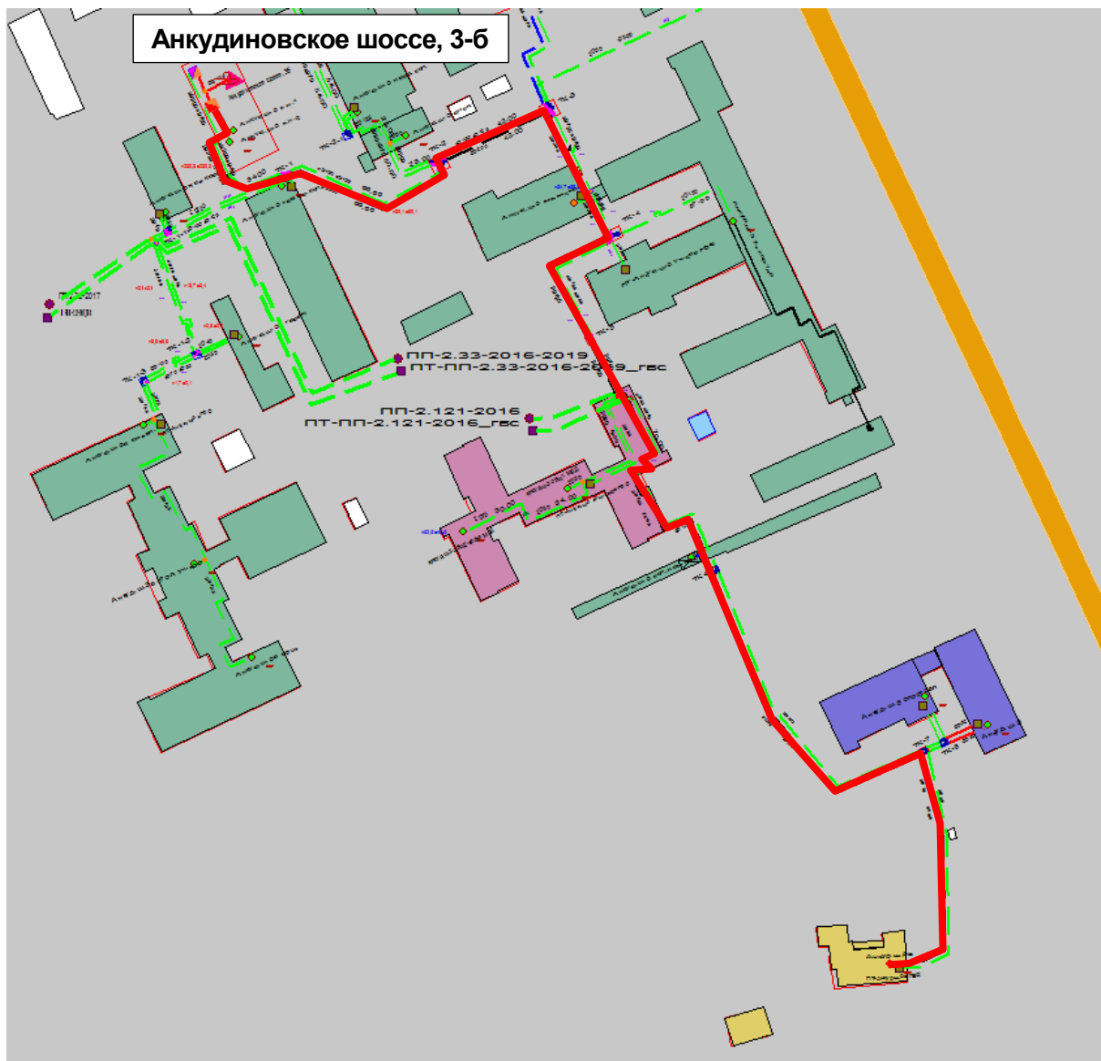
Рисунок 1.105 – Результат гидравлического расчета - расчетный путь теплоносителя от котельной Анкудиновское шоссе, 3-б до ПТ-Анкуд.ш,5а
