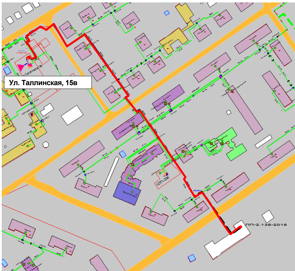
Рисунок 1.123 – Результат гидравлического расчета - расчетный путь теплоносителя от котельной Таллинская, 15в до ОТВ-009920
