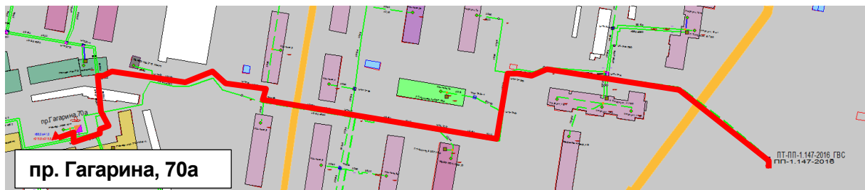
Рисунок 1.55 – Результат гидравлического расчета - расчетный путь теплоносителя от котельной пр. Гагарина, 70а до ПТ-ПП-1.147-2016
