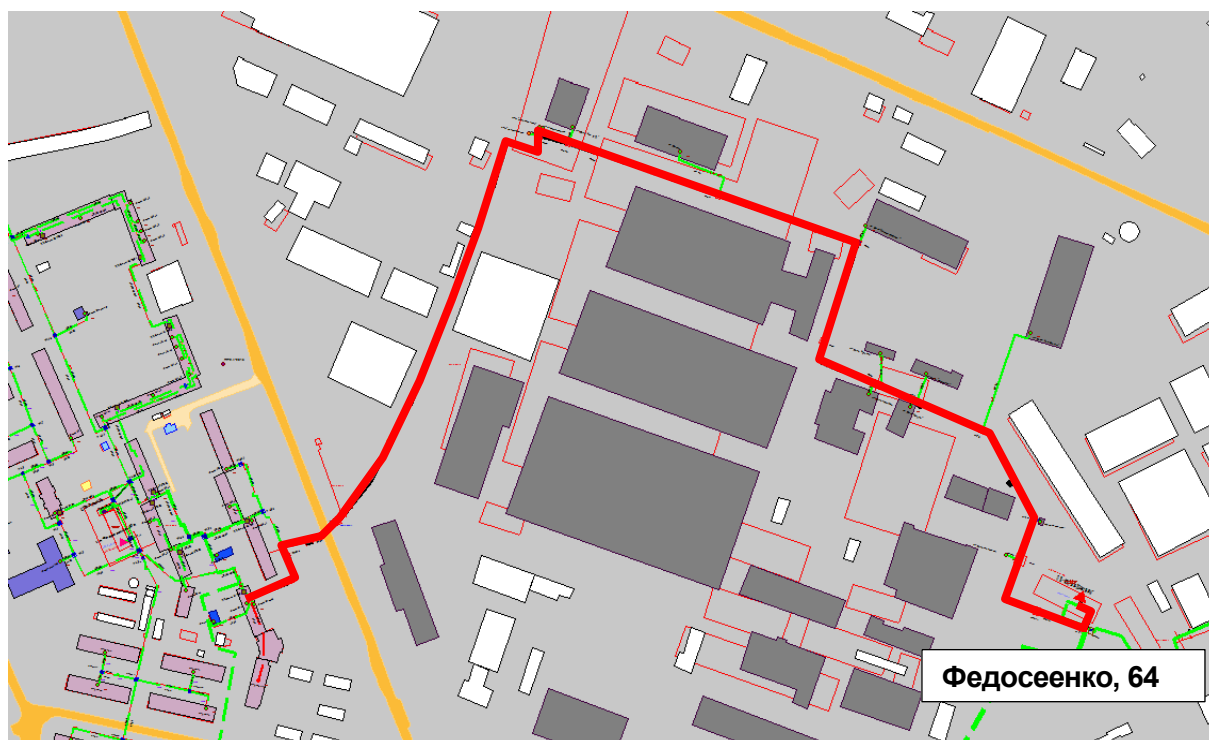
Рисунок 1.109 – Результат гидравлического расчета - расчетный путь теплоносителя от котельной ФГУП «Завод «Электромаш» до ПТ-Федос,87 э2
