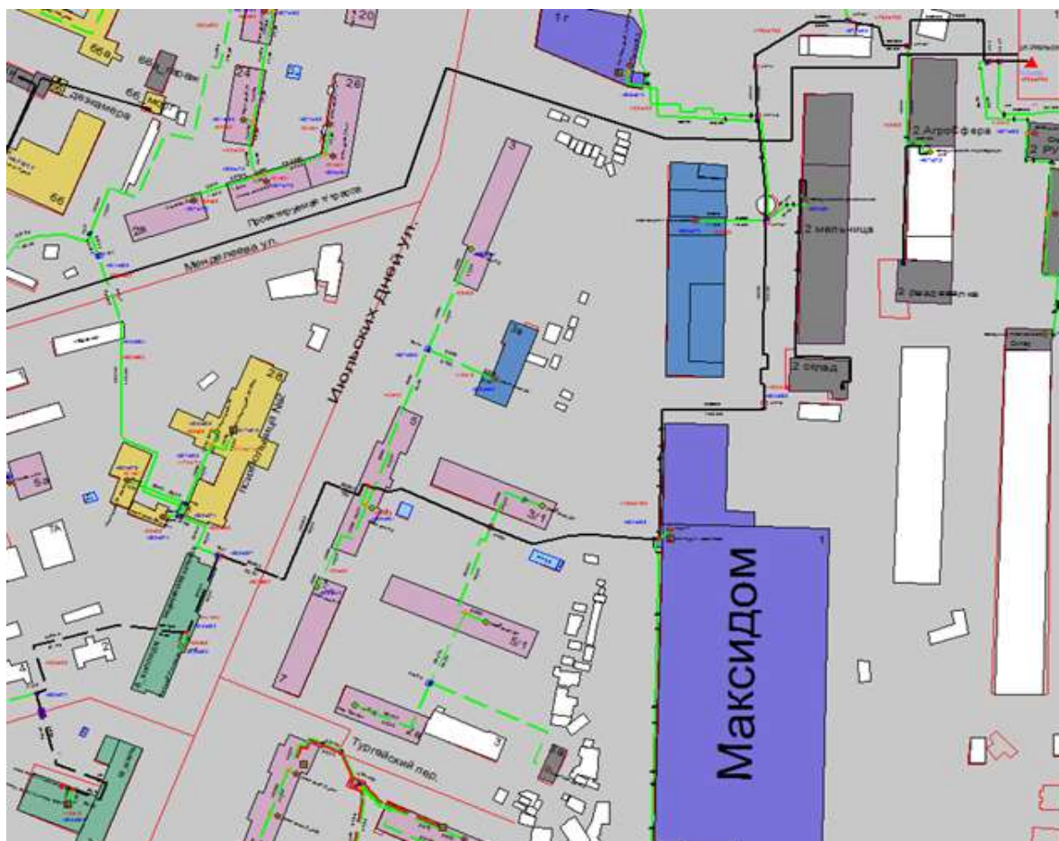
Рисунок 1.23 Результат гидравлического расчета - расчетный путь теплоносителя от Июльских дней, 1 до ПТ-Июль.дней,10 школа
