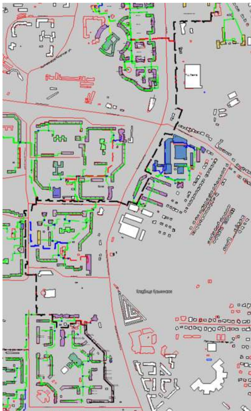
Рисунок 1.69 Результат гидравлического расчета - расчетный путь теплоносителя от котельной ул. Родионова, 1946 до ПТ-Богдан.1 пр
