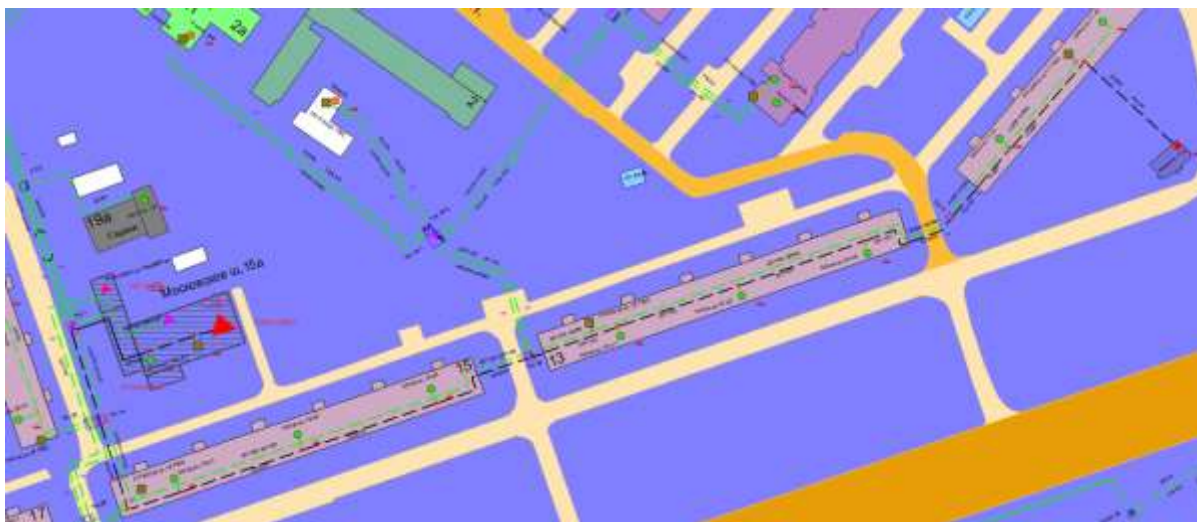
Рисунок 1.27 Результат гидравлического расчета - расчетный путь теплоносителя от котельной Московское шоссе, 15а до ПТ-Моск.ш,11а
