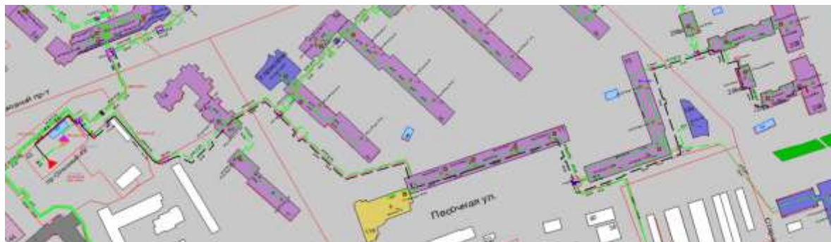
Рисунок 1.61 Результат гидравлического расчета - расчетный путь теплоносителя от котельной пр. Союзный, 43 до ПТ-Комин,256 э2
