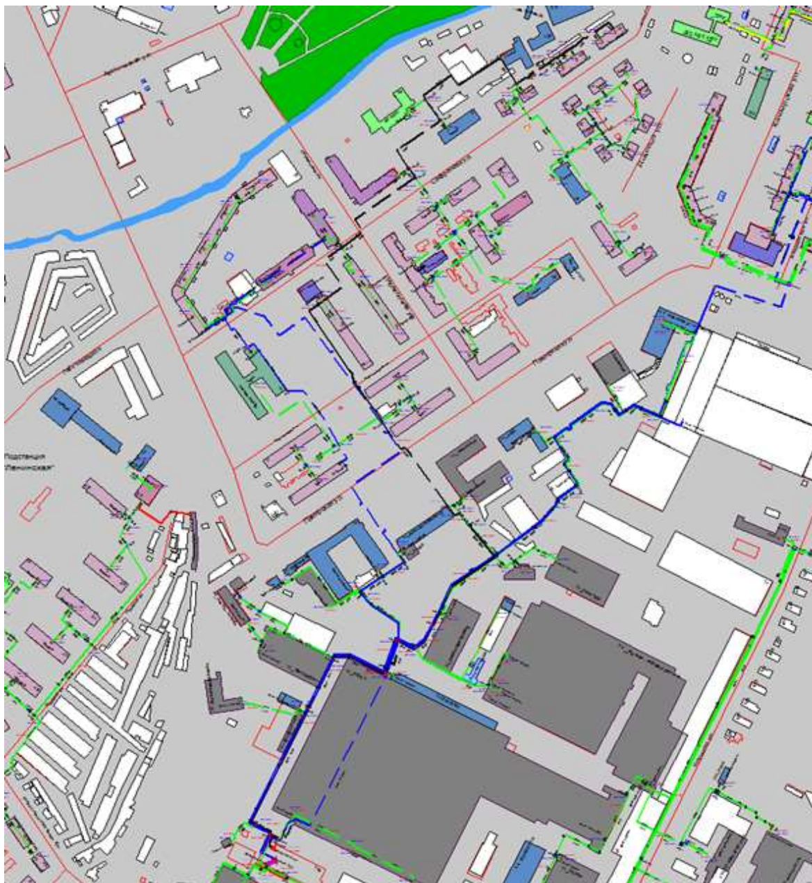
Рисунок 1.13 Результат гидравлического расчета - расчетный путь теплоносителя от котельной Памирская, 11 до ПТ-Сафрон,15 вв2
