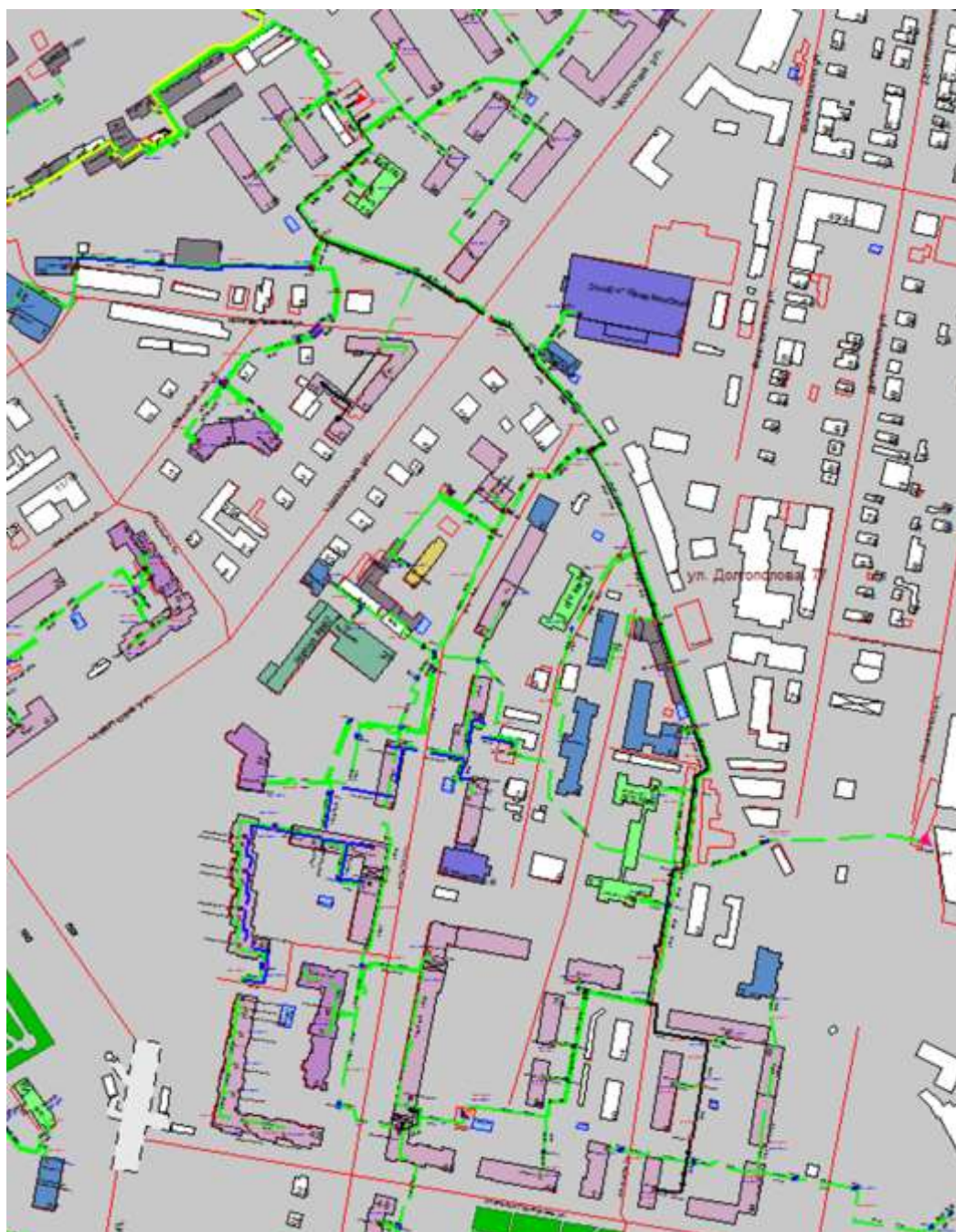
Рисунок 1.97 Результат гидравлического расчета - расчетный путь теплоносителя от котельной Чкалова, 9д до ПТ-Вольск,8
