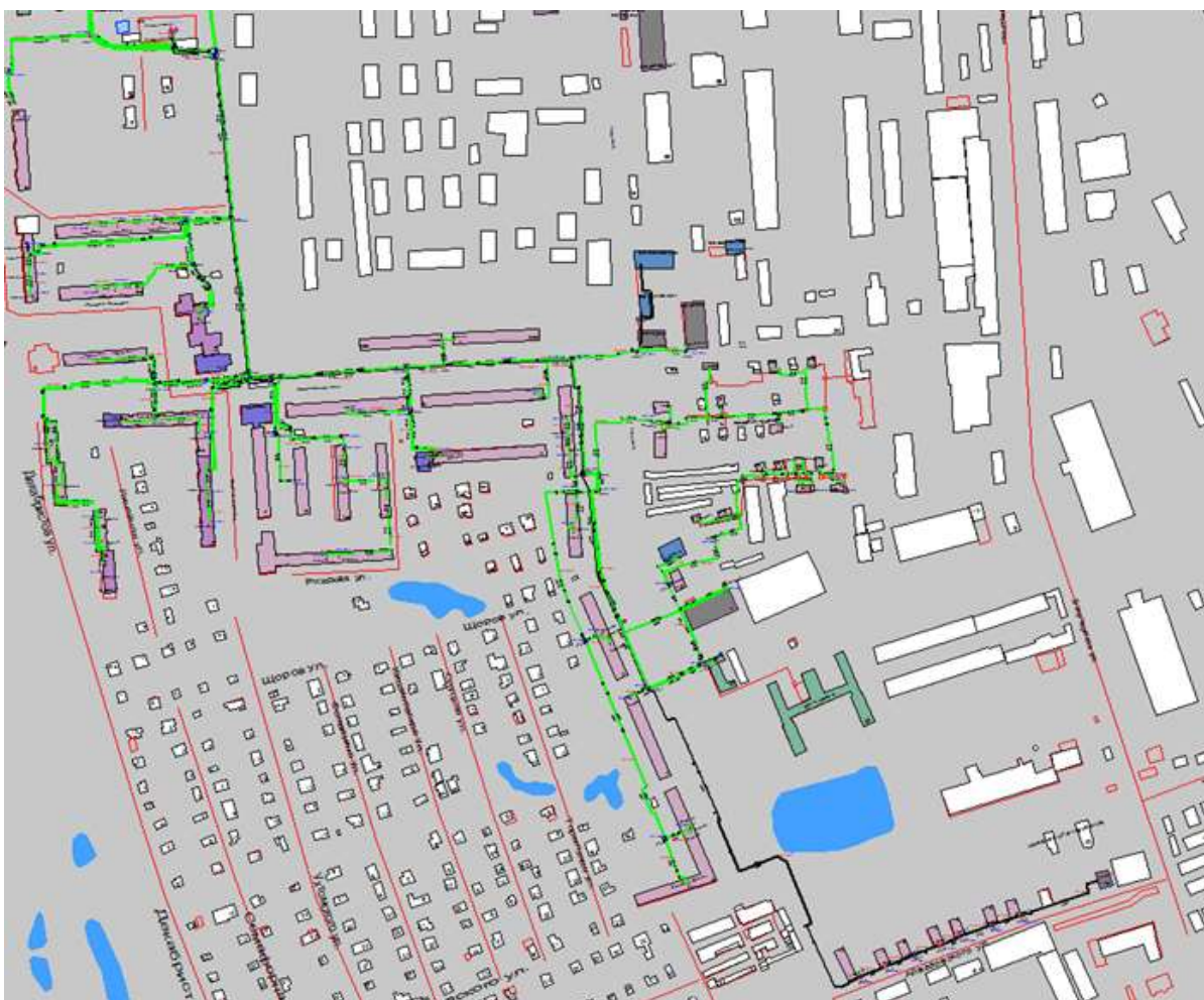
Рисунок 1.17 Результат гидравлического расчета - расчетный путь теплоносителя от котельной Лесной городок, 6в до ПТ-Вторчер,6а
