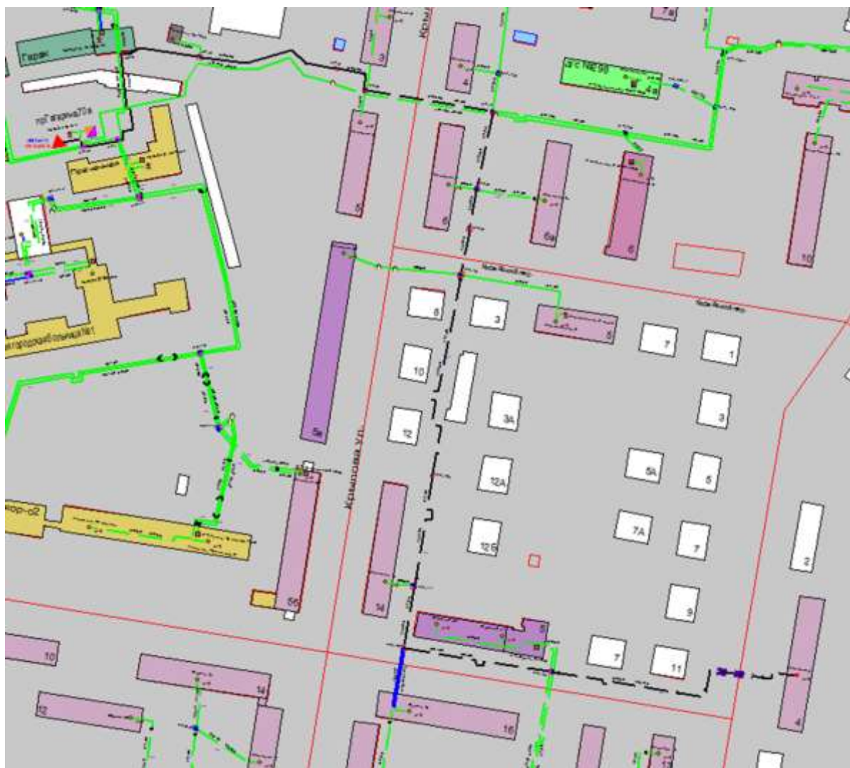
Рисунок 1.45 Результат гидравлического расчета - расчетный путь теплоносителя от котельной пр. Гагарина, 70а до ПТ-Корейск,4
