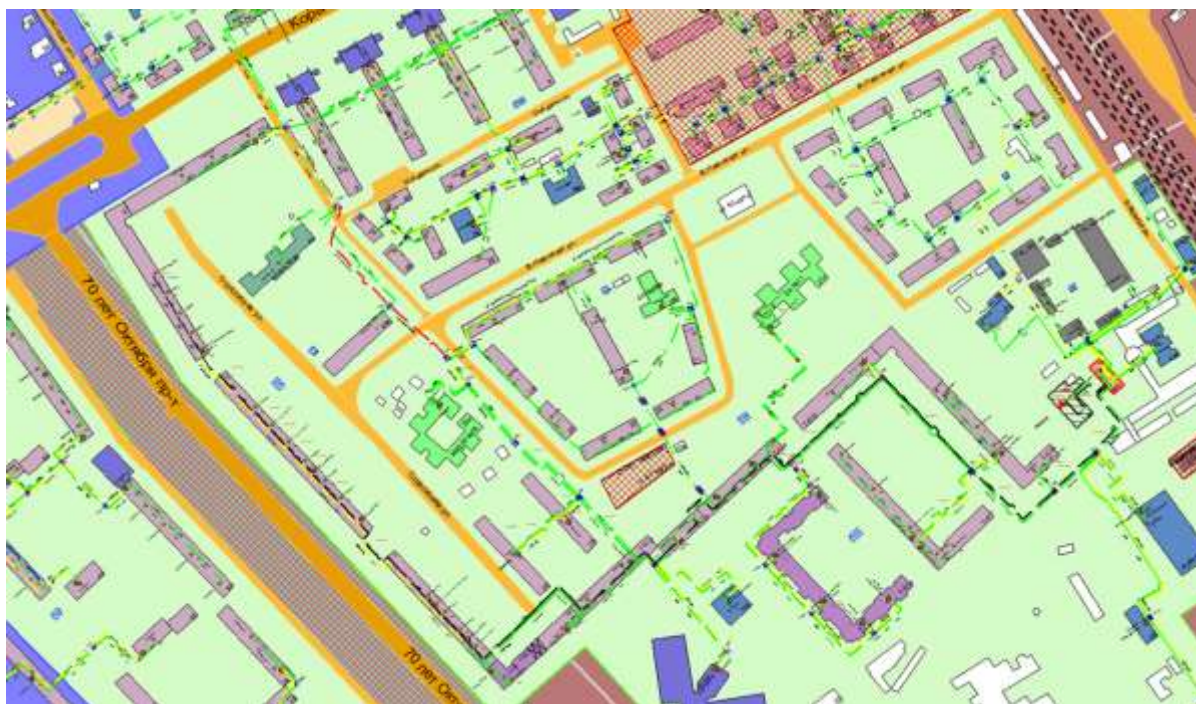
Рисунок 1.75 Результат гидравлического расчета - расчетный путь теплоносителя от котельной ул. Иванова, 14д до ПТ-Телег.3_э5
