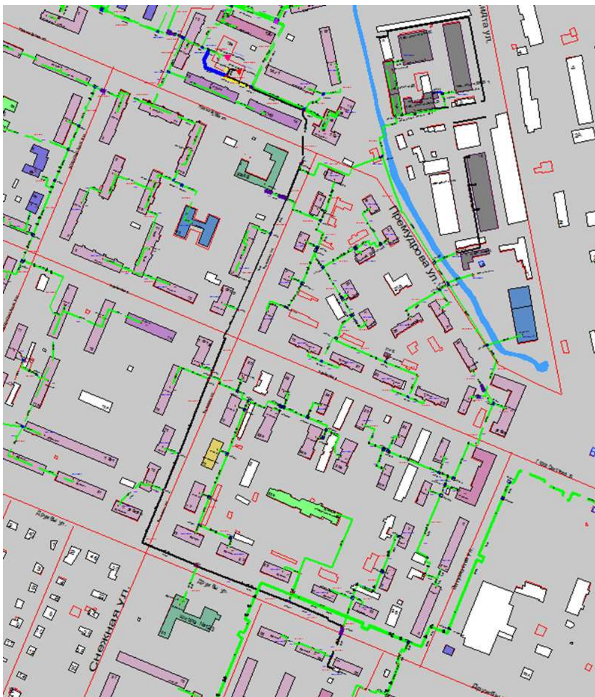
Рисунок 1.107 Результат гидравлического расчета - расчетный путь теплоносителя от котельной Премудрова, 12а до ПТ-Дружбы,56
