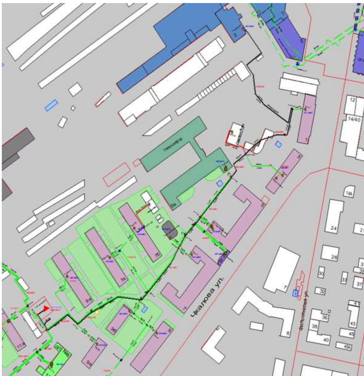
Рисунок 1.95 Результат гидравлического расчета - расчетный путь теплоносителя от котельной Чкалова, 9д до ПТ-Революц.пл,2
