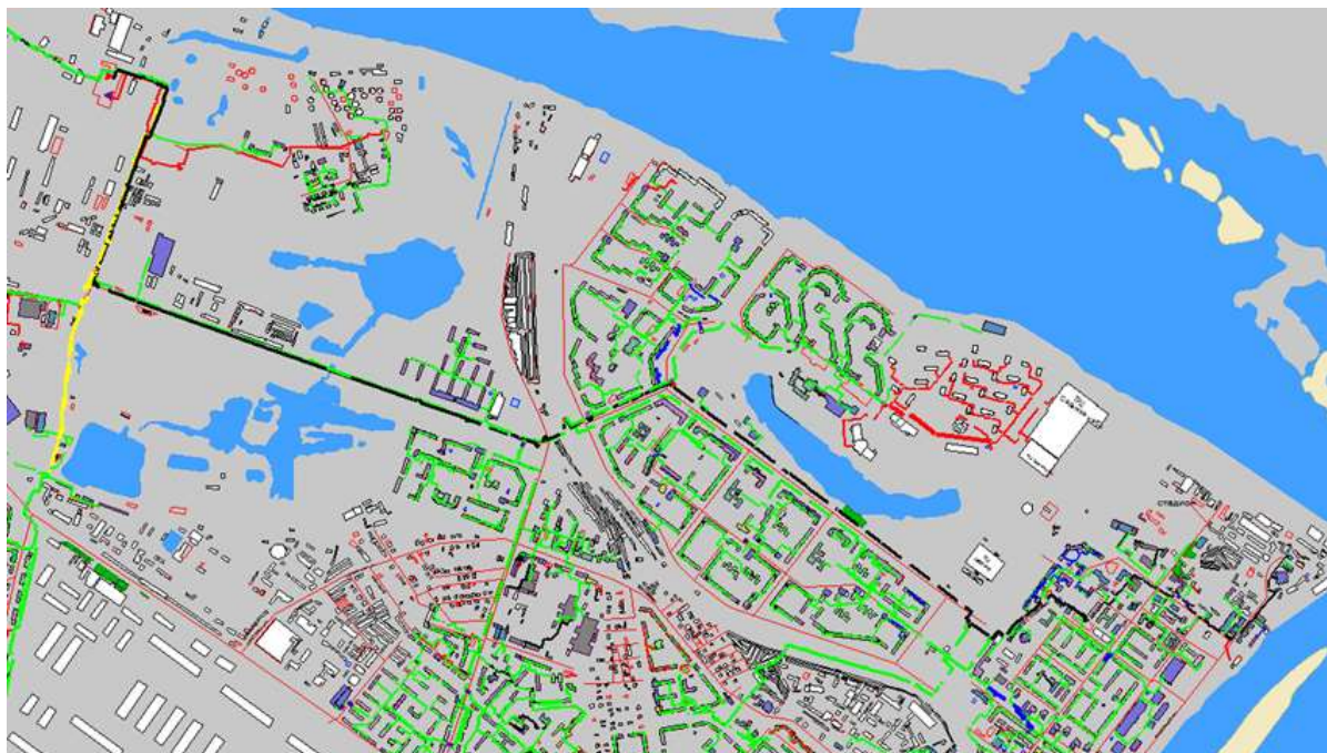
Рисунок 1.5 Результат гидравлического расчета - расчетный путь теплоносителя от СТЭЦ до ПТ-Стрел,19
