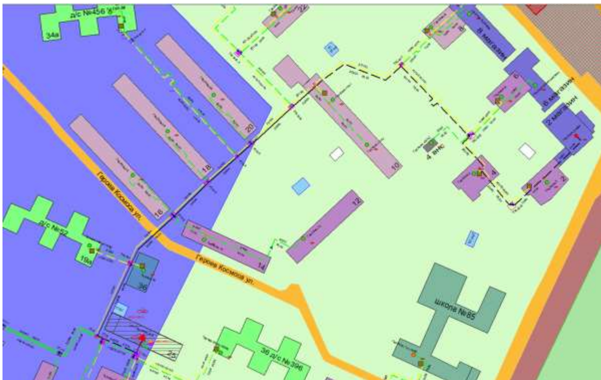
Рисунок 1.73 Результат гидравлического расчета - расчетный путь теплоносителя от котельной ул. Гаугеля, 25 до ПТ-Гаугеля,1 до ПТ-Гер.Косм,2 кафе
