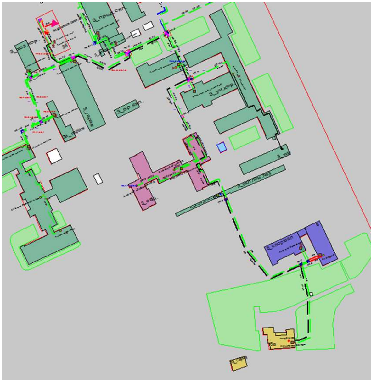
Рисунок 1.91 Результат гидравлического расчета - расчетный путь теплоносителя от котельной Анкудиновское шоссе, 3-б до ПТ-Анкуд.ш,5а
