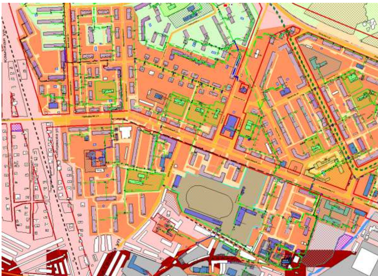
Рисунок 1.93 Результат гидравлического расчета - расчетный путь теплоносителя от котельной Чаадаева, 10 до ПТ-Мечн,63.
