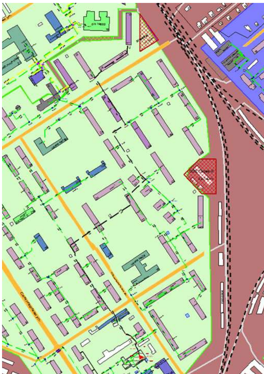
Рисунок 1.43 Результат гидравлического расчета - расчетный путь теплоносителя от котельной Станиславского, 3 до ПТ-Мокр,17
