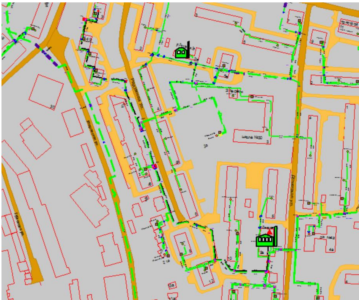
Рисунок Ошибка! Текст указанного стиля в документе отсутствует..227 Результат гидравлического расчета - расчетный путь теплоносителя от котельной Донецкая, 9в до ПТ-Радуж,3
