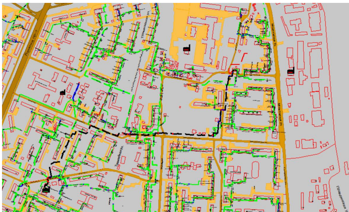
Рисунок Ошибка! Текст указанного стиля в документе отсутствует..7 Результат гидравлического расчета - расчетный путь теплоносителя от котельной Академика Баха, 4-а до ПТ-Мотал,6
