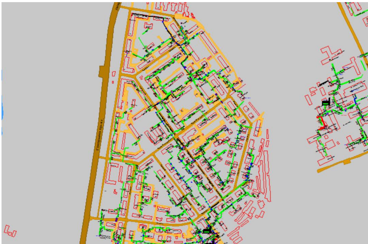
Рисунок Ошибка! Текст указанного стиля в документе отсутствует..29 Результат гидравлического расчета - расчетный путь теплоносителя от котельной Батумская, 7-б до ПТ-Гагар.пр,104 э2
