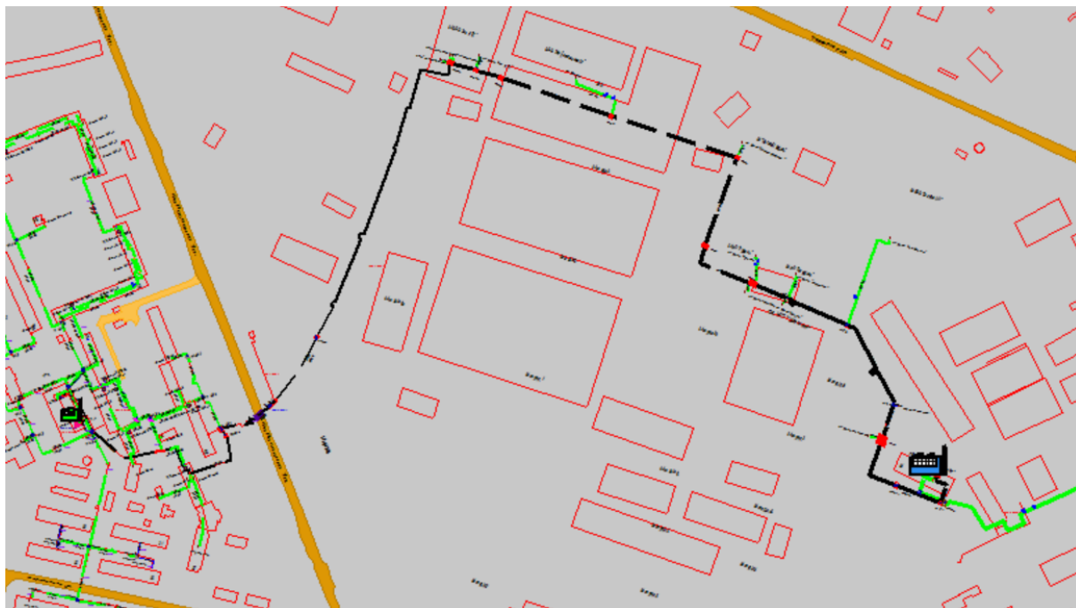
Рисунок Ошибка! Текст указанного стиля в документе отсутствует..211 Результат гидравлического расчета - расчетный путь теплоносителя от котельной Федосеенко, 64 до ЦТП-ул.Федосеен,89а
