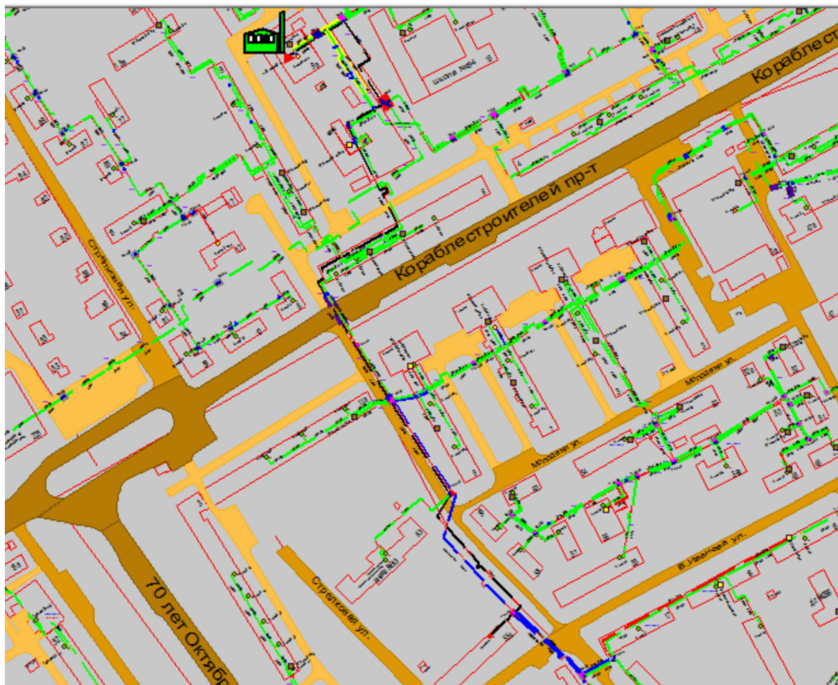
Рисунок Ошибка! Текст указанного стиля в документе отсутствует..71 Результат гидравлического расчета - расчетный путь теплоносителя от котельной Баренца, 9а до ПТ-Иван.55а
