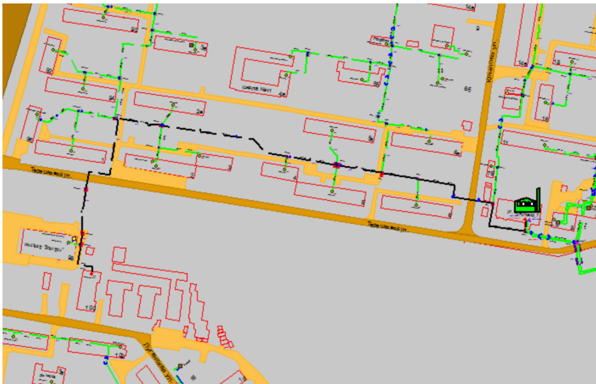
Рисунок Ошибка! Текст указанного стиля в документе отсутствует..219 Результат гидравлического расчета - расчетный путь теплоносителя от котельной Терешковой, 7 до ПТ-Гагар.пр,100
