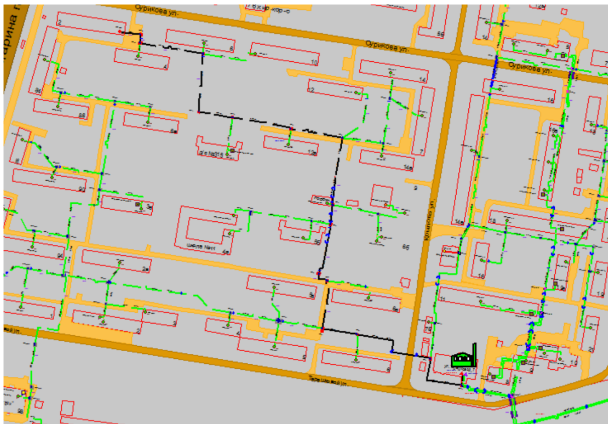
Рисунок Ошибка! Текст указанного стиля в документе отсутствует..221 Результат гидравлического расчета - расчетный путь теплоносителя от котельной Терешковой, 7 до ПТ-Сурик,2
