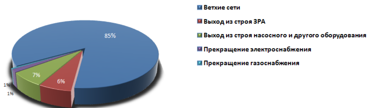
Рисунок 9.7 – Структура причин технологических нарушений теплоснабжения объектов ЖКХ Автозаводского РТС в отопительных периодах 2008 ÷ 2012 гг.
