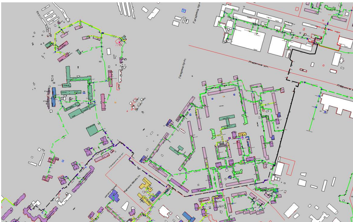
Рисунок 1.57 – Результат гидравлического расчета - расчетный путь теплоносителя от котельной пр. Гагарина, 1786 до ПТ-Гагар.пр,101/5 ИТП №2
