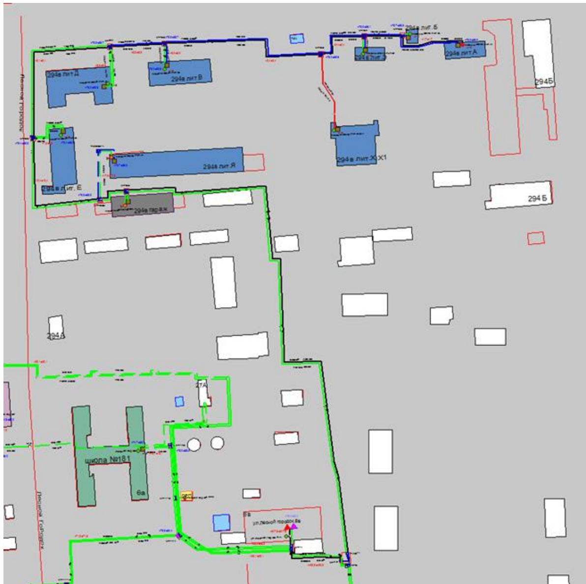
Рисунок 1.19 – Результат гидравлического расчета - расчетный путь теплоносителя от котельной Лесной городок, 6в до ПТ-Моск.ш,294в лит.А
