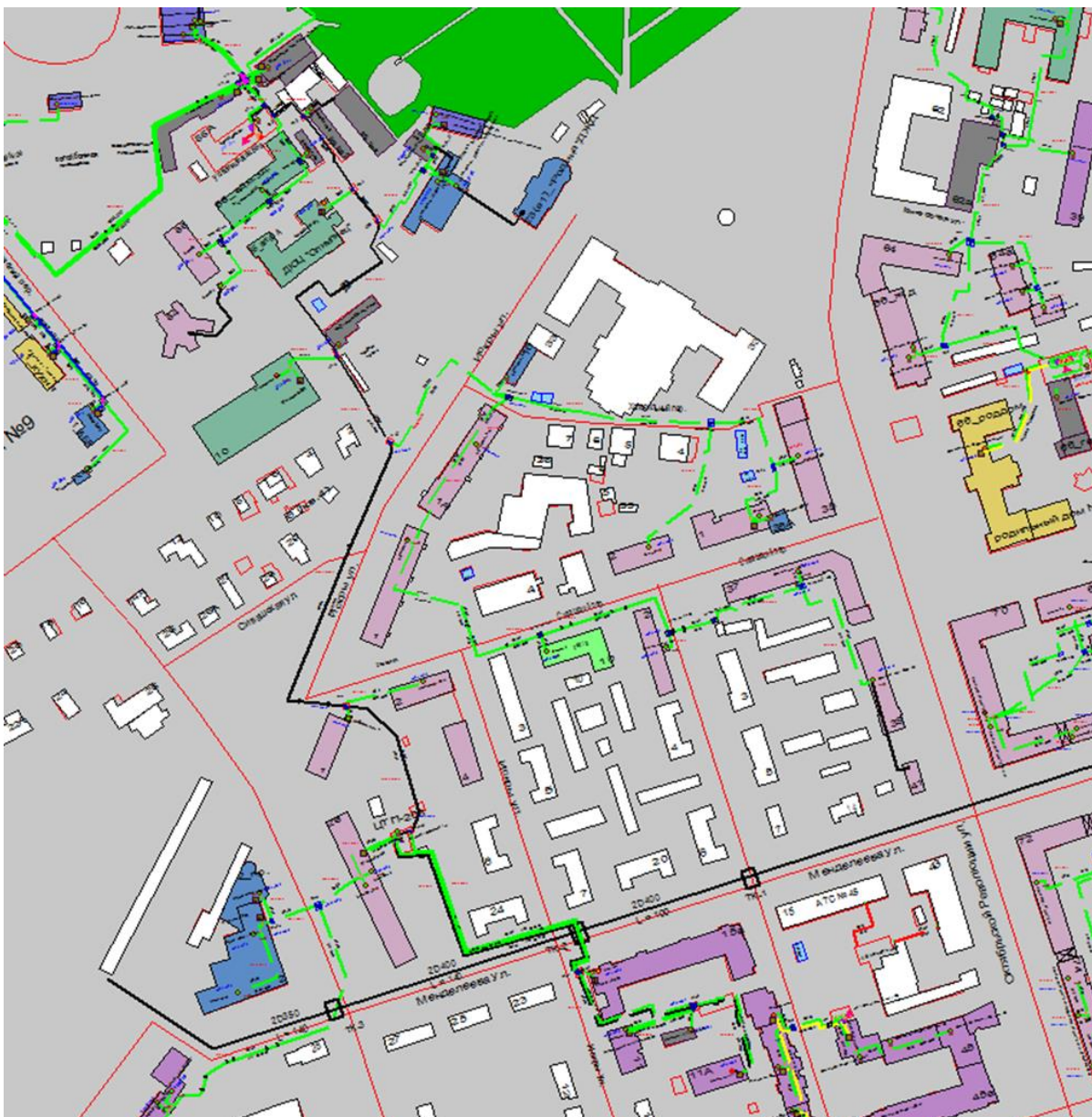
Рисунок 1.37 – Результат гидравлического расчета - расчетный путь теплоносителя от котельной Климовская, 86а до ПТ-Искры,11а
