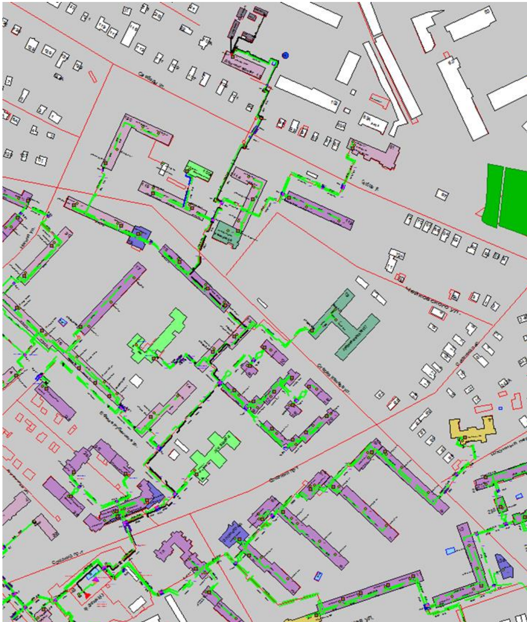
Рисунок 1.63 – Результат гидравлического расчета - расчетный путь теплоносителя от котельной пр. Союзный, 43 до ПТ-Радищ,18
