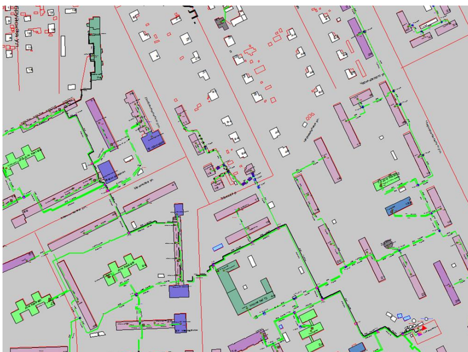
Рисунок 1.33 – Результат гидравлического расчета - расчетный путь теплоносителя от котельной Баранова, 11 до ПТ-Мечн,74 маст
