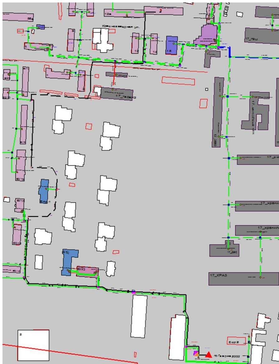
Рисунок 1.181 – Результат гидравлического расчета - расчетный путь теплоносителя от котельной Гагарина, 60 корп. 22 до ПТ-Краснозв,12а вв2
