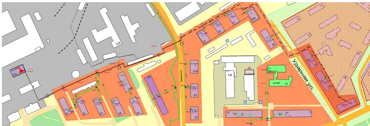
Рисунок 1.219 – Результат гидравлического расчета - расчетный путь теплоносителя от котельной Федосеенко, 44а до ПТ-Федос,7
