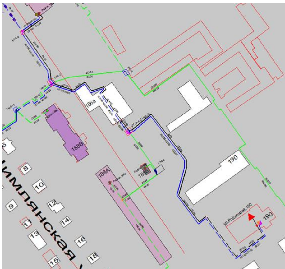
Рисунок 1.221– Результат гидравлического расчета - расчетный путь теплоносителя от котельной Родионова, 190 до ПТ-Родион,186б
