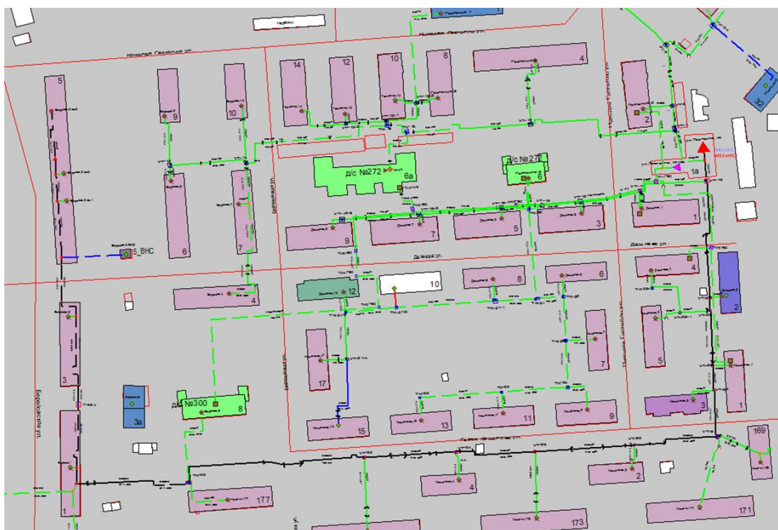
Рисунок 1.141 – Результат гидравлического расчета - расчетный путь теплоносителя от котельной Гастелло, 1-а до ПТ-Березов,5 вв3
