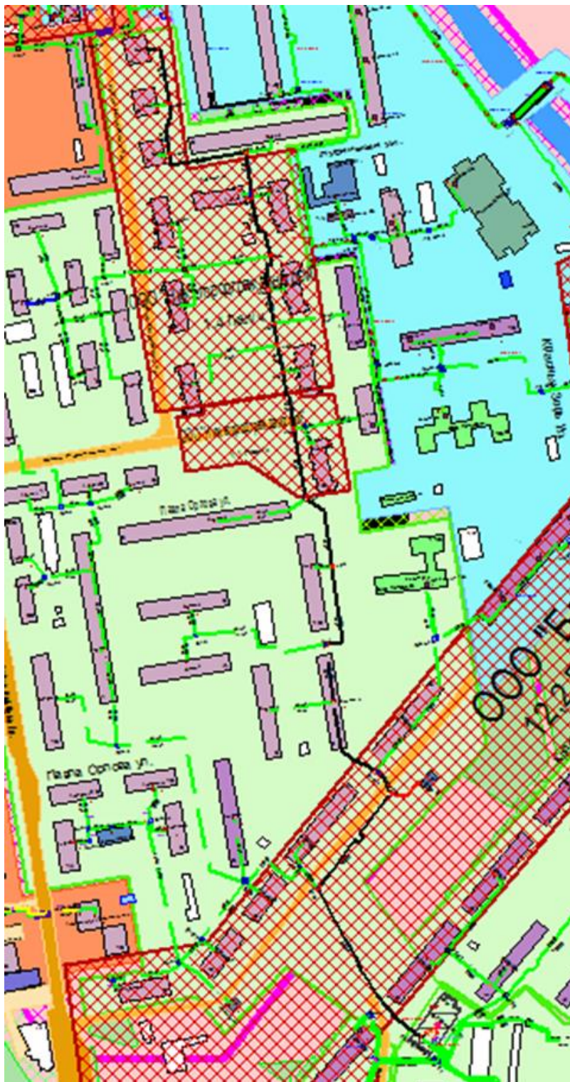
Рисунок 1.203 – Результат гидравлического расчета - расчетный путь теплоносителя от котельной Красных Зорь, 4а до ПТ-Давыд,11
