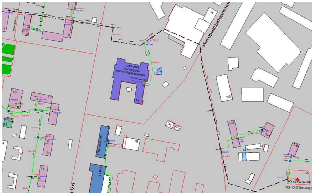
Рисунок 1.247 – Результат гидравлического расчета - расчетный путь теплоносителя от котельной Интернациональная, 95 до ПТ-Вольск,11
