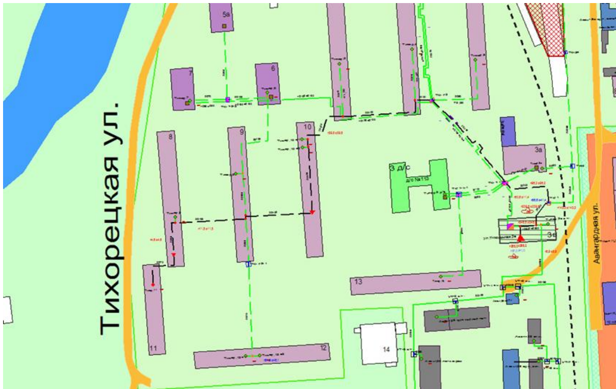
Рисунок 1.209 – Результат гидравлического расчета - расчетный путь теплоносителя от котельной Тихорецкая, 3в до ПТ-Тихор,11
