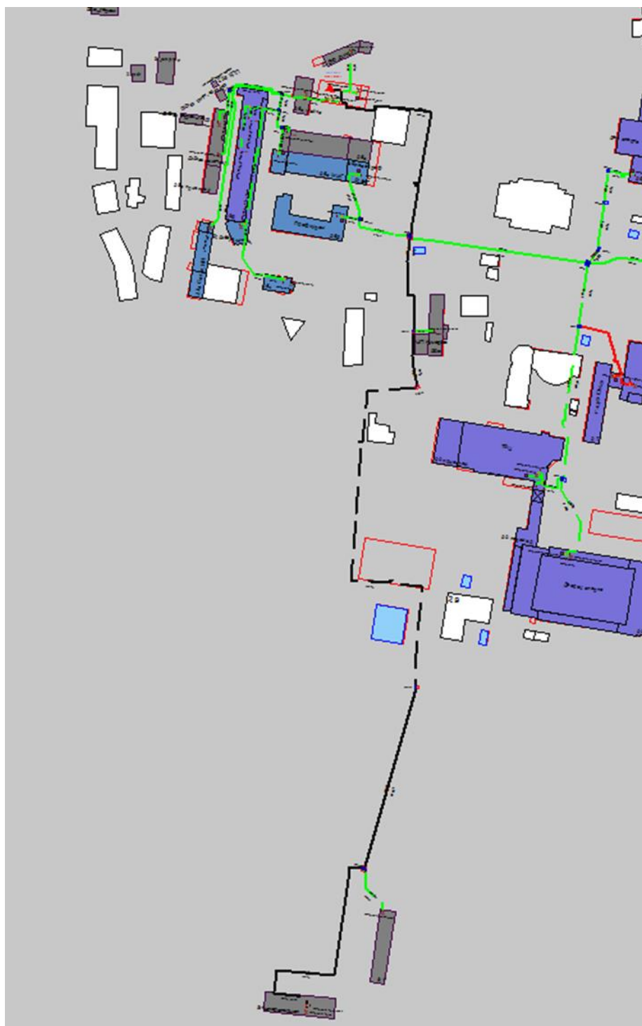
Рисунок 1.177– Результат гидравлического расчета - расчетный путь теплоносителя от котельной Гагарина, 25-е до ПТ-Гагар.пр,31 хлор
