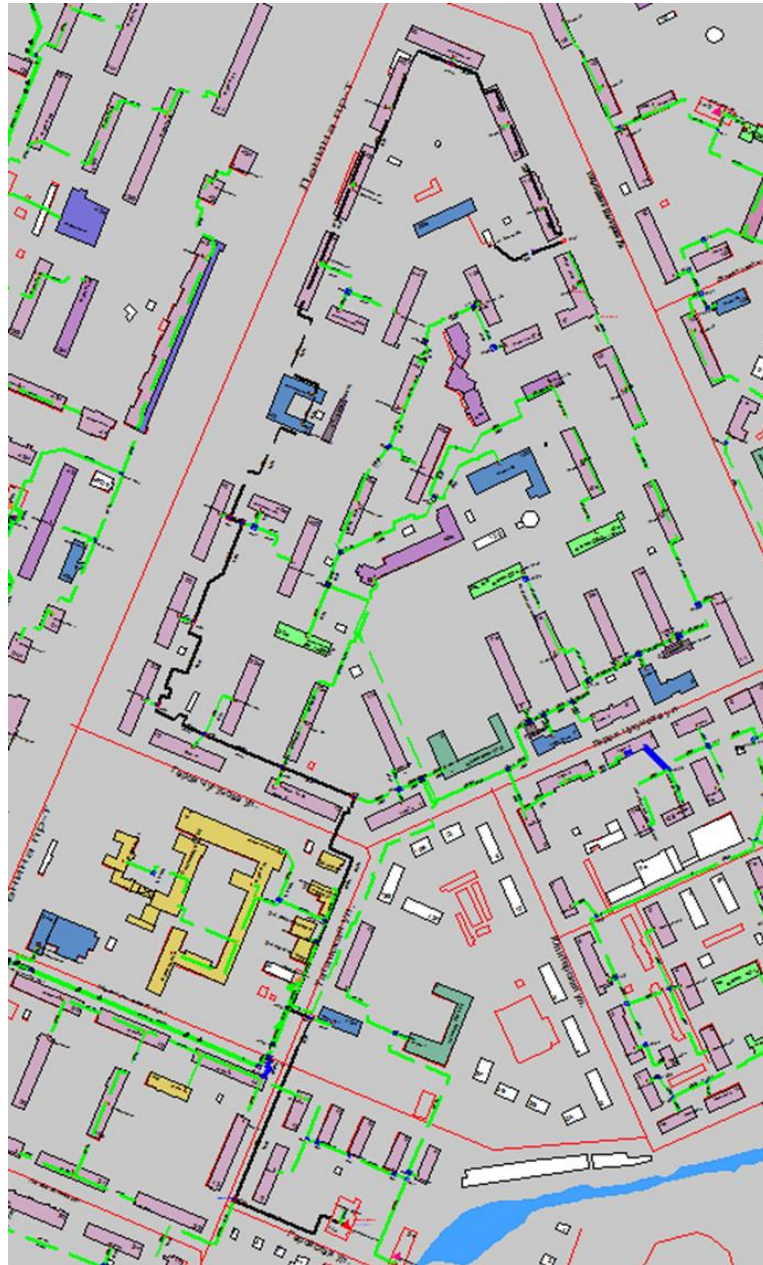
Рисунок 1.135– Результат гидравлического расчета - расчетный путь теплоносителя от котельной Геройская, 11-а до ПТ-пр. Ленина, 38а
