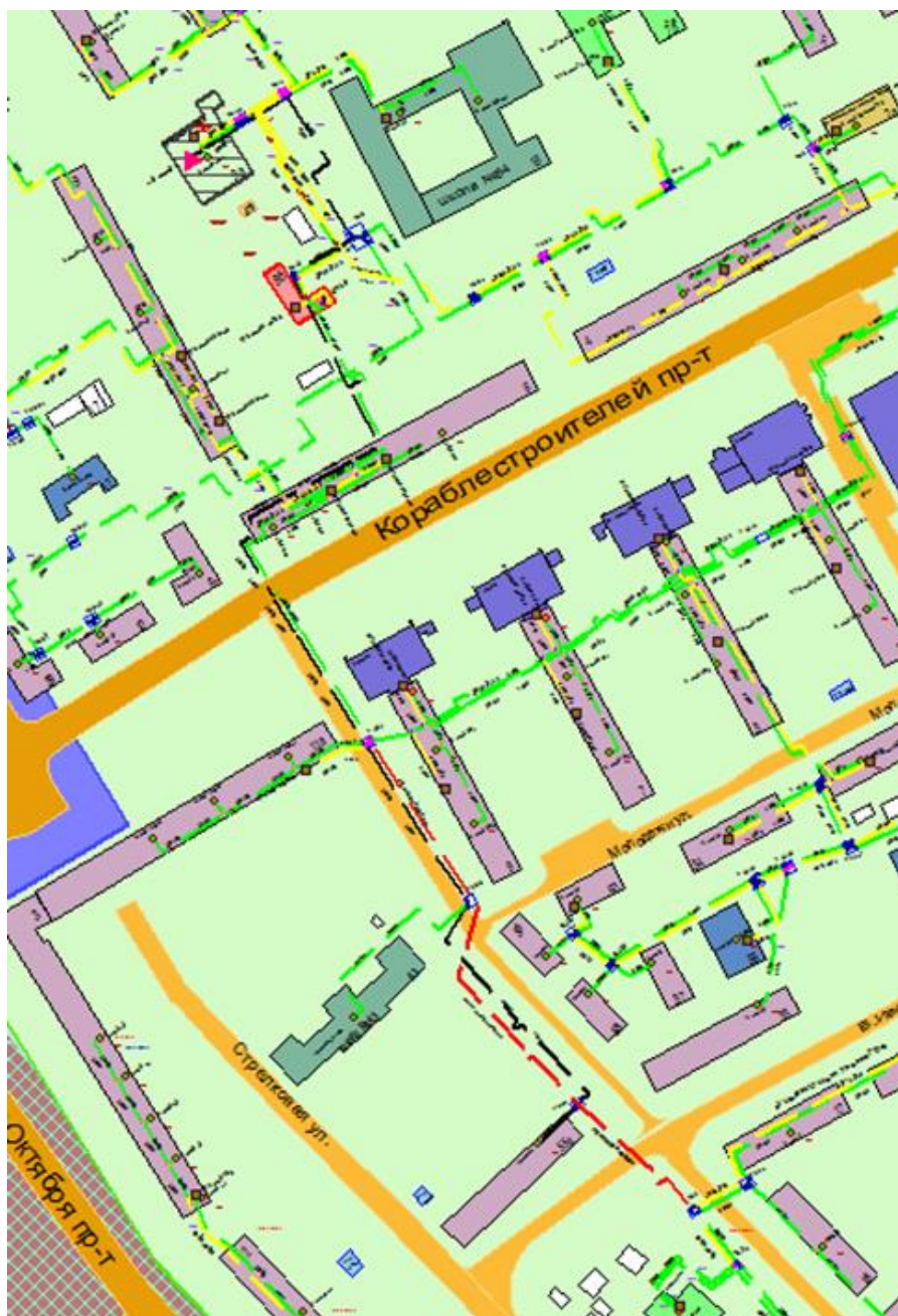
Рисунок 1.197 – Результат гидравлического расчета - расчетный путь теплоносителя от котельной Баренца, 9а до ПТ-Иван.55а
