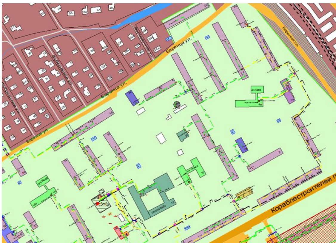
Рисунок 1.195 – Результат гидравлического расчета - расчетный путь теплоносителя от котельной Баренца, 9а до ПТ-Барен.3а
