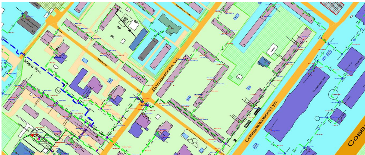
Рисунок 1.213 – Результат гидравлического расчета - расчетный путь теплоносителя от котельной Мурашкинская, 8 до ПТ-Совн,26 маг
