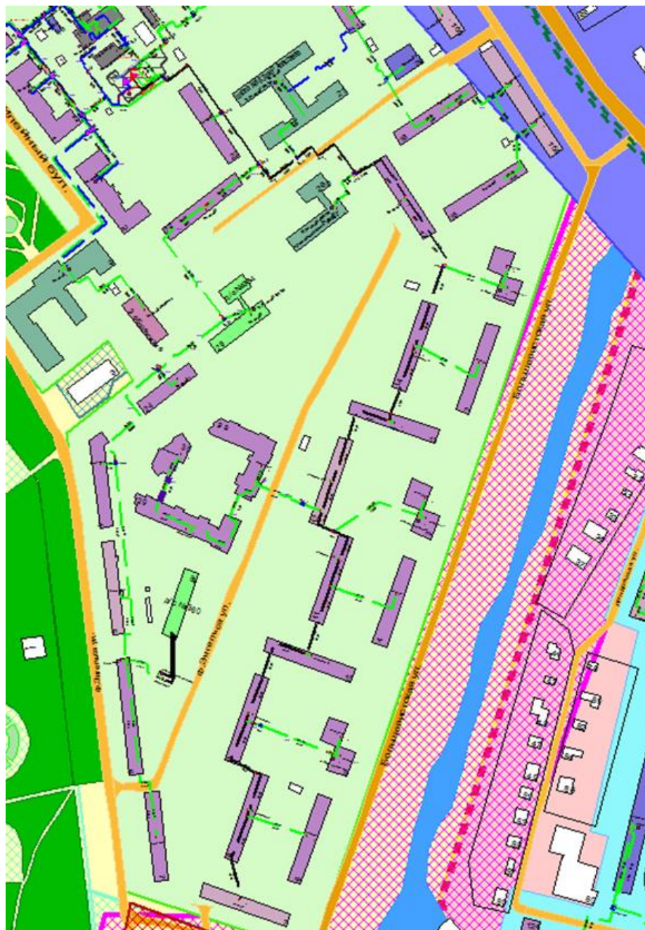
Рисунок 1.127 – Результат гидравлического расчета - расчетный путь теплоносителя от котельной Энгельса, 1-в до ПТ-Больш,7
