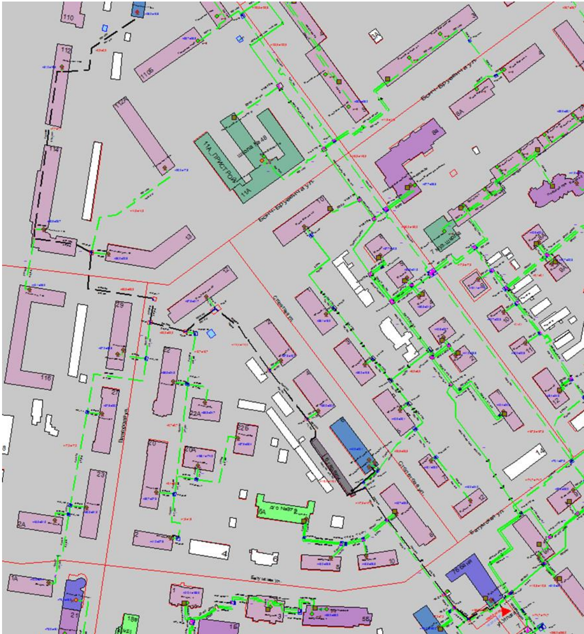
Рисунок 1.235 – Результат гидравлического расчета - расчетный путь теплоносителя от котельной Углова, 7 до ПТ-Гагар.пр,110в
