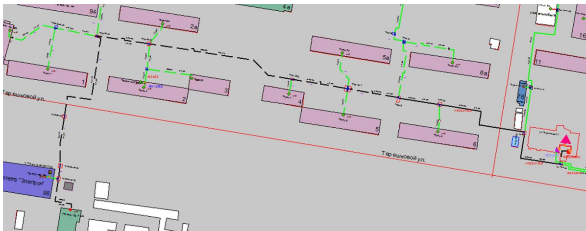
Рисунок 1.231 – Результат гидравлического расчета - расчетный путь теплоносителя от котельной Терешковой, 7 до ПТ-Гагар.пр,100
