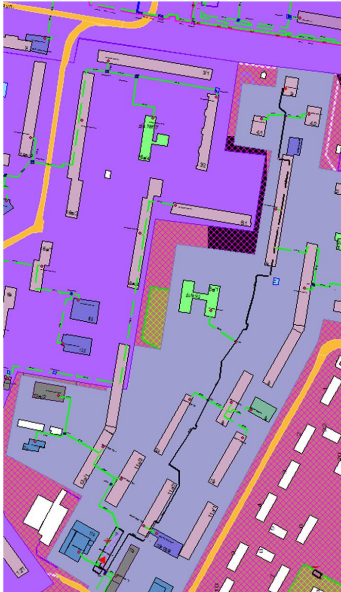
Рисунок 1.217 – Результат гидравлического расчета - расчетный путь теплоносителя от котельной Мончегорская, 11 до ПТ-Мончегорская,2а
