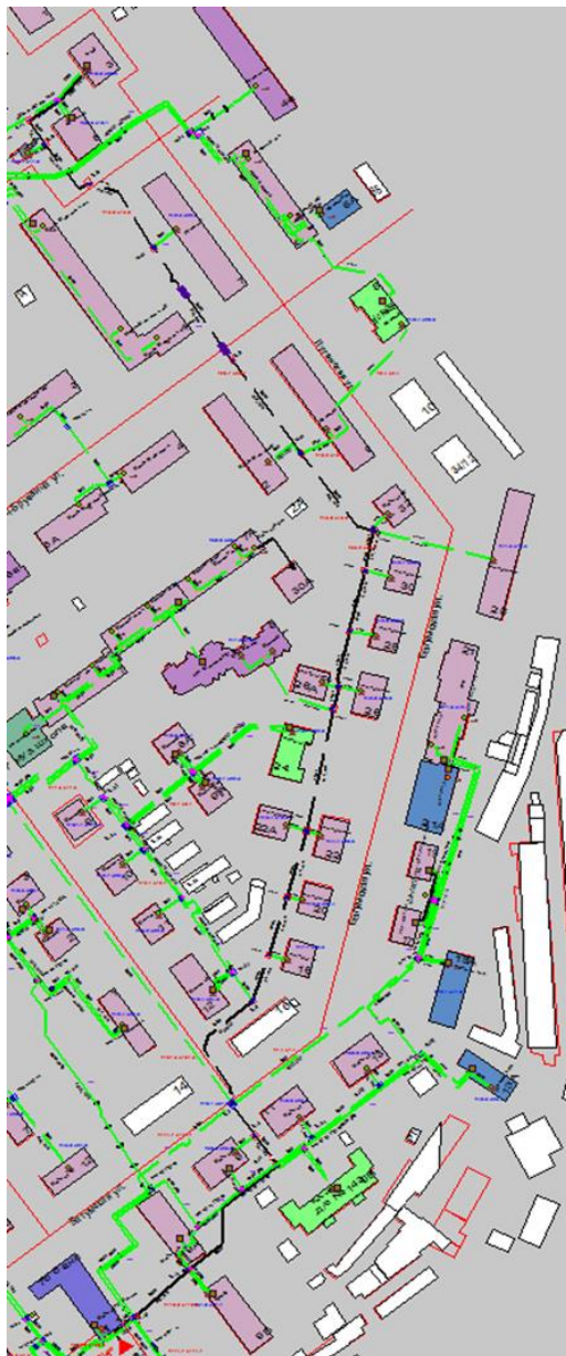
Рисунок 1.237 – Результат гидравлического расчета - расчетный путь теплоносителя от котельной ул. Углова, 7 до ПТ-Луган,3
