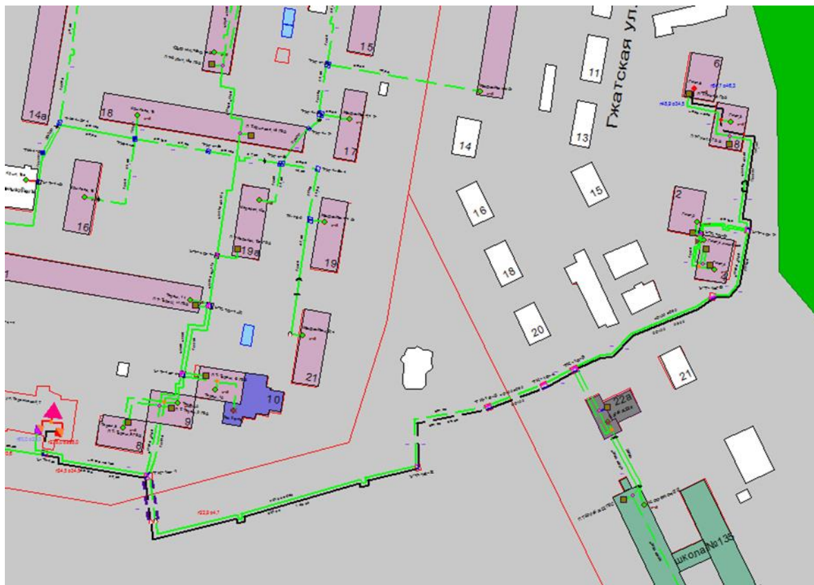
Рисунок 1.229 – Результат гидравлического расчета - расчетный путь теплоносителя от котельной Терешковой, 7
