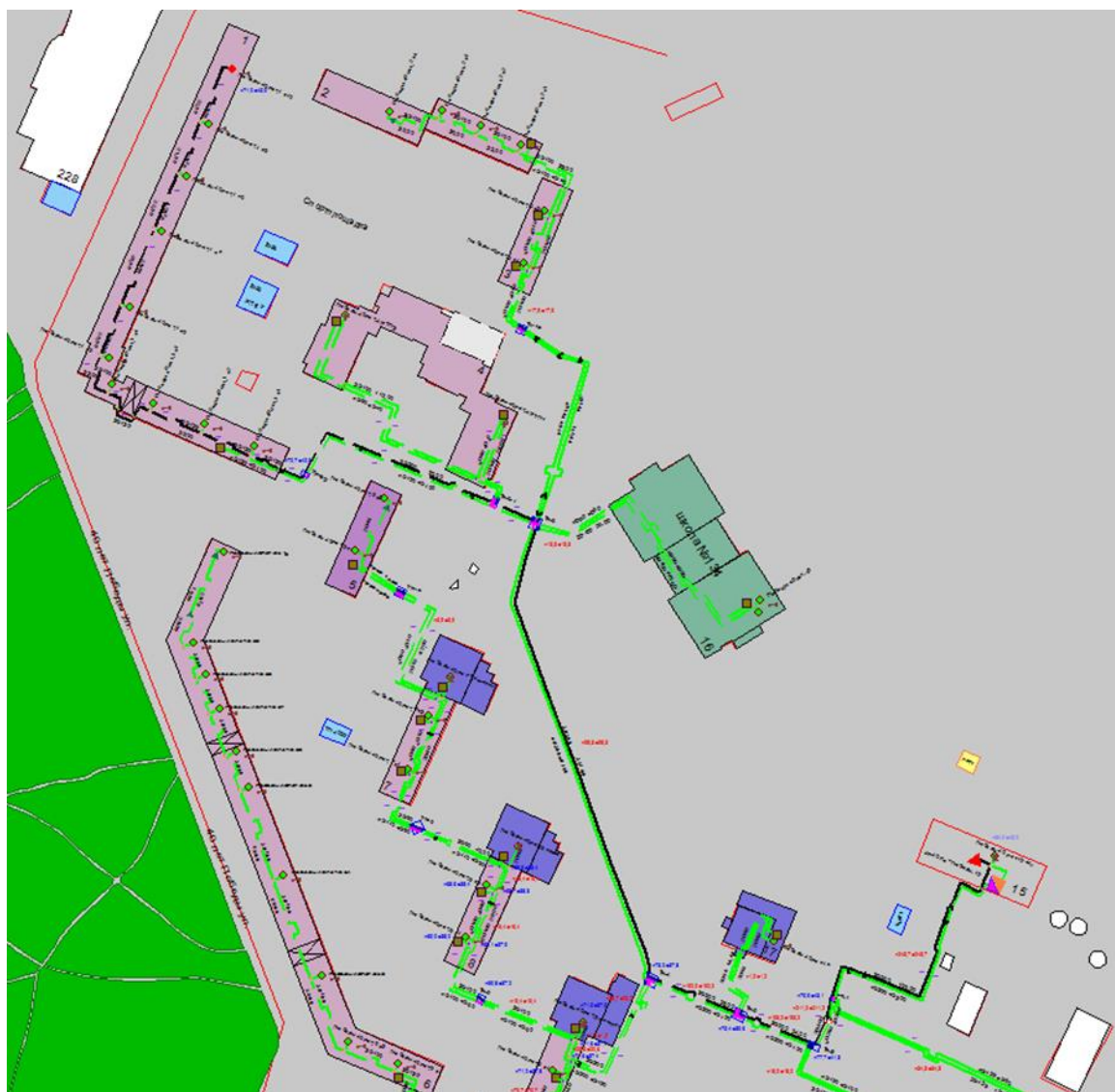
Рисунок 1.165– Результат гидравлического расчета - расчетный путь теплоносителя от котельной 40 лет Победы, 15 до ПТ-Победа 40лет,1 э10
