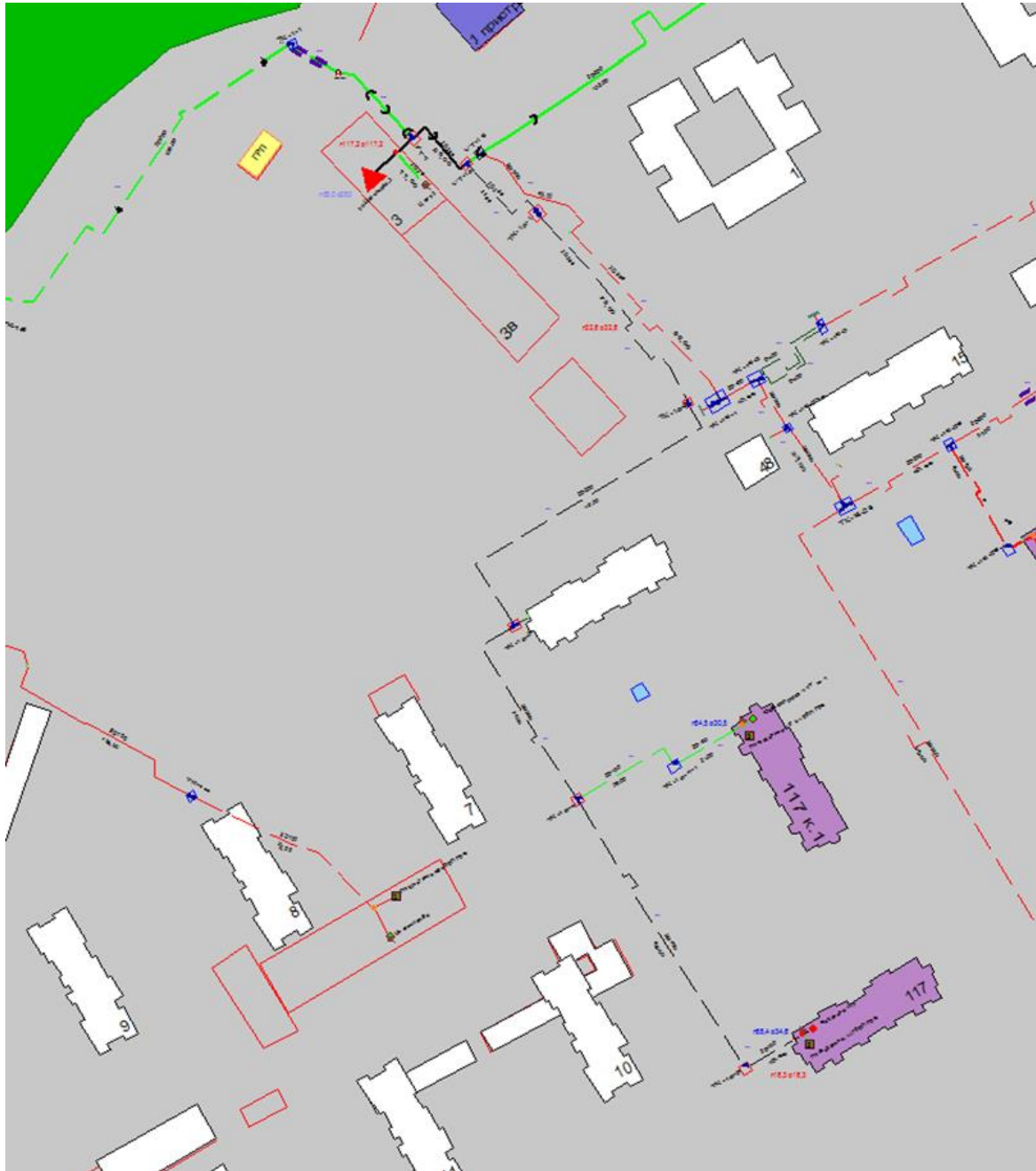
Рисунок 1.171 – Результат гидравлического расчета - расчетный путь теплоносителя от котельной Цветочная, 3-а до ПТ-Сахарова,117
