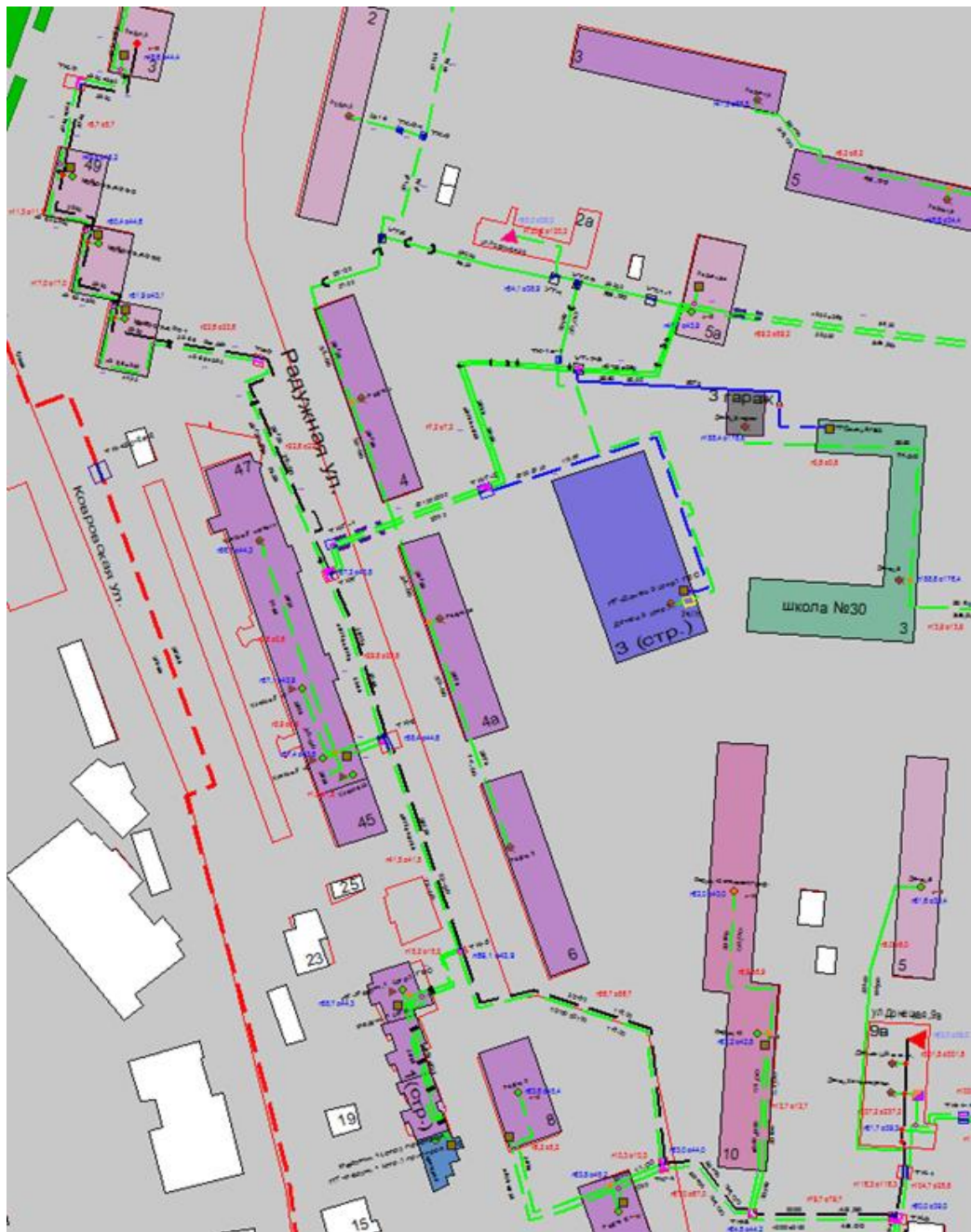
Рисунок 1.239 – Результат гидравлического расчета - расчетный путь теплоносителя от котельной Донецкая, 9в до ПТ-Радуж,3
