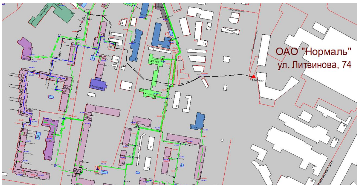
Рисунок 1.193 – Результат гидравлического расчета - расчетный путь теплоносителя от котельной Литвинова, 74 до ПТ-Октяб.рев,42 ввб
