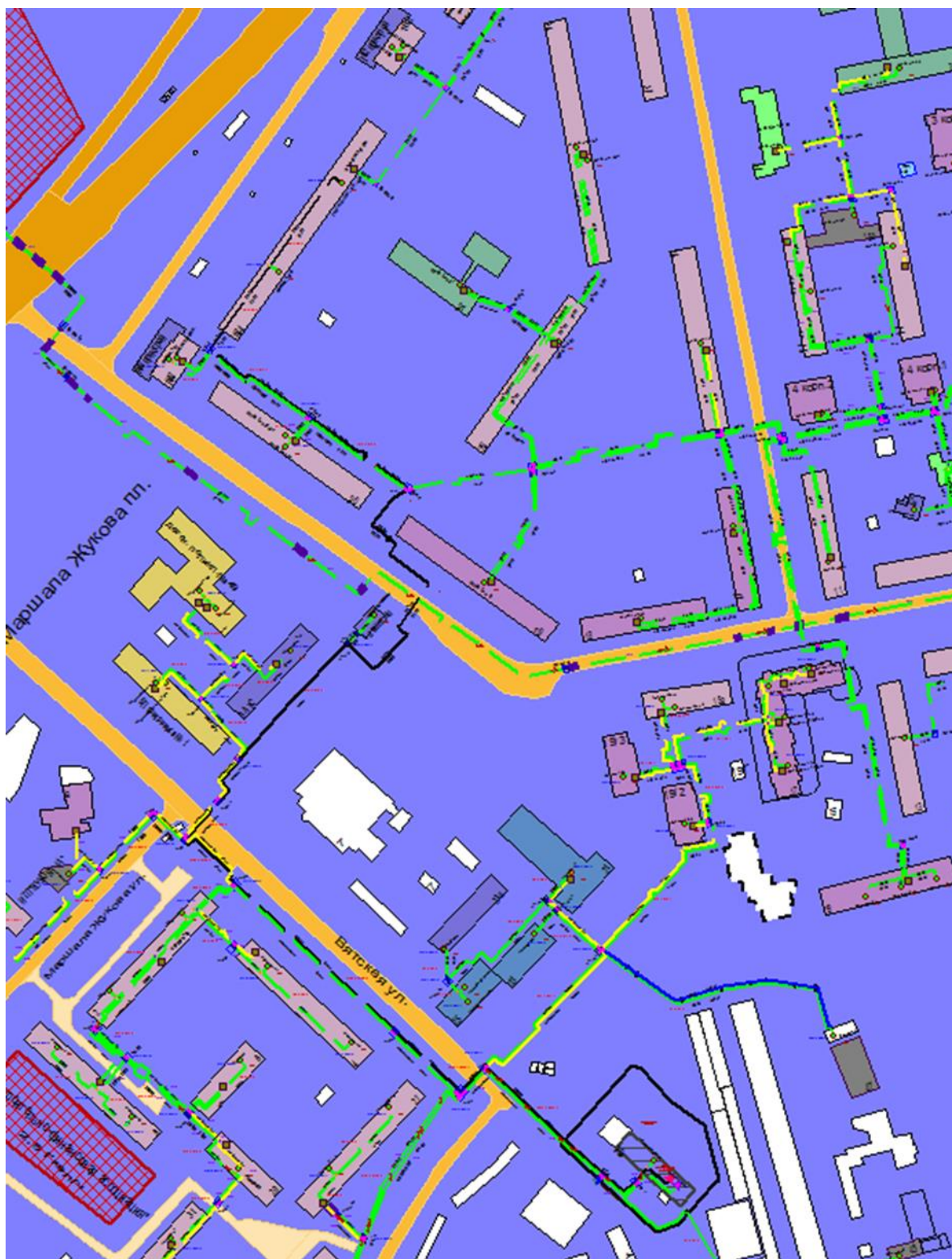
Рисунок 1.157 – Результат гидравлического расчета - расчетный путь теплоносителя от котельной ул. Голованова, 25-а до ПТ-Гагар.пр,184 э2
