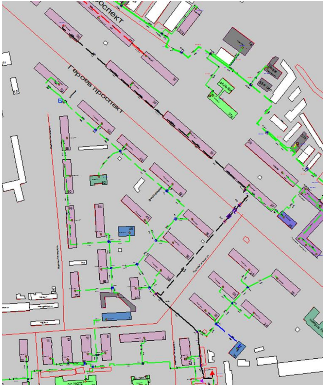
Рисунок 1.143– Результат гидравлического расчета - расчетный путь теплоносителя от котельной Гастелло, 1-а до ПТ-Героев пр,39
