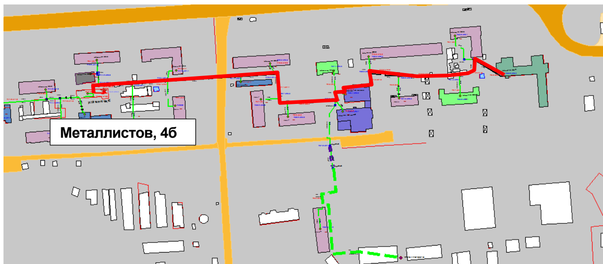
Рисунок 1.141 – Результат гидравлического расчета - расчетный путь теплоносителя от котельной Металлистов, 4б до ПТ-Моск.ш,248
