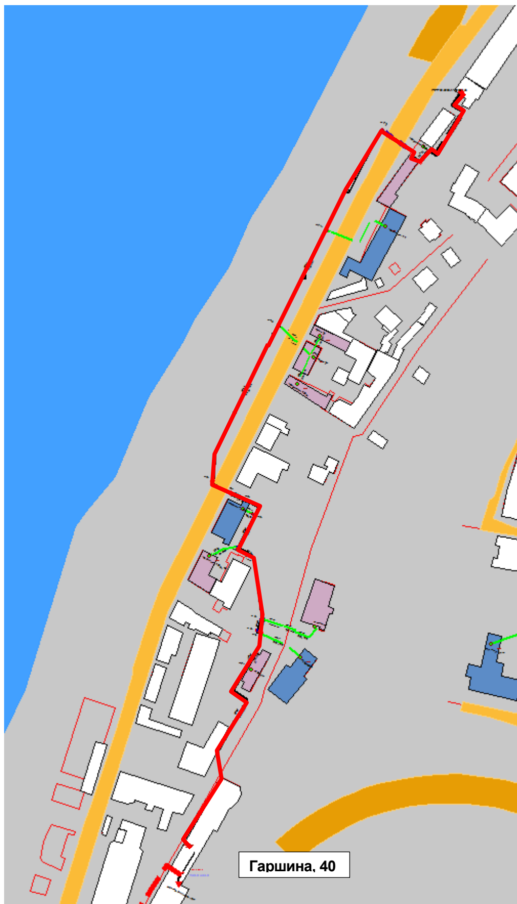
Рисунок Ошибка! Текст указанного стиля в документе отсутствует..159 – Результат гидравлического расчета - расчетный путь теплоносителя
