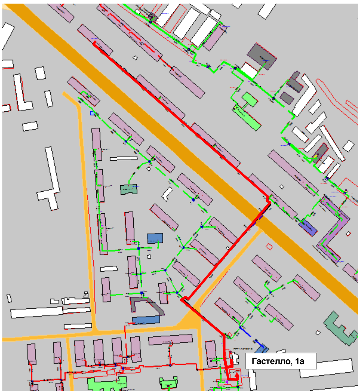
Рисунок Ошибка! Текст указанного стиля в документе отсутствует.153 – Результат гидравлического расчета - расчетный путь теплоносителя от котельной Гаселло, 1а до ПТ-Героев пр,39
