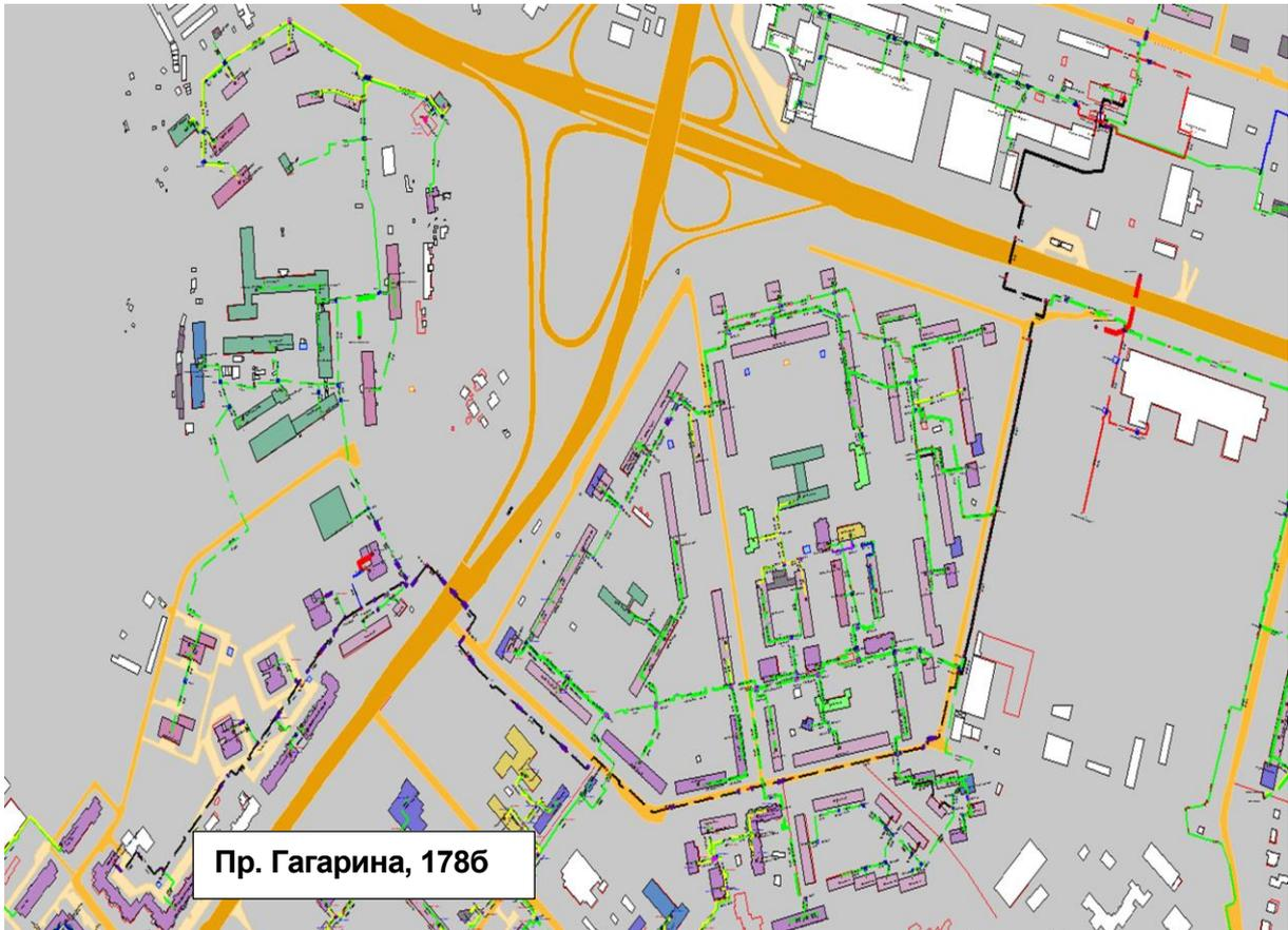
Рисунок 2.69 – Результат гидравлического расчета - расчетный путь теплоносителя от котельной пр. Гагарина, 1786 до ПТ-Гагар.пр.101/5 ИТП №2.
