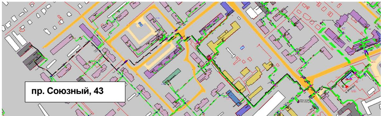
Рисунок 2.75 – Результат гидравлического расчета - расчетный путь теплоносителя от котельной пр. Союзный, 43 до ПТ-Комин, 256 э2
