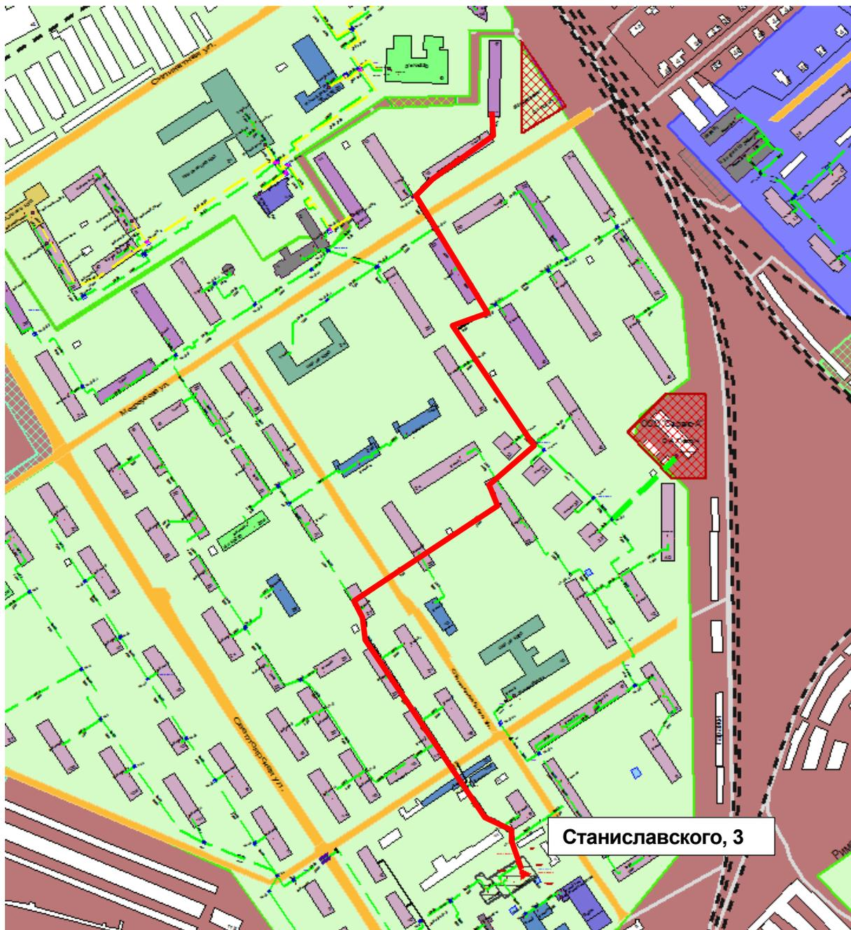
Рисунок 2.49 – Результат гидравлического расчета - расчетный путь теплоносителя от котельной Станиславского, 3 до ПТ-Мокр,17
