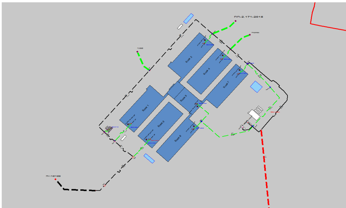
Рисунок 1.55 – Результат гидравлического расчета - расчетный путь теплоносителя от котельной "Сбербанк" БМК №1. до ПТ-ПП-1.17-2017-2022
