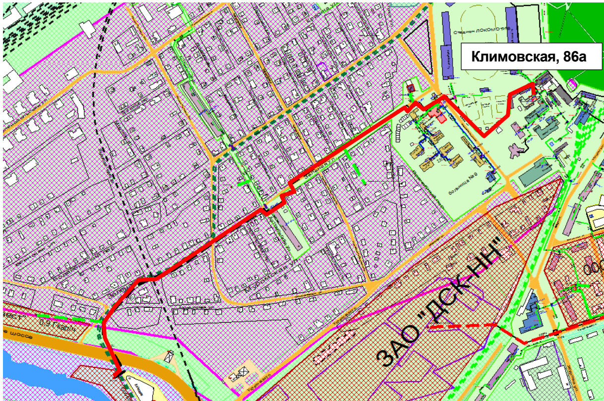
Рисунок 1.31 – Результат гидравлического расчета - расчетный путь теплоносителя от котельной Климовская, 86а до ПТ-ПП-2.227-2016
