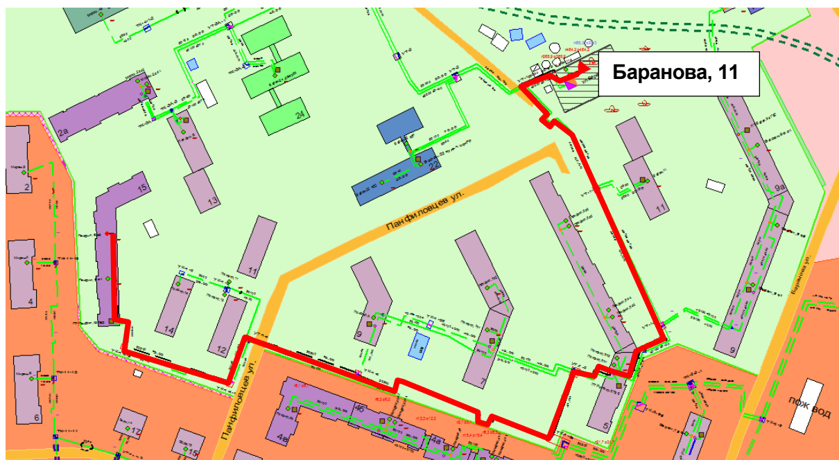
Рисунок 1.27 – Результат гидравлического расчета - расчетный путь теплоносителя от котельной Баранова, 11 до ПТ-Панфил,15 э2
