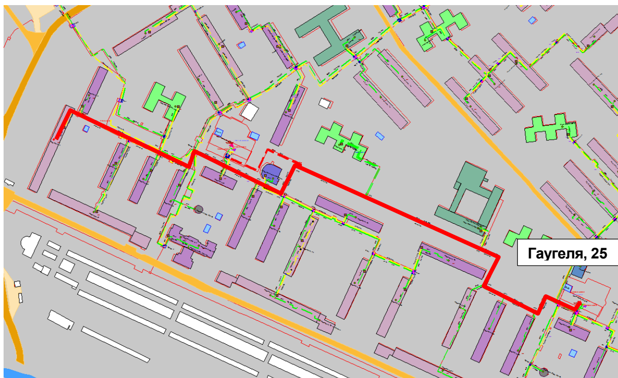
Рисунок 1.77 – Результат гидравлического расчета - расчетный путь теплоносителя от котельной ул. Гаугеля, 25 до
