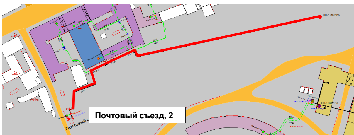
Рисунок 1.95 – Результат гидравлического расчета - расчетный путь теплоносителя от котельной Почтовый съезд, 2, 24 до ПТ-ПП-2.216-2015
