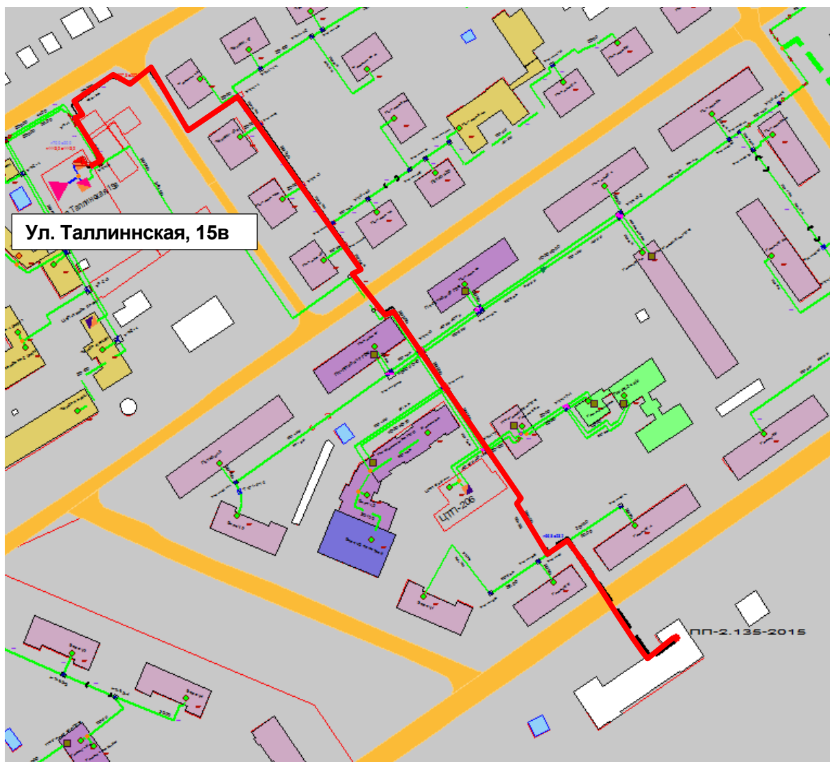
Рисунок 1.123 – Результат гидравлического расчета - расчетный путь теплоносителя от котельной Таллиннская, 15в до ОТВ-009920
