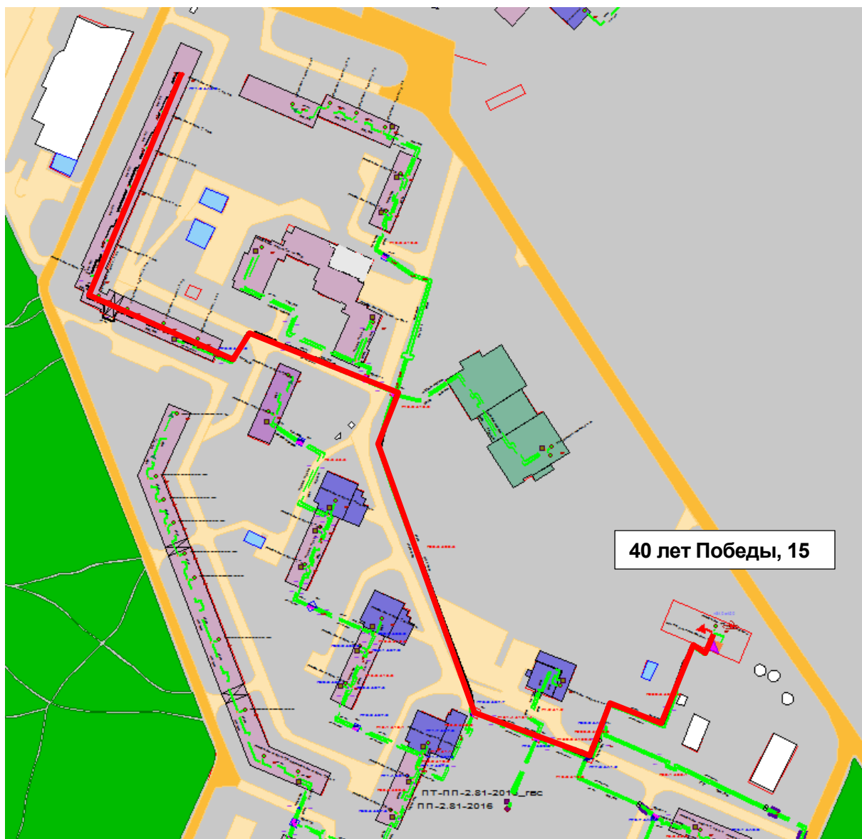
Рисунок Ошибка! Текст указанного стиля в документе отсутствует..201 – Результат гидравлического расчета - расчетный путь теплоносителя от котельной 40 лет Победы, д.15 до ПТ-Победы 40лет,1 з/10
