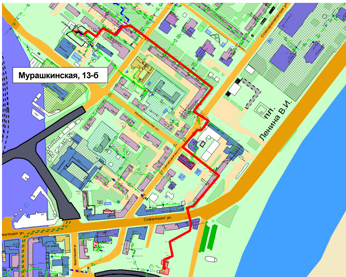
Рисунок Ошибка! Текст указанного стиля в документе отсутствует..153 – Результат гидравлического расчета - расчетный путь теплоносителя от котельной Мурашкинская, 13-б до ЦТП-Интернацион,8
