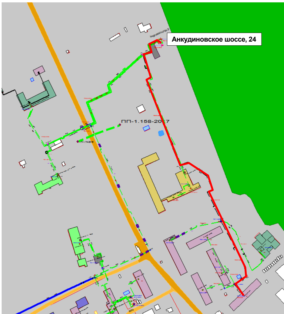
Рисунок Ошибка! Текст указанного стиля в документе отсутствует..191 – Результат гидравлического расчета - расчетный путь теплоносителя от котельной Анкудиновское шоссе, 24 до ПТ-Анкуд.ш,30
