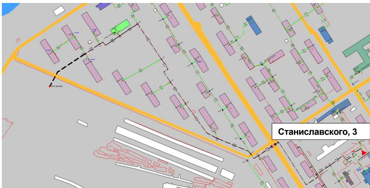
Рисунок 2.47 – Результат гидравлического расчета - расчетный путь теплоносителя от котельной Станиславского, 3 до ПТ-ПП-1,91-2019-2020
