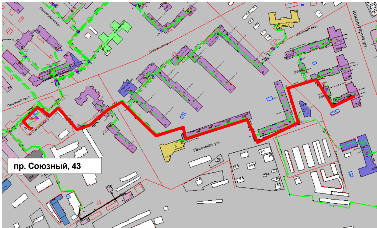
Рисунок Ошибка! Текст указанного стиля в документе отсутствует. 49 - Результат гидравлического расчета - расчетный путь теплоносителя от котельной пр . Союзный, 43 до ПТ-Комин,256 э2
