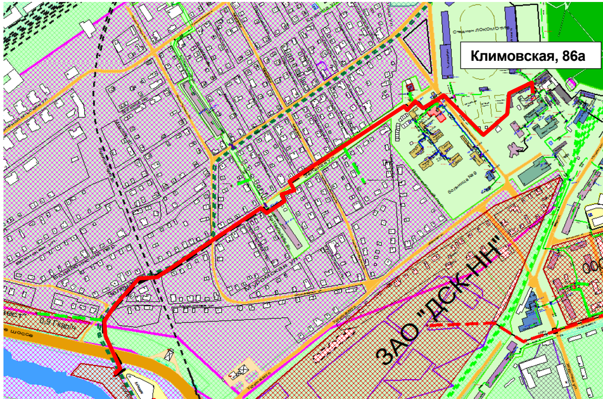
Рисунок Ошибка! Текст указанного стиля в документе отсутствует..31 – Результат гидравлического расчета - расчетный путь теплоносителя от котельной Климовская, 86а до ПТ-ПП-2.227-2016
